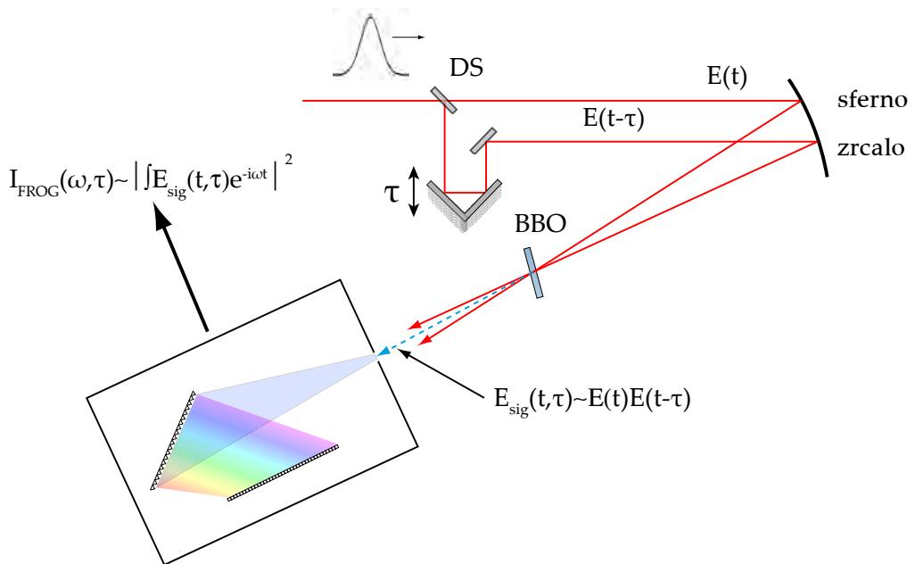
**Slika 4.2:** Shema mjerjenja FROG tehnikom sa frekventnim udvostručavanjem.  $DS$  je djeljitelj snopa, pomične linearne sanjke služe za vremensko razdvajanje pulseva ( $\tau$ ) a BBO je nelinearni kristal za frekventno udvostručavanje.
