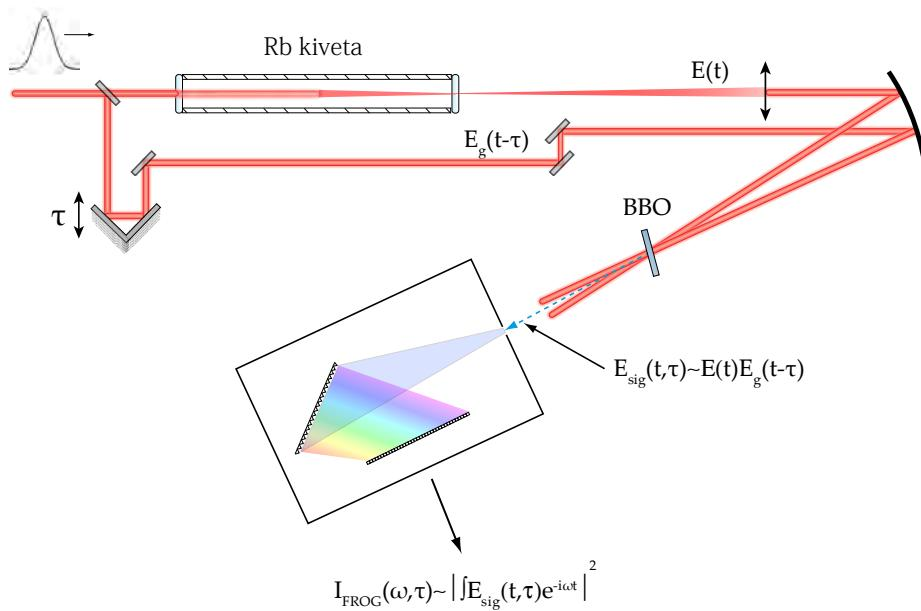
Slika 4.28: Shema eksperimentalnog postava kod XFROG mjerena.
