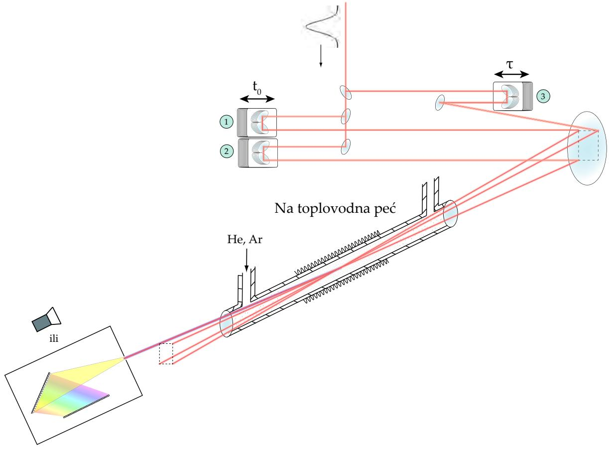
**Slika 5.2:** Eksperimentalna shema četverovalnog miješanja u gustim parama natrija. Fazno ugađanje ostvareno je korištenjem BOXCARS geometrije preklapanja zraka. Detekcija je vršena pomoću spektrometra, fotodiode ili fotomultiplikatora.
