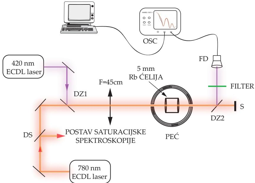
**Slika 3.6:** Eksperimentalni postav za mjerjenje elektromagnetski inducirane transparentcije. DZ1 i DZ2 su dikroička zrcala, DS je djeljitelj snopa a FD je fotodioda.
