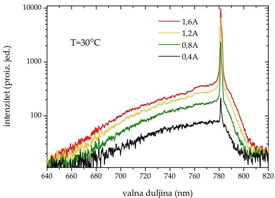
**Slika 3.17:** Spektar optičkog poluvodičkog pojačala za različite jakosti struja kroz poluvodič. Ulažni signal u pojačalo dolazi iz diodnog lasera valne duljine 780 nm i spektralne širine  $< 1$  MHz. Snaga lasera je oko 4.4 mW.
