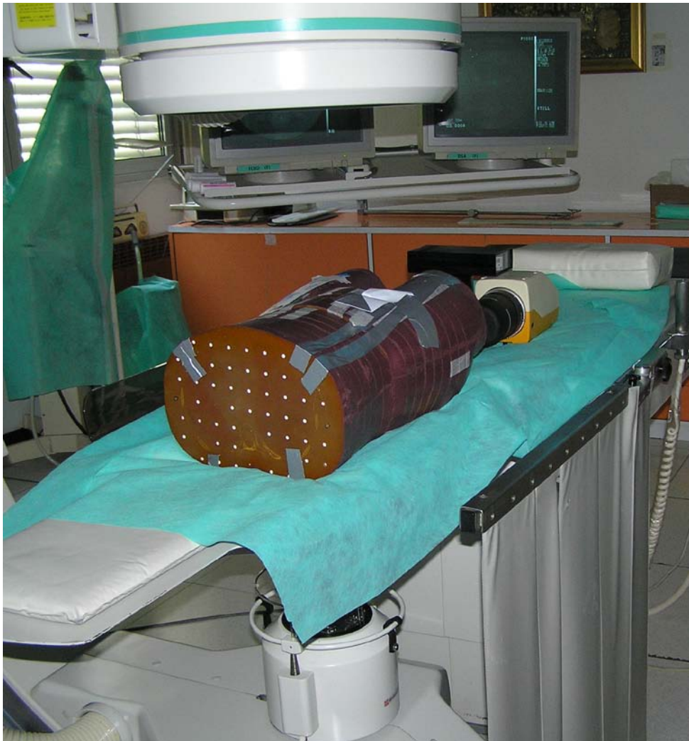
Slika 3.11. Rando Alderson fantom trupa koji je korišten kao izvor raspršenja (pacijent)
