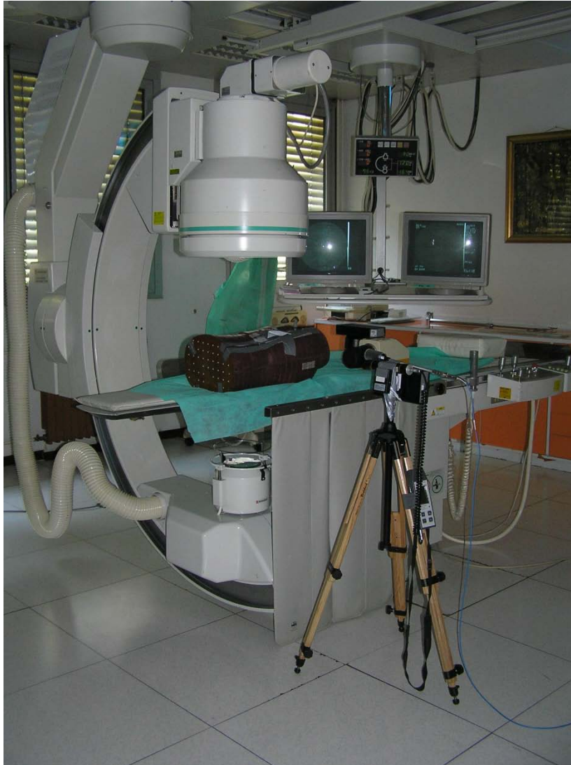
Slika 5. Sustav za fluoroskopiju. Na stolu za pacijenta nalazi se fantom, a monitori za gledanje fluoroskopskih snimaka nalaze se na desnoj strani slike. C-luk je pričvršćen na strop te se može rotirati oko osi pacijenta omogućavajući tako snimanje iz željenog kuta. U položaju na fotografiji rendgenska cijev se nalazi ispod stola za pacijenta (PA).
