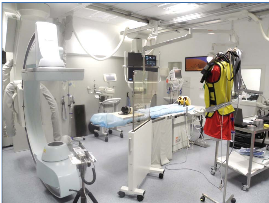
Slika 5.4. Plastični realistični fantom – maneken opremljen mjernim instrumentima, na položaju liječnika (operatera) koji izvodi intervencijski postupak. Realni postav medicinske opreme unutar IR dvorane. Prikaz rendgenskog uređaja, zaštitnih paravana, aluminijskog fantoma i mjerne opreme prilikom mjerenja ponašanja primarnog snopa i raspršenog rendgenskog zračenja.
