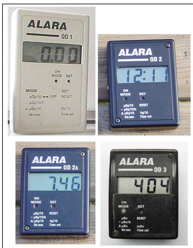
Slika 8.1. Paleta do sada osmišljenih i proizvedenih tipova AED ALARA OD x: ALARA OD 1G, ALARA OD 2, ALARA OD 2A i ALARA OD 3. Izvor: Prlić, I. i ALARA d.o.o., Zagreb.
