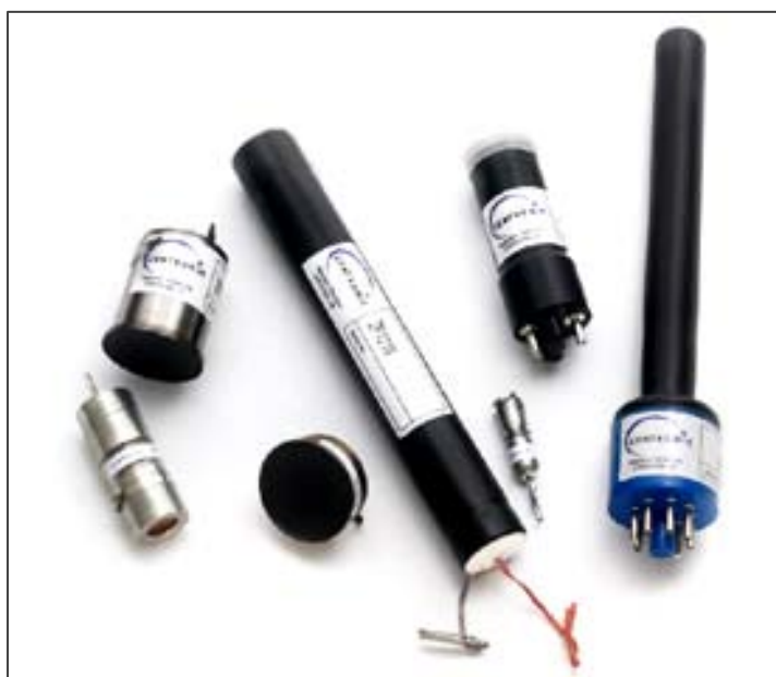
Slika 7.1. Paleta GM cijevi koje se koriste u AED ALARA OD x (proizvođač: Centronic Ltd. UK).
