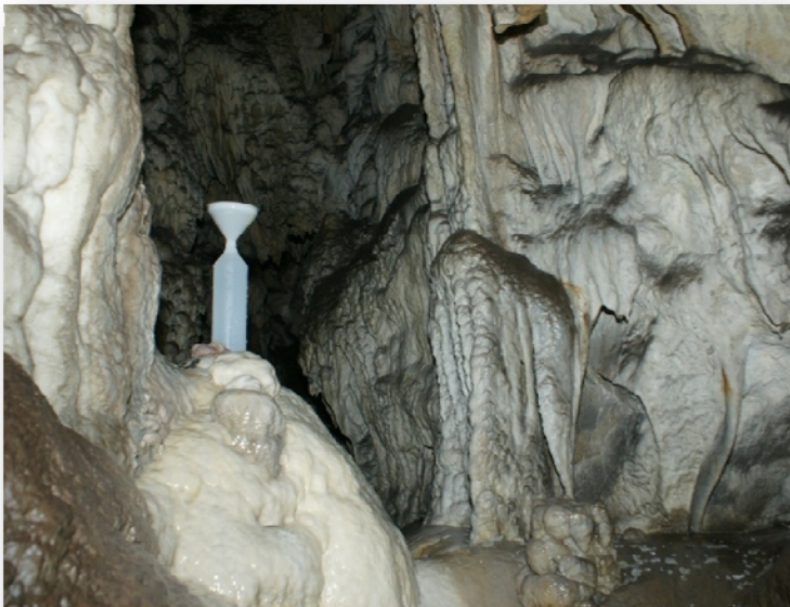
Figure B.12 Sampling location is isolated from direct air flow current Slika B.12 Mjesto uzorkovanja je zaklonjeno od strujanja zraka
