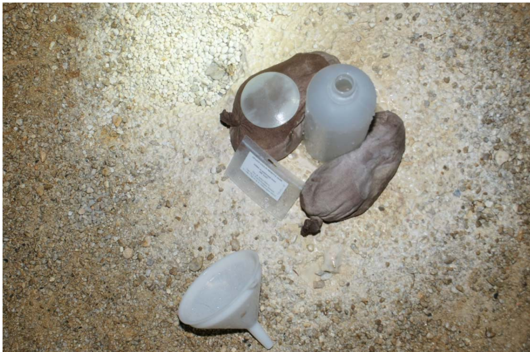
Figure 5.12 A watch glass plate on a sampling site. Slika 5.12. Satno stakalce postavljeno na mjestu uzorkovanja.
