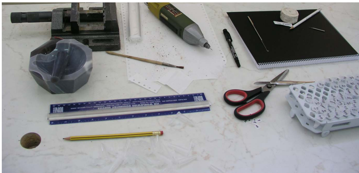
Figure 5.15 Tools for laboratory sub-sampling of carbonate samples. Slika 5.15 Alat i pribor za obradu i pod-uzorkovanje karbonata u laboratoriju.
