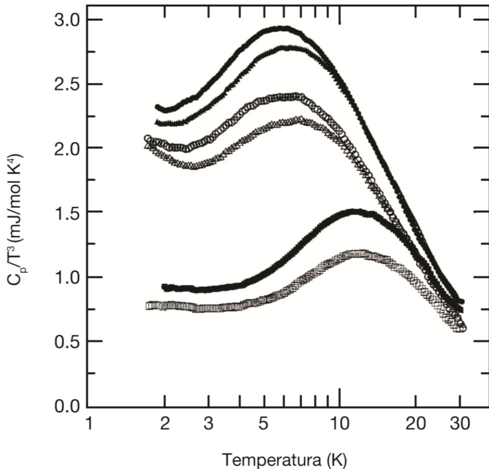
Slika 2.4: Toplinski kapacitet kristala ( $\square$ ), orijentacijskog staklastog stanja ( $\Delta$ ) i staklastog stanja ( $\circ$ ), etanola  $\text{CH}_3\text{CH}_2\text{OH}$  (prazni simboli) i denaturiranog etanola  $\text{CD}_3\text{CD}_2\text{OD}$  (puni simboli). Slika preuzeta iz [61].
