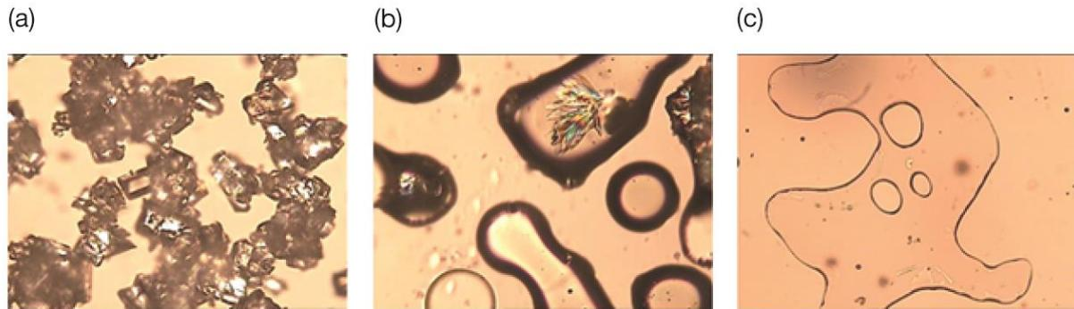
Slika 4.2: Svjetlosnim mikroskopom su proučene promjene polimorfa trehaloze zagrijavanjem od sobne temperature do temperature taljenja iznad 473 K: dihidrat,  $\text{TRE}_h$ , (a), polikristal,  $\text{TRE}_\beta$ , (b) i staklasto stanje,  $\text{TRE}_g$ , (c).
