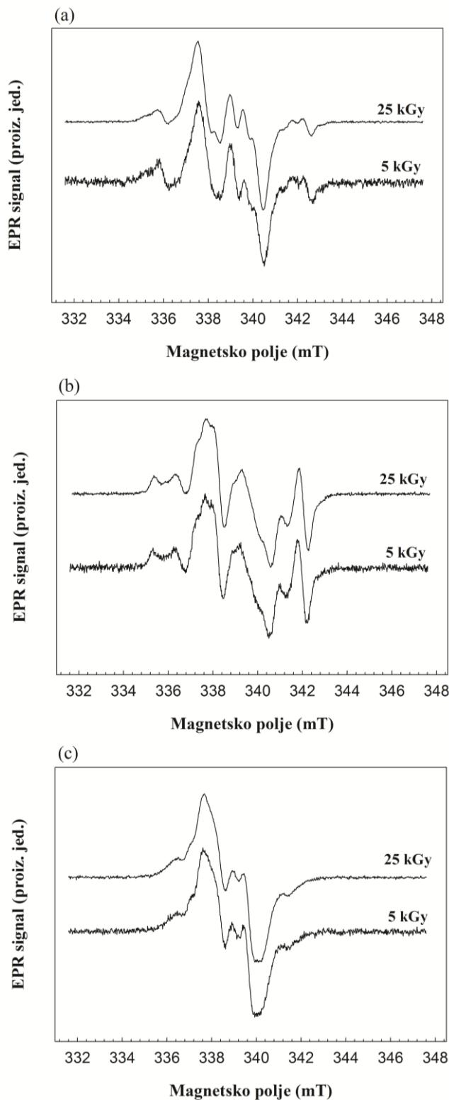
Slika 5.7: CW-EPR spektri na sobnoj temperaturi uzoraka trehaloze  $\text{TRE}_h$  (a),  $\text{TRE}_\beta$  (b) i  $\text{TRE}_g$  (c) ozračenih gama zračenjem, dozom od 5 kGy i 25 kGy nakon čega je uslijedilo izotermno napuštanje na temperaturi od 313 K. Spektri su normirani s obzirom na maksimalni EPR signal.
