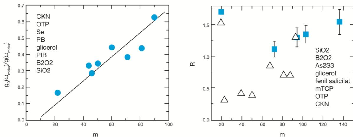
Slika 3.2: Veza između stupnja fragilnosti  $m$  i relativnog intenziteta bozonskog vrha. Na lijevom grafu prikazana je veza između  $m$  i omjera Debyeove gustoće stanja i maksimalne gustoće modova bozonskog vrha,  $g_D(\omega_{\text{maks}})/g(\omega_{\text{maks}})$ , odnosno inverznog intenziteta bozonskog vrha. Desna slika prikazuje vezu između  $m$  i parametra  $R$ . Slike su preuzete iz [116].
