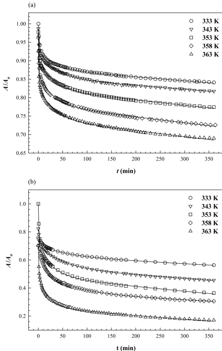
Slika 5.11: Termičko opadanje EPR signala u ovisnosti o vremenu izoternog napuštanja za uzorke trehaloze TRE<sub>β</sub> (a) i TRE<sub>g</sub> (b) ozračene gama zračenjem uz dozu od 10 kGy. Pune linije prikazuju teorijsku simulaciju ovisnosti izračunate prema izrazu (5.5).  $A_0$  je dvostruki integral eksperimentalnog EPR spektra u vremenu  $t = 0$ , odnosno  $A(t = 0)$ .
