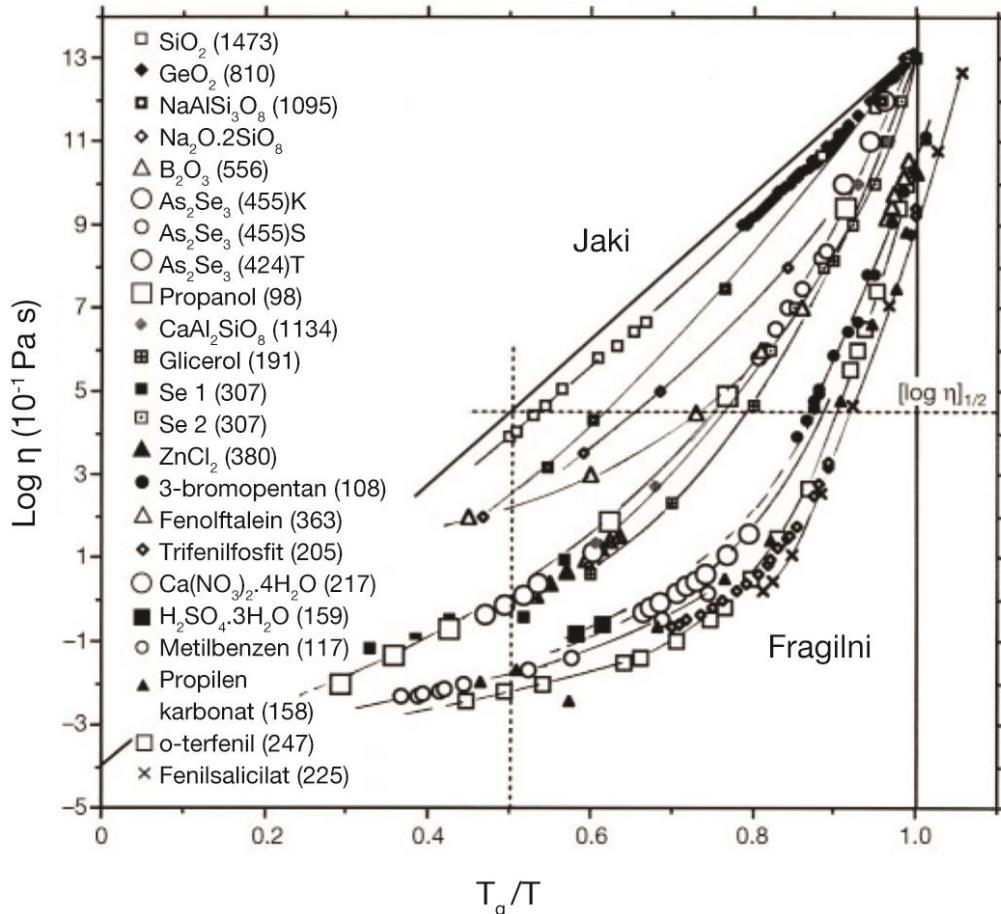
Slika 2.2: Ovisnosti viskoznosti  $\eta$  o inverznoj temperaturi normaliziranoj na temperaturu staklišta,  $T_g/T$ . Arrheniusova temperaturna ovisnost, karakteristična za jake sisteme, prikazana je linearnom ovisnošću, dok fragilni sistemi pokazuju odstupanje od Arrheniusove ovisnosti. Ovakav prikaz je poznat pod nazivom Angellov graf. Slika preuzeta iz [48].
