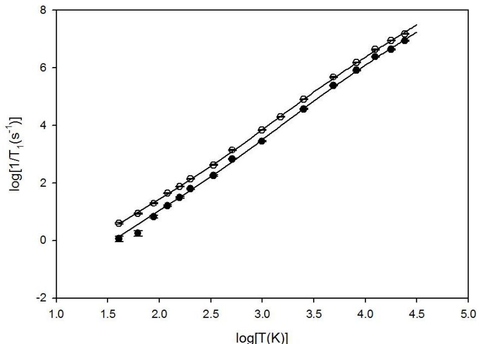
Slika 5.4: Eksperimentalni podaci dobiveni mjeranjem brzine spin-rešetka relaksacijskog vremena elektrona,  $1/T_1^*$ , u ozračenoj trehalozi u kristalnom stanju,  $TRE_\beta$ , (•), i u staklastom stanju,  $TRE_g$ , (o), u temperaturnom intervalu od 5 do 80 K. Pone linije predstavljaju prilagodbu eksperimentalnih podataka (•) i (o) na jednadžbu (5.1). Dobiveni parametri dani su u tablici 5.1.
