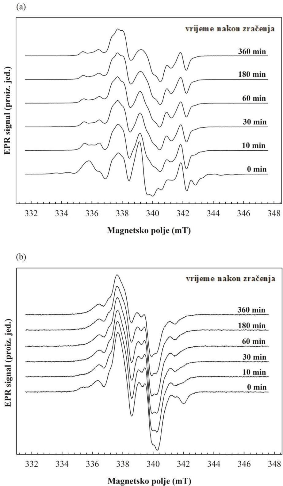
Slika 5.10: EPR spektri u ovisnosti o vremenu izotermnog napuštanja na temperaturi od 333 K za uzoraka  $\text{TRE}_\beta$  (a) i  $\text{TRE}_g$  (b) ozračene gama zračenjem, uz dozu od 10 kGy.
