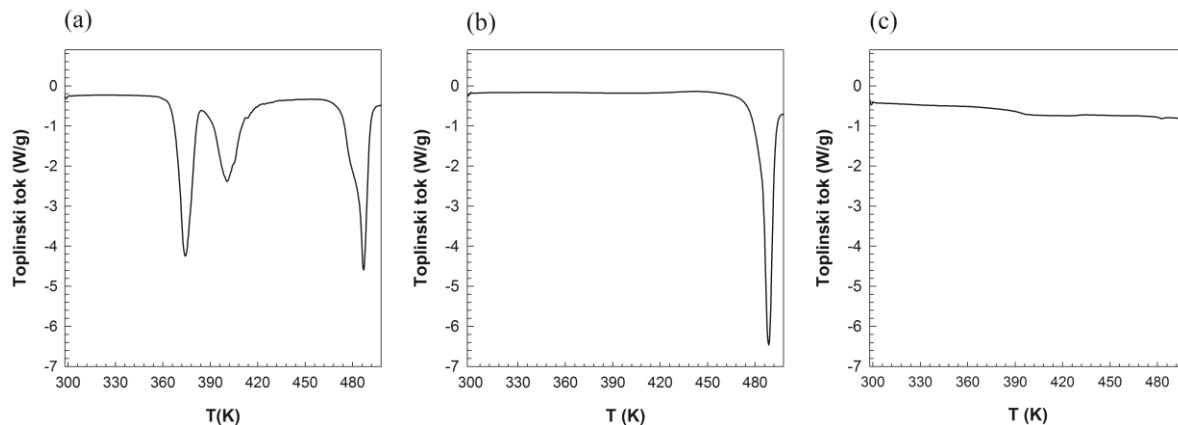
Slika 4.1: DSC krivulje uzoraka trehaloze u stanjima različite uređenosti molekula: dihidrat,  $\text{TRE}_h$ , (a), polikristal,  $\text{TRE}_\beta$ , (b) i staklasto stanje,  $\text{TRE}_g$ , (c), tijekom zagrijavanja brzinom  $20 \text{ K min}^{-1}$ .
