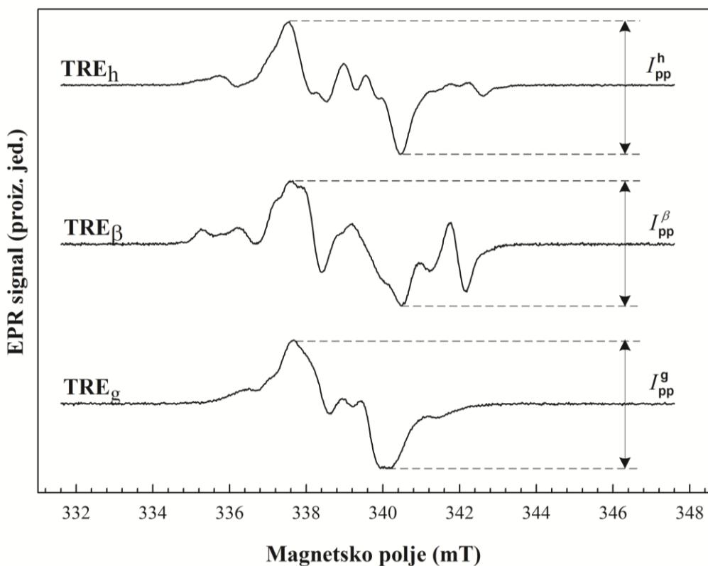
Slika 5.6: CW-EPR spektri na sobnoj temperaturi uzoraka trehaloze ( $\text{TRE}_h$ ,  $\text{TRE}_\beta$  i  $\text{TRE}_g$ ) ozračenih ionizirajućim gama zračenjem dozom od 25 kGy i mjereni nakon tri dana izotermnog napuštanja na 313 K. Intenzitet centralne linije,  $I_{pp}$ , označen je za sve polimorfe trehaloze.
