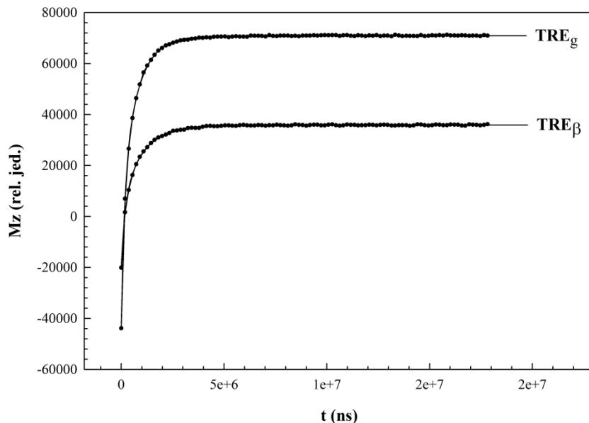
Slika 4.3: Magnetizacijske krivulje na 80 K za uzorke trehaloze u polikristalnom ( $TRE_\beta$ ) i staklastom ( $TRE_g$ ) stanju. Pune linije predstavljaju prilagodbu eksperimentalnih podataka ( $\bullet$ ) na dvoeksponecijalnu funkciju.
