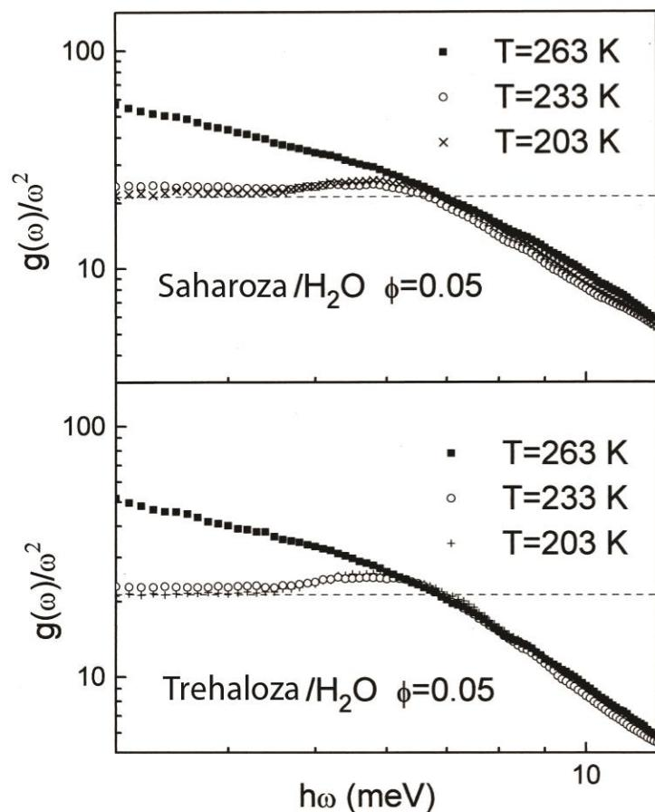
Slika 2.3: Usporedba reducirane gustoće stanja,  $g(\omega)/\omega^2$ , na različitim temperaturama za smjese saharoza/ $H_2O$  i trehaloza/ $H_2O$  s množinskim udjelom  $\Phi = 0,05$ . Crtkana linija označava Debyeovo ponašanje na najnižoj temperaturi ( $T = 203$  K). Slika preuzeta iz [55].
