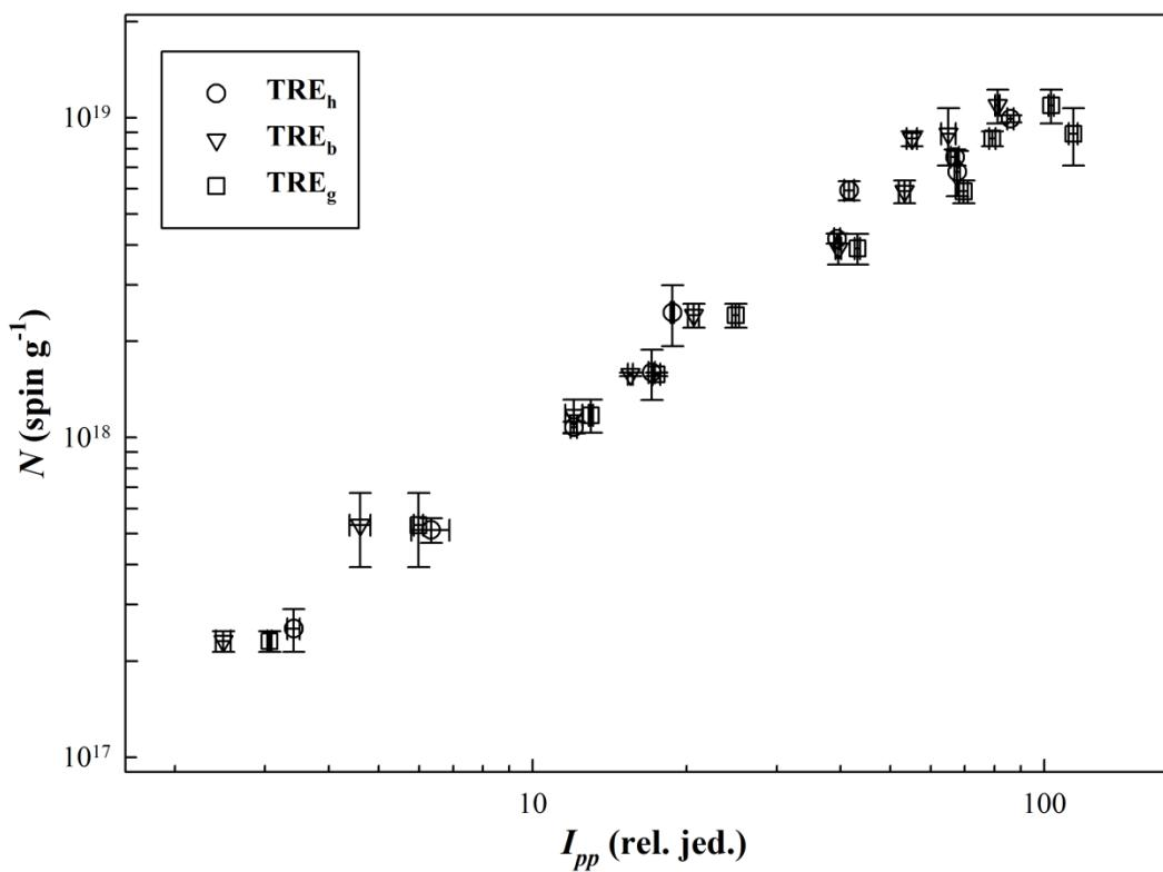
Slika 5.9: Linearna ovisnost parametra  $I_{pp}$ , (definiranog na slici 5.6) i koncentracije paramagnetskih centara,  $N$ , za uzorke trehaloze TRE<sub>h</sub>, TRE <sub>$\beta$</sub>  i TRE<sub>g</sub>.
