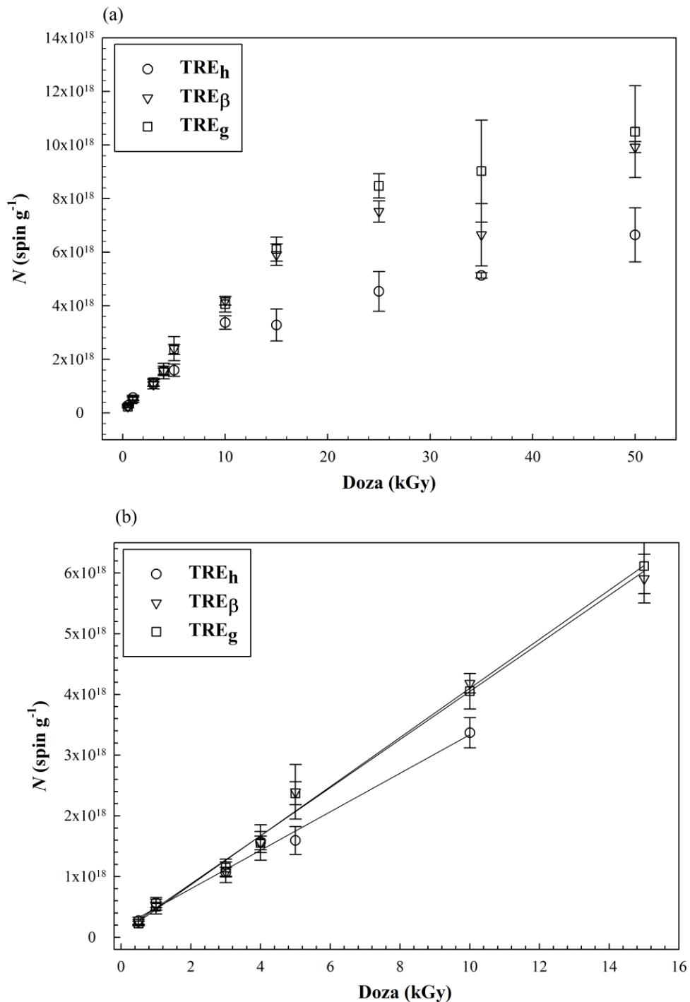
Slika 5.8: (a) Koncentracija induciranih paramagnetskih centara,  $N$ , kao funkcija apsorbirane doze zračenja za uzorke trehaloze  $\text{TRE}_h$ ,  $\text{TRE}_\beta$  i  $\text{TRE}_g$ . (b) Koncentracija paramagnetskih centara kao funkcija doze zračenja za uzorke  $\text{TRE}_h$ ,  $\text{TRE}_\beta$  i  $\text{TRE}_g$  u području linearnosti doze. Pune linije predstavljaju modeliranje koncentracija induciranih paramagnetskih centara linearnom regresijom s obzirom na primijenjenu dozu.
