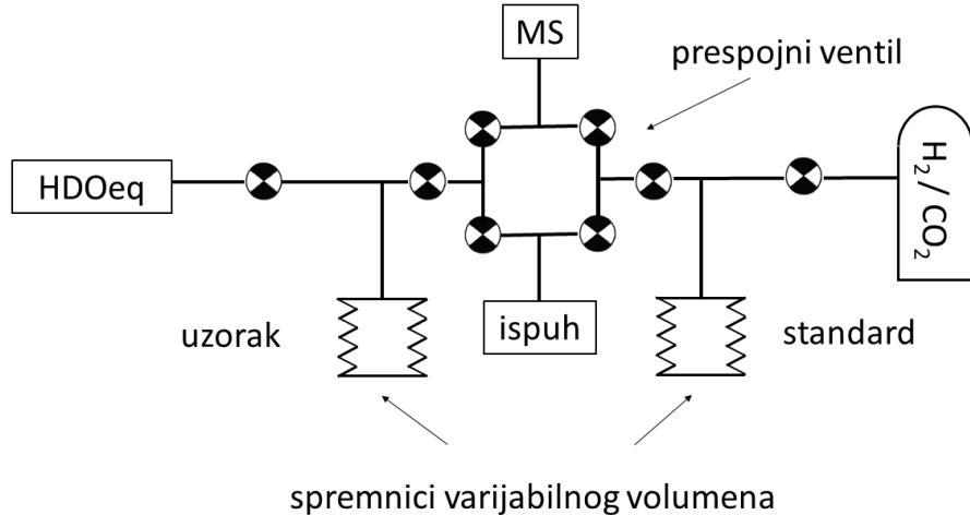
Slika 3.1.3. Shematski prikaz jedinice dvostrukog ulaza.
