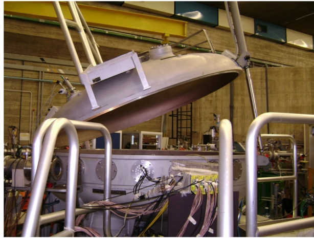
Slika 4.1: Komora za mjerenje nuklearnih reakcija CT2000.
