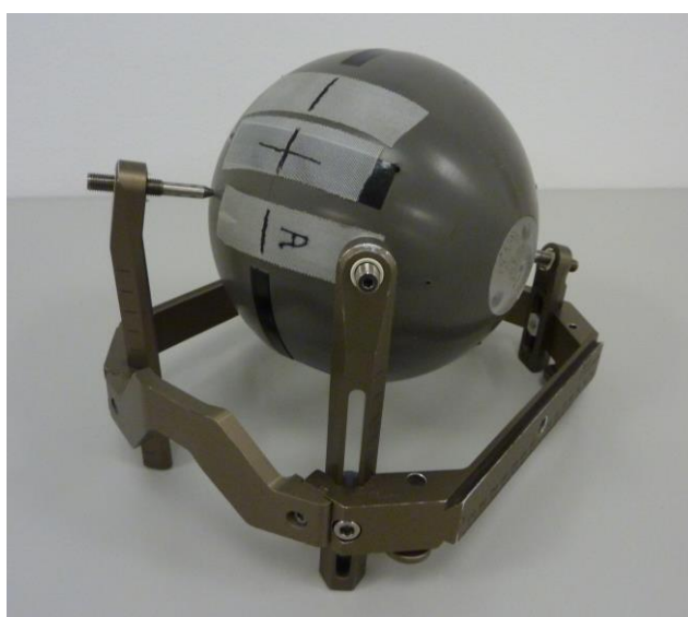
Slika 2.19 Akrilonitrilbutadiinstirenski fantom - ABS (Elekta AB, Stockholm, Švedska) učvršćen u Leksellov stereotaktički okvir.
