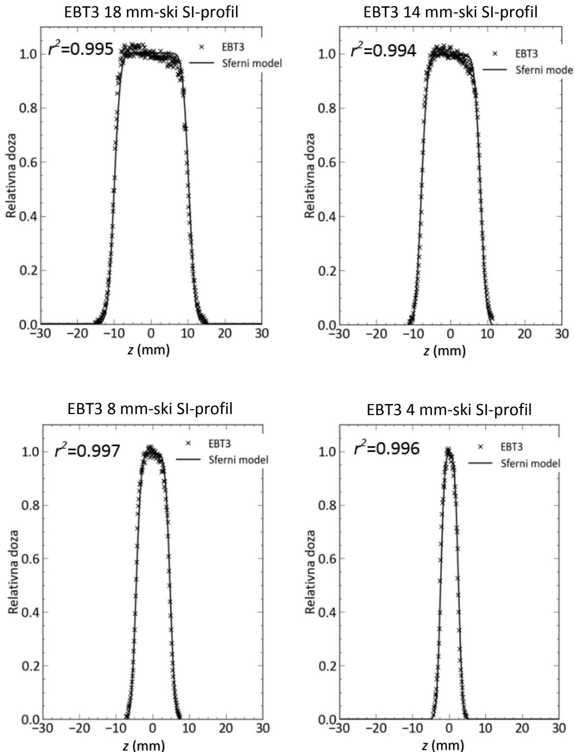
Slika 3.20 Prilagodba analitičke funkcije sfernog modela SI-profilima mjerenim radiokromskim filmovima EBT3. Razlučivost skeniranja filmova bila je 200 dpi, odnosno 0.127 mm.
