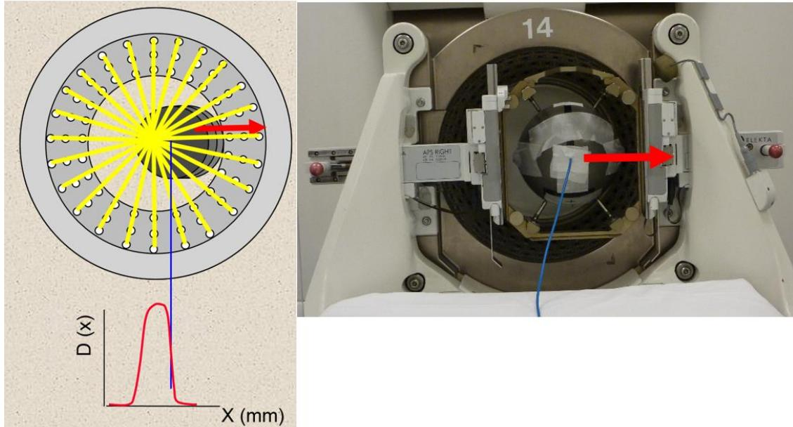
Slika 2.21 Mjerjenje LL-profila doze pomicanjem APS-om cijelog fantoma s detektorom u koracima od 0.2 mm.
