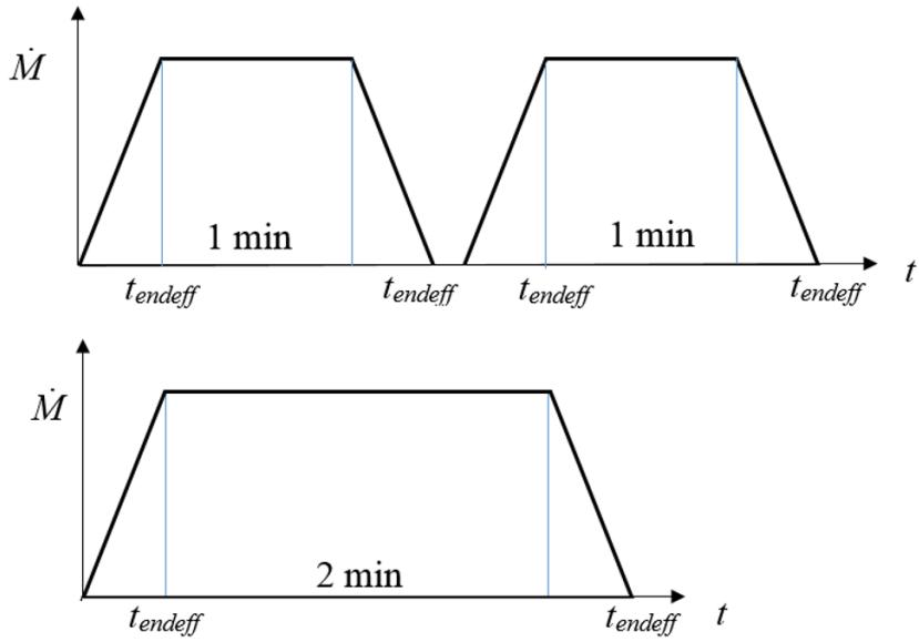
Slika 2.31 Grafički prikaz tehnike mjerjenja dva signalna  $M_{2\text{min}}$  i  $M_{1+1\text{min}}$  za određivanje end effect vremena  $t_{endeff}$ .
