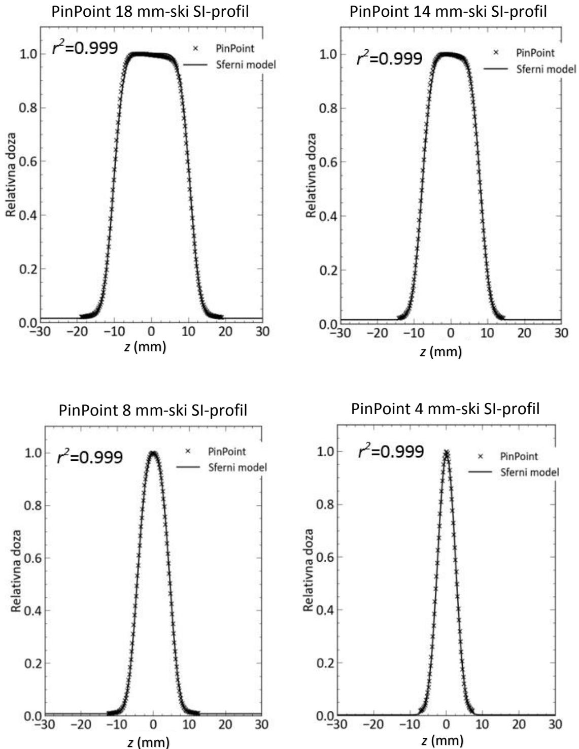
Slika 3.14 Prilagodba analitičke funkcije sfernog modela SI-profilima mjerenim PinPoint ionizacijskom komorom.
