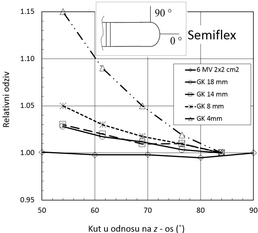
Slika 3.28 Relativni odziv, odnosno kutna ovisnost odziva ionizacijske komore Semiflex mjerena indirektno u fotonskim snopovima gama noža i 6 MV snopovima linearog akceleratora veličine  $2 \times 2 \text{ cm}^2$ . Odziv detektora je normiran na odziv izmјeren pod kutem od  $84^\circ$  u odnosu na z-os gama noža, odnosno  $90^\circ$  za linearni akcelerator, u odnosu na središnju os detektora.
