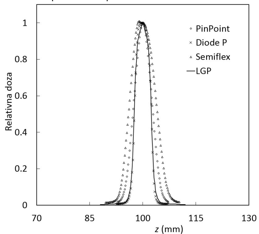
Slika 3.6 Usporedba SI-profila doze za 8 i 4 mm-ski kolimator mjerjenih ionizacijskim komorama PinPoint i Semiflex te poluvodičkim detektorom Diode P s računalno simuliranim LL-profilima. Primjetan je izraženi volumni učinak usrednjavanja za profile mjerene ionizacijskim komorama
