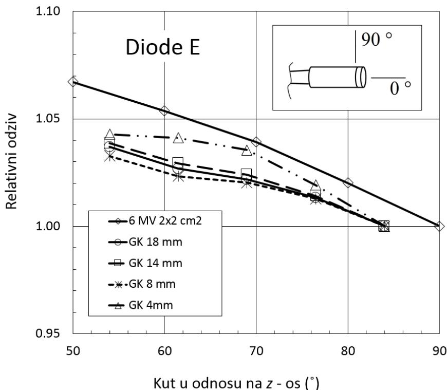
Slika 3.26 Relativni odziv, odnosno kutna ovisnost odziva neoklopljenog poluvodičkog detektora Diode E mjerena indirektno u fotonskim snopovima gama noža i 6 MV snopovima linearног akceleratora veličine  $2 \times 2 \text{ cm}^2$ . Odziv detektora je normiran na odziv izmјeren pod kutem od  $84^\circ$  u odnosu na  $z$ -os gama noža, odnosno  $90^\circ$  za linearni akcelerator, u odnosu na središnju os detektora.
