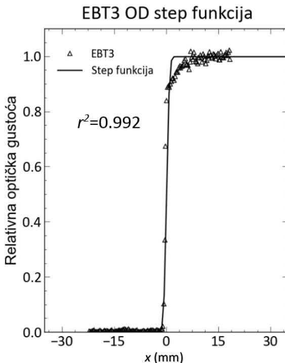
Slika 3.12 Prilagodba analitičke step-funkcije simuliranom skokovitom prijelazu optičke gustoće radiokromskog filma EBT3 ( $\Delta OD = 1.3$ ). Derivacija analitičke step-funkcije predstavlja konvolucijsku jezgru sustava radiokromski film-skener.
