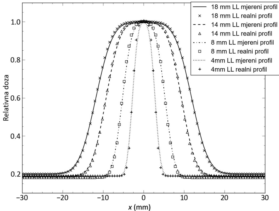
Slika 3.23 Usporedba LL-profila doze mjerjenih filmovima EBT3 i realnih LL-profila određenih analitičkom dekonvolucijom prostornog utjecaja konvolucijske jezgre sustava radiokromski film-skener. LL-profilni mjereni filmom pokazuju minimalno širenje polusjene.
