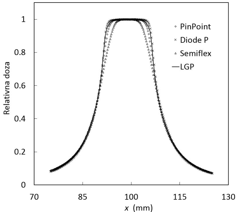
Slika 3.3 Usporedba LL-profila doze za 18 i 14 mm-ski kolimator mjereni ionizacijskim komorama PinPoint i Semiflex te poluvodičkim detektorom Diode P s računalno simuliranim LL-profilima (LGP).
