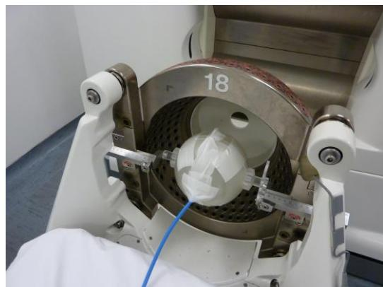
Slika 2.27 PMMA fantom s ionizacijskom komorom namješten u izocentar Leksellovog gama noža pomoću metalnih zaglavnika.
