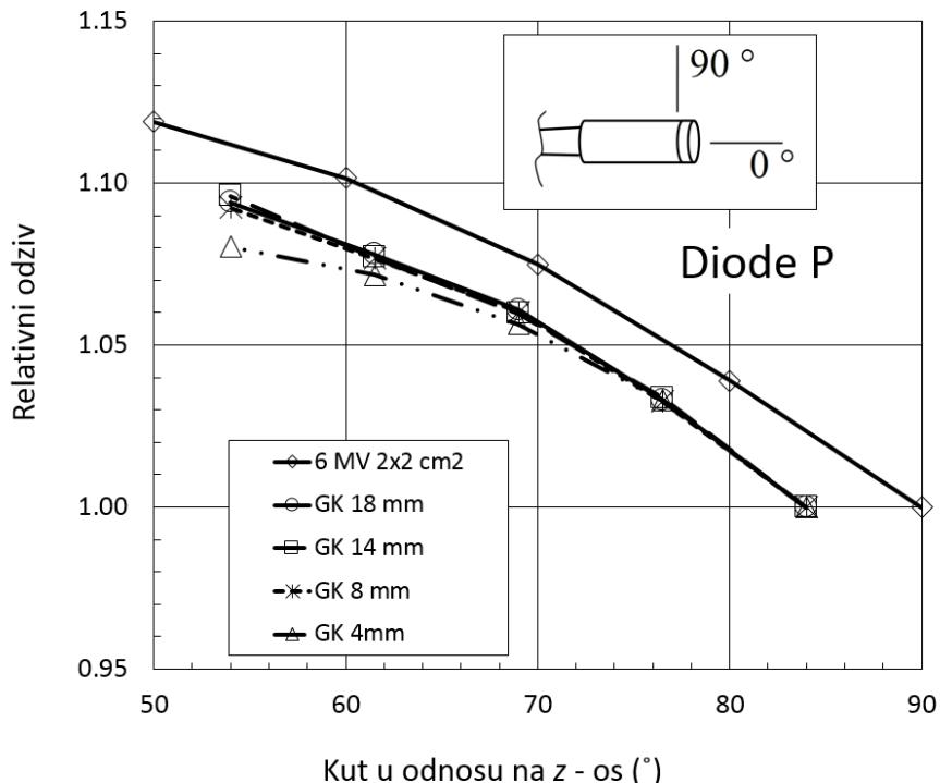
Slika 3.25 Relativni odziv, odnosno kutna ovisnost odziva oklopljenog poluvodičkog detektora Diode P mjerena indirektno u fotonskim snopovima gama noža i 6 MV snopovima linearne akceleratora veličine  $2 \times 2 \text{ cm}^2$ . Odziv detektora je normiran na odziv izmјeren pod kutem od  $84^\circ$  u odnosu na  $z$ -os gama noža, odnosno  $90^\circ$  za linearni akcelerator, u odnosu na središnju os detektora.
