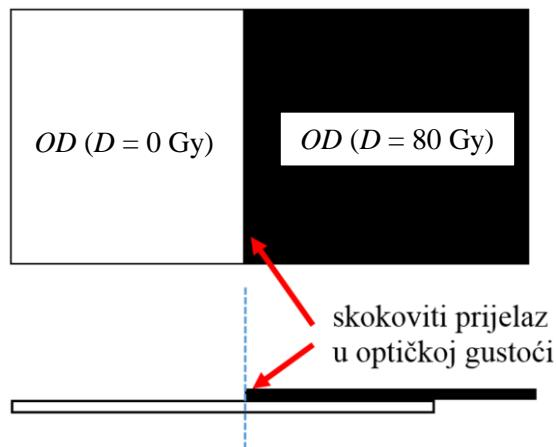
Slika 2.33 Shematski prikaz simulacije step-funkcije optičke gustoće filma EBT3, odnosno skokovitog prijelaza iz neozračenog filma EBT3 optičke gustoće  $OD(D=0 \text{ Gy})$  u jednoliko ozračeni filma optičke gustoće  $OD(D=8 \text{ Gy})$ .
