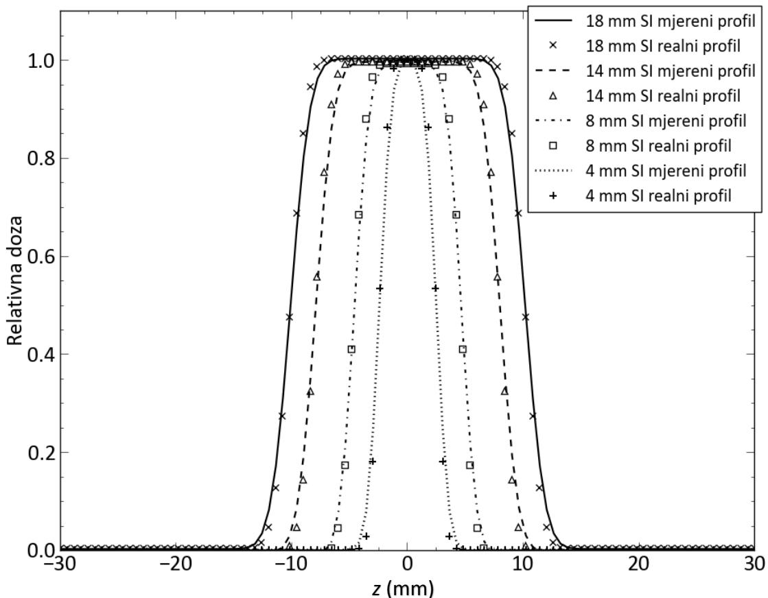
Slika 3.24 Usporedba SI-profila doze mjereneih filmovima EBT3 i realnih SI-profila određenih analitičkom dekonvolucijom prostornog utjecaja konvolucijske jezgre sustava radiokromski film-skener. Također i SI-profilni pokazuju minimalni učinak volumnog usrednjavanja.
