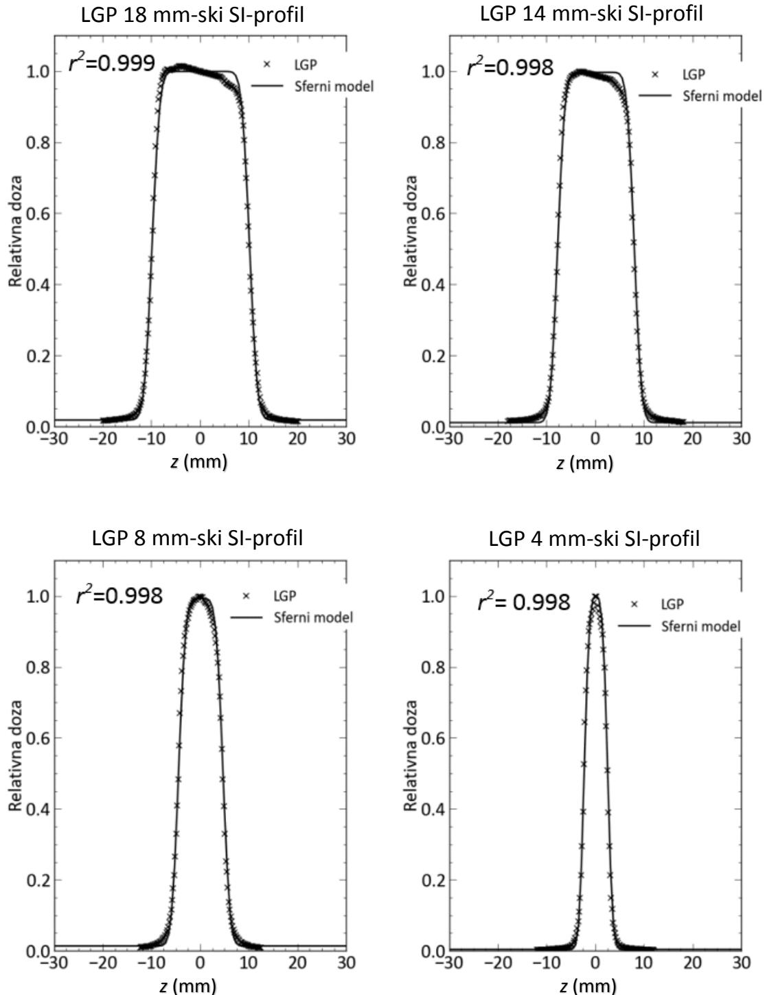
Slika 3.22 Prilagodba analitičke funkcije sfernog modela SI-profilima simuliranim softverom LGP. Profili su simulirani na aksijalnim CT slojevima, a račun doze je proveden po vokselima veličine  $1 \text{ mm}^3$ .
