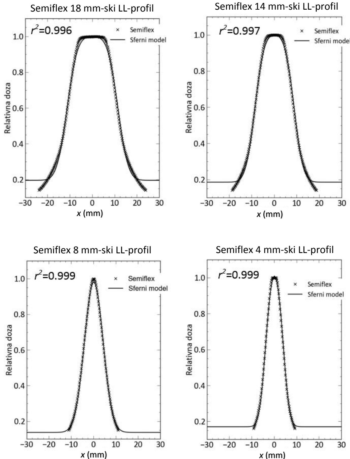
Slika 3.15 Prilagodba analitičke funkcije sfernog modela LL-profilima mjerenum ionizacijskom komorom Semiflex.
