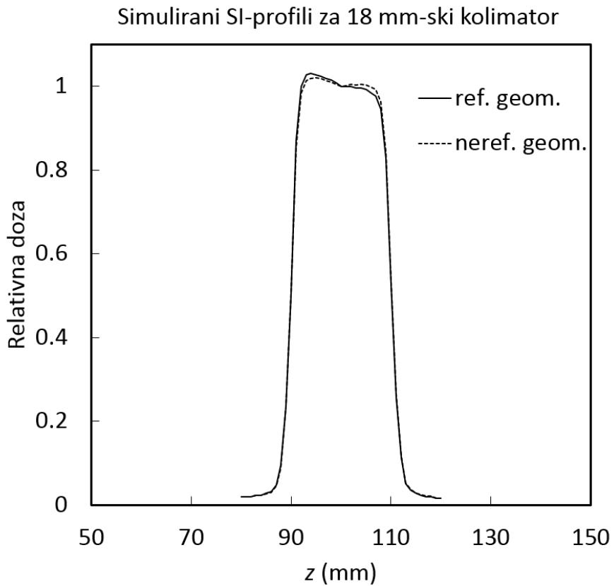
Slika 3.2 Usporedba SI-profila doze simuliranih računalno pomoću LGP-softvera. Kao i u slučaju LL-profila, eksperimentalni postav za mjerjenje profila odgovara nereferentnim geometrijskim uvjetima.
