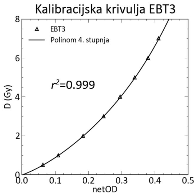
Slika 3.7 Kalibracijska krivulja za radiokromski film EBT3.
