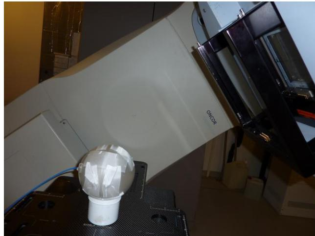
Slika 2.30 PMMA sferni fantom s ionizacijskom komorom namješten u položaj za određivanje kutne ovisnosti odziva u 6 MV fotonskim snopovima linearног akceleratora Siemens ONCOR Expression (Siemens AG, Erlangen, Njemačka). Postav za mjerjenje je bio izocentričan ( $SID = 100\text{cm}$ ).
