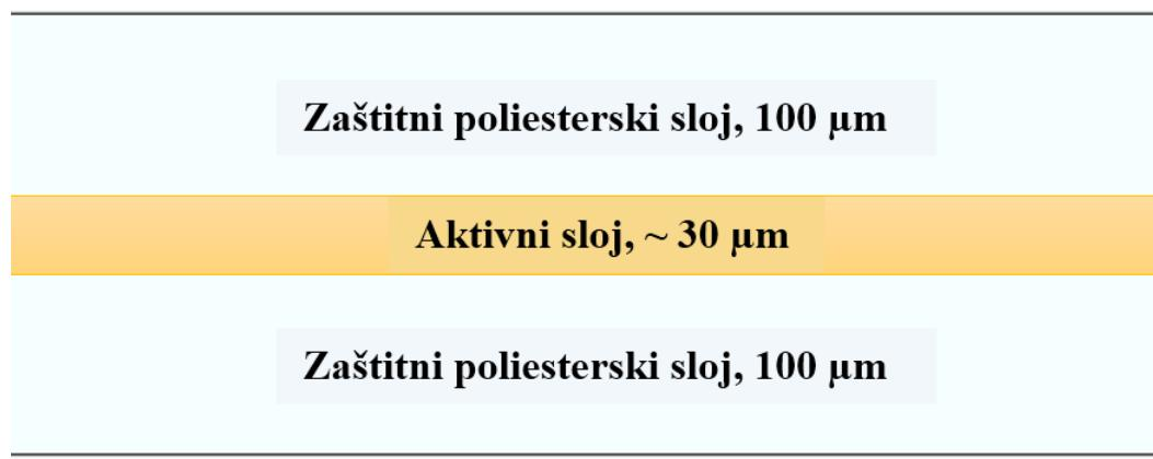
Slika 2.14 Shematski prikaz presjeka GAFCHROMIC EBT3 radiokromskog filma. Aktivni mjerni sloj nalazi se u sendviču između dva simetrična poliesterska sloja ekvivalentna tkivu.
