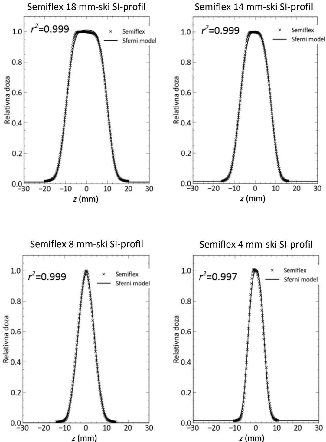
Slika 3.16 Prilagodba analitičke funkcije sfernog modela SI-profilima mjerjenim ionizacijskom komorom Semiflex.
