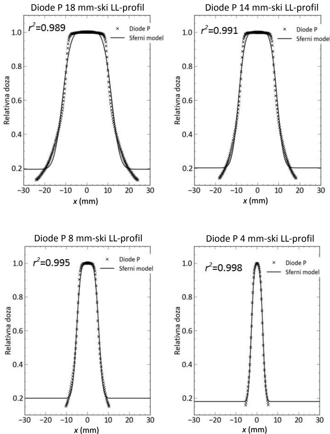
Slika 3.17 Prilagodba analitičke funkcije sfernog modela LL-profilima mjerenum Diode P poluvodičkim detektorom.
