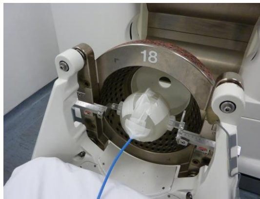
Slika 2.27 PMMA fantom s ionizacijskom komorom namješšan u izocentar Leksellovog gama noža pomoću metalnih zaglavnika.
