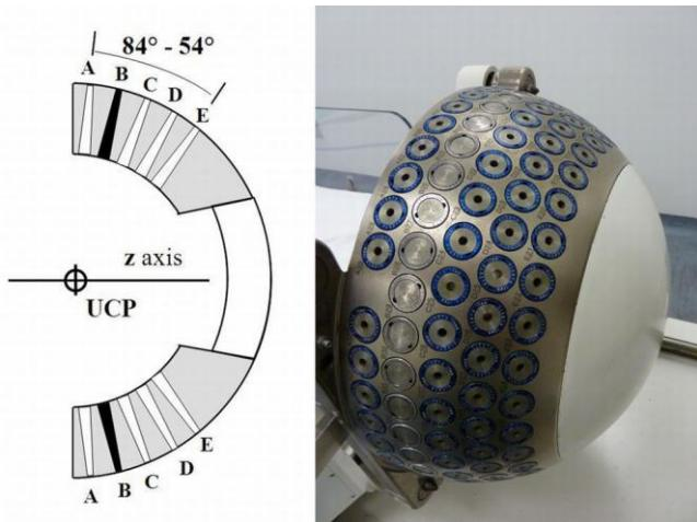
Slika 2.28 Kolimatorska kaciga gama noža s blokiranim kolimatorima prstena B (44 kolimatora potpuno blokiran). Ovakva konfiguracija fotonskih snopova odgovara mjerenoj signalu detektora  $M_2$ .
