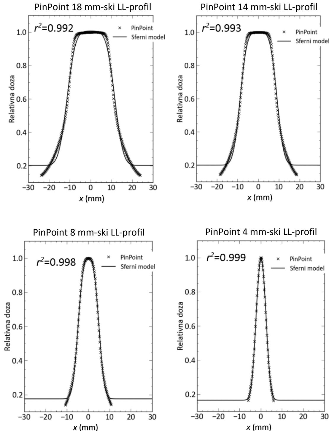
Slika 3.13 Prilagodba analitičke funkcije sfernog modela LL-profilima mjerenum ionizacijskom komorom PinPoint. Profili su mjereni pomoću APS sustava s prostornom razlučivošću od 0.2 mm.
