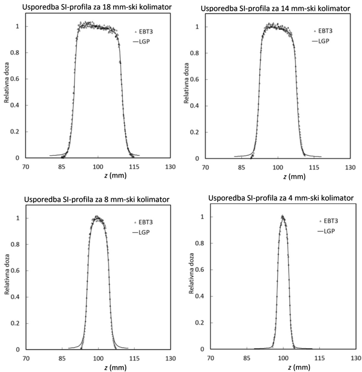
Slika 3.10 Usporedba SI-profila doze mjereni radiokromskim filmovima EBT3 s računalno simuliranim SI-profilima.
