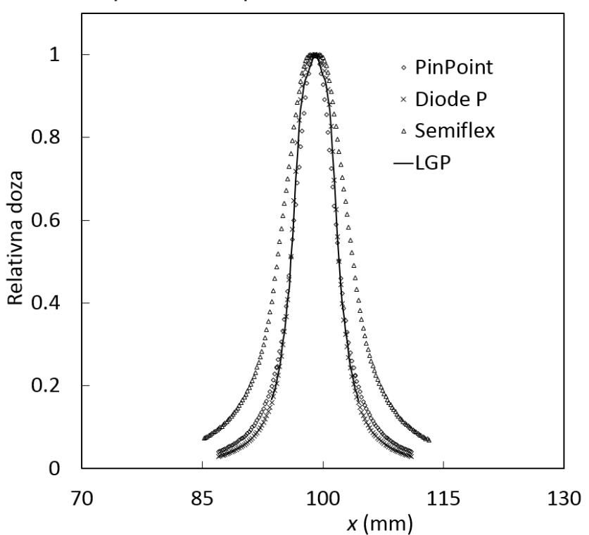
Slika 3.4 Usporedba LL-profila doze za 8 i 4 mm-ski kolimator mjerjenih ionizacijskim komorama PinPoint i Semiflex te poluvodičkim detektorom Diode P s računalno simuliranim LL-profilima (LGP).
