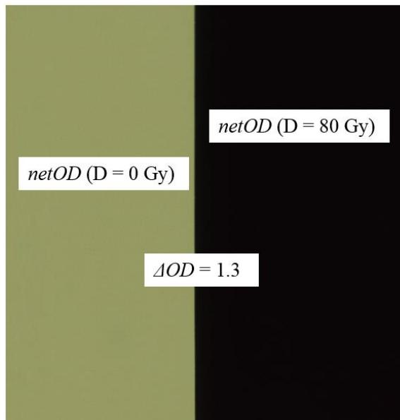
Slika 3.11 Simulacija savršene step-funkcije optičke gustoće skeniranjem preklopljenog neozračenog i jednolikou ozračenog radiokromskog filma EBT3. Za jednoliko ozračivanje filma korišten je 6 MV fotonski snop linearog akceleratora veličine  $20 \times 20 \text{ cm}^2$ . Film je ozračen dozom od 80 Gy kako bi se postiglo maksimalno zacrnjenje filma.
