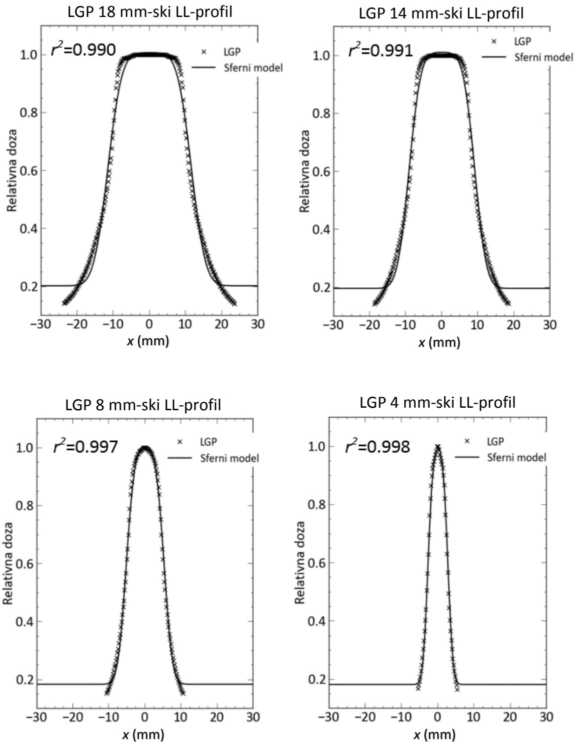
Slika 3.21 Prilagodba analitičke funkcije sfernog modela LL-profilima simuliranim softverom LGP. Profili su simulirani na aksijalnim CT slojevima, a račun doze je proveden po vokselima veličine  $1 \text{ mm}^3$ .
