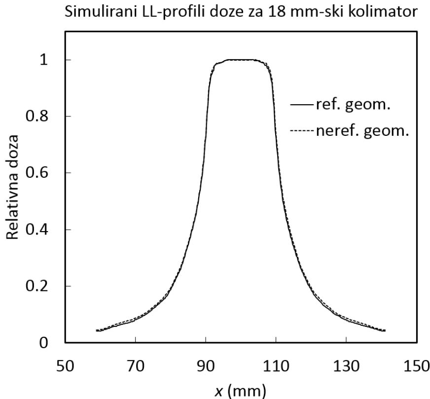
Slika 3.1 Usporedba LL-profila doze simuliranih računalno pomoću LGP-softvera. Profili su simulirani u referentnoj i nereferentnoj geometriji za referentnu 18 mm-sku kolimatorsku kacigu. Eksperimentalni postav za mjerjenje profila odgovara nereferentnim geometrijskim uvjetima.
