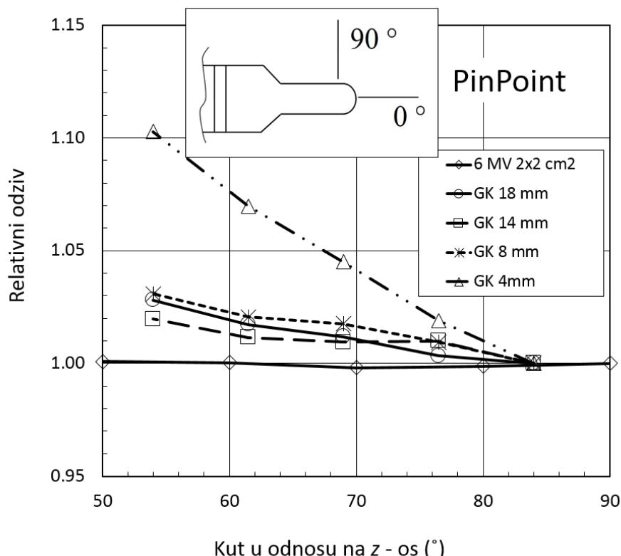
Slika 3.27 Relativni odziv, odnosno kutna ovisnost odziva ionizacijske komore PinPoint mjerena indirektno u fotonskim snopovima gama noža i 6 MV snopovima linearног akceleratora veličine  $2 \times 2 \text{ cm}^2$ . Odziv detektora je normiran na odziv izmјeren pod kutem od  $84^\circ$  u odnosu na z-os gama noža, odnosno  $90^\circ$  za linearni akcelerator, u odnosu na središnju os detektora.
