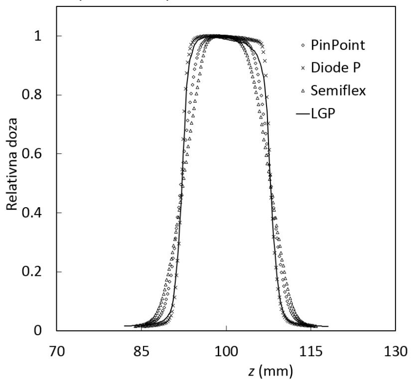
Slika 3.5 Usporedba SI-profila doze za 18 i 14 mm-ski kolimator mjerjenih ionizacijskim komorama PinPoint i Semiflex te poluvodičkim detektorm Diode P s računalno simuliranim LL-profilima
