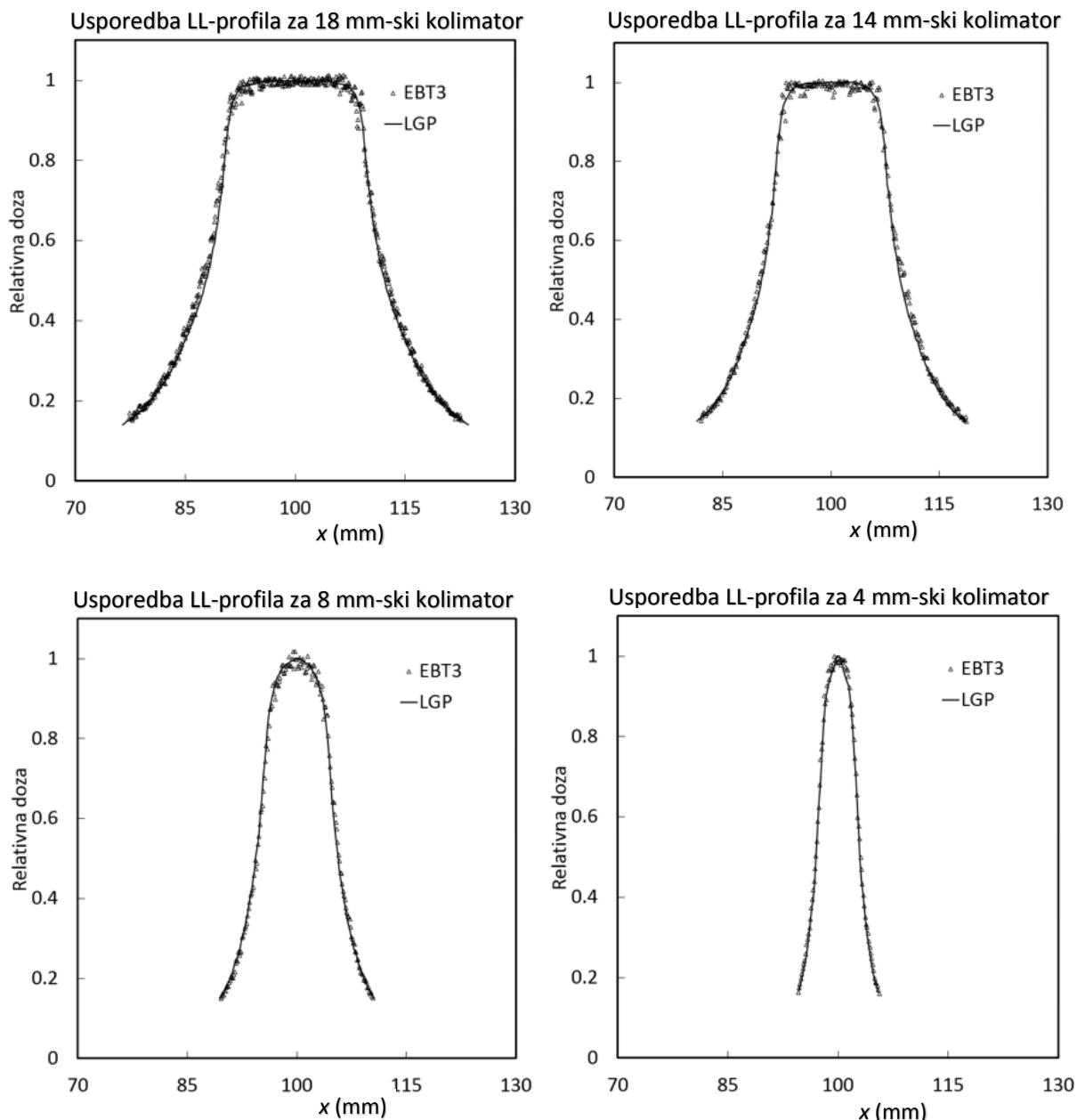
Slika 3.9 Usporedba LL-profila doze mjerene radiokromskim filmovima EBT3 s računalno simuliranim SI-profilima. Primjetno je odlično slaganje mjerene i simulirane profila.
