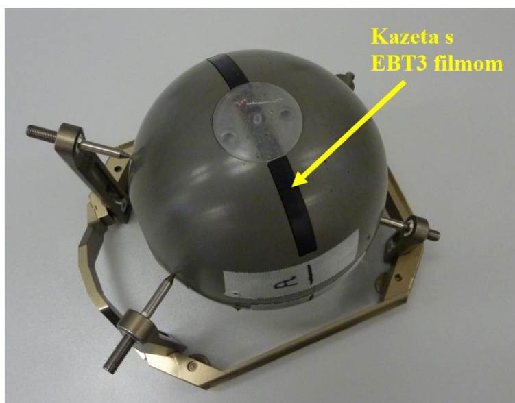
Slika 2.24 Polistirenska kazeta s radiokromskim filmom EBT3 namještena u ABS-fantom koji je učvršćen u Leksellov stereotaktički okvir.
