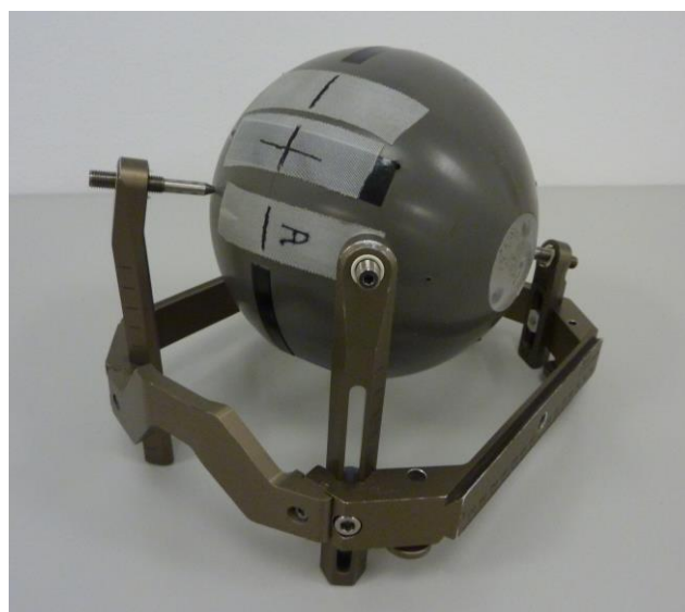
Slika 2.19 Akrilonitrilbutadinstirenski fantom - ABS (Elekta AB, Stockholm, Švedska) učvršćen u Leksellov stereotaktički okvir.
