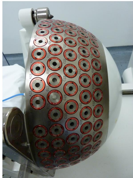
Slika 2.10 Shematski prikaz kolimatorske kacige i položaja fotonskih snopova u odnosu na izocentar.
