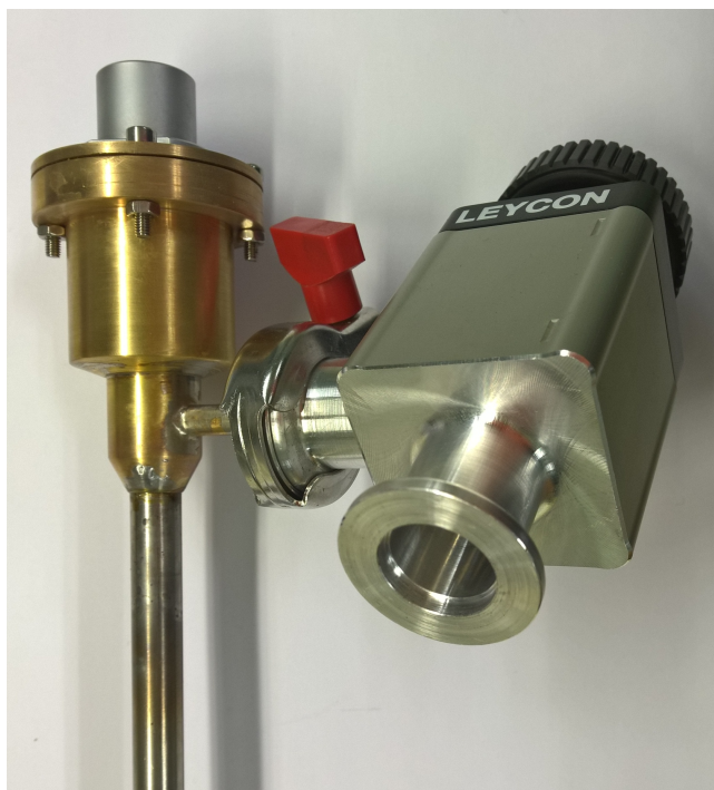
Slika 4.3: Gornji dio probe s vakuumskim izlazom i konektorom za spajanje instrumenata na pripadne vodiče.
