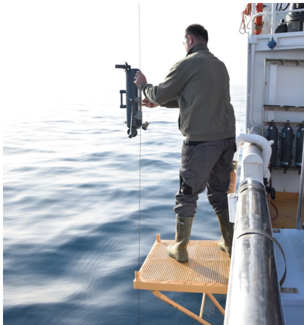
Slika 12. Niskinov crpac- uređaj za uzimanje uzoraka vode
