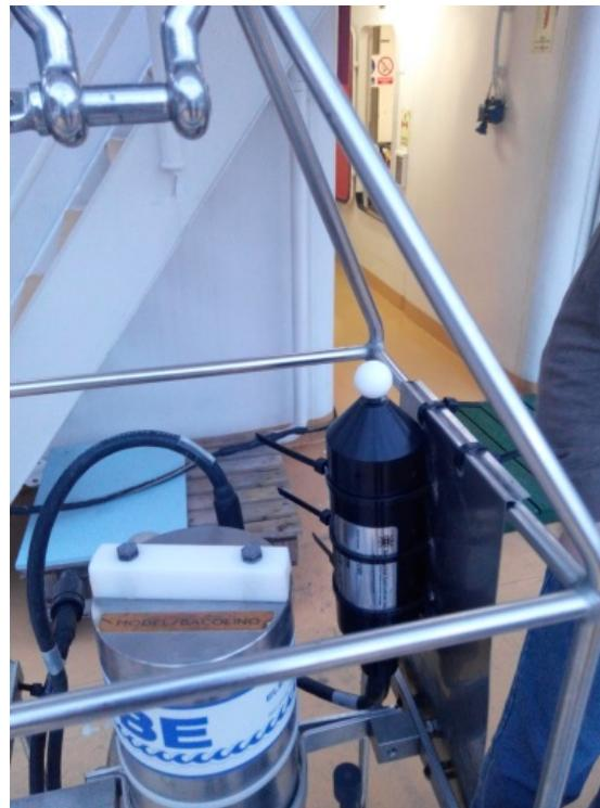
Slika 10. Bio-optički senzor za mjerjenje fotosintetski aktivne radijacije -PAR
