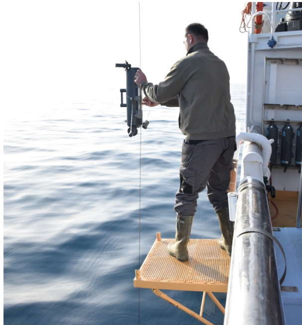
Slika 12. Niskinov crpac- uređaj za uzimanje uzoraka vode
