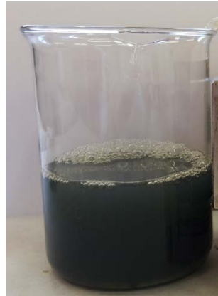
Slika 6. Dobivena suspenzija nakon zračenja otopine na slici 5. Dobivena je izuzetno stabilna zelenkasto-sivo-smeđa suspenzija.
