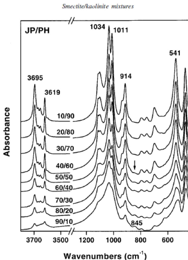
Slika 73- Prikaz IR spektrograma uzorka sa različitim udjelima smektičnog i kaolinita. Preuzeto iz Madejova et al.(2002)
