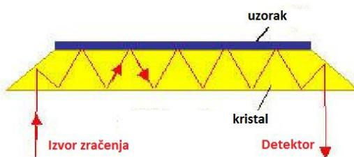
Slika 21- princip rada ATR tehnike. Preuzeto iz Madejova (2013)
