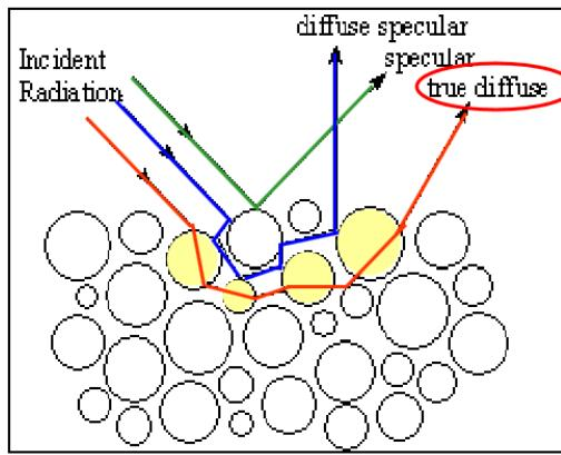
Slika 22- Princip rada DRIFT tehnike. Preuzeto iz Madejova (2013)
