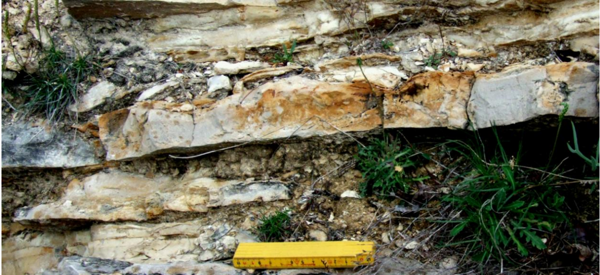
Sl. 19 Oko 11 cm deo sloj facijesa C1. Amplituda riplova u gornjem dijelu je između 2 i 3 cm. Mjerilo je dugačko 22 cm.
