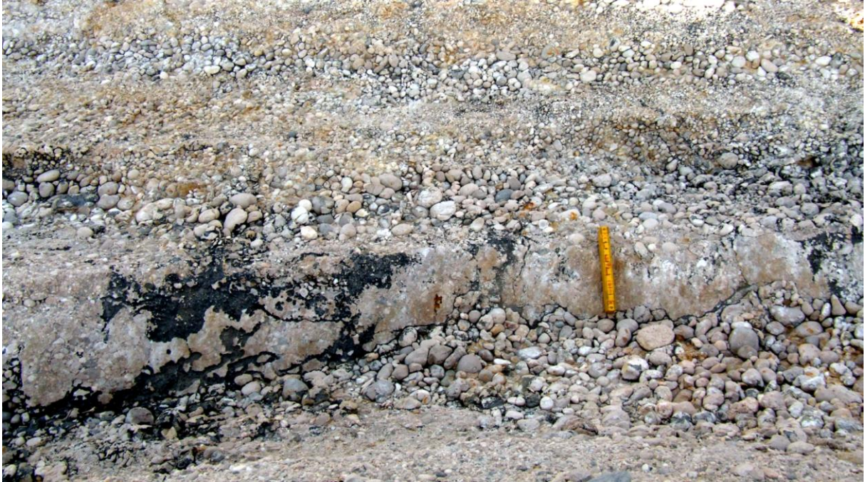
Sl. 14 Izmjena pločastih slojeva sitnog i srednjeg "pebbles". Valutice su dobro zaobljene, jako dobro sortirane, klastične potpore bez matriksa. Mjerilo je dugačko 22 cm. Log NOV4.
