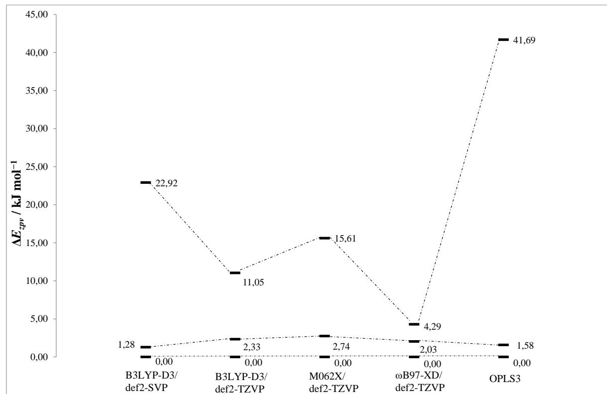
Slika D2. Relativne energije konformera azodioksida nitrozobenzena korigirane za energiju nulte točke izračunate na različitim razinama teorije.
