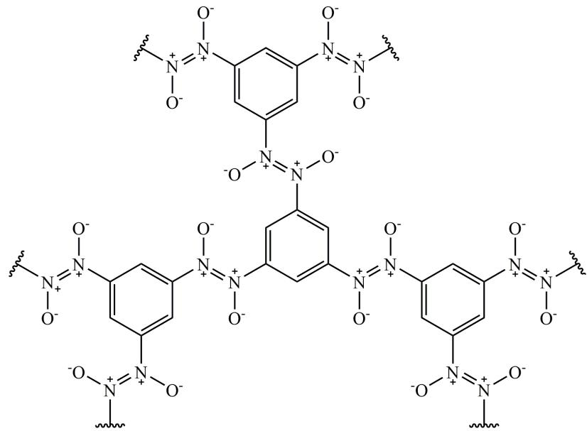
Slika 9. Prepostavljena polimerna struktura 1,3,5-trinitrozobenzena.
