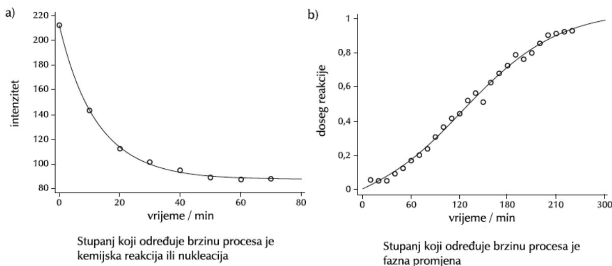
Slika 11. Kinetičke krivulje za procese u čvrstom stanju u kojem brzinu određuje (a) kemijska reakcija ili nukleacija i (b) fazna promjena.<sup>25</sup>
