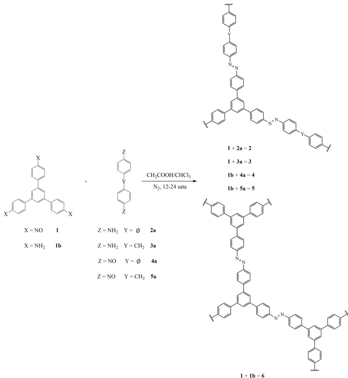
Slika 18. Prikaz sinteze aromatskih azo spojeva **2-6**.
