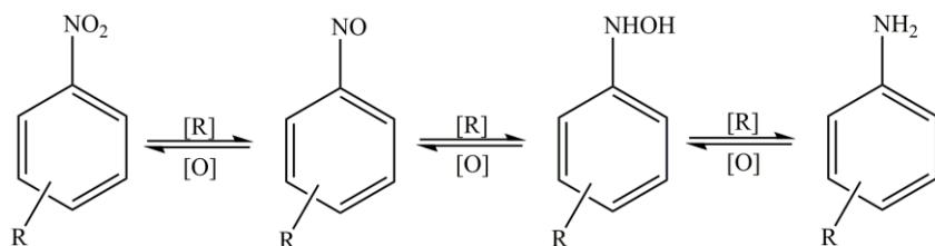
Slika 6. Priprava aromatskih C-nitrozo spojeva redukcijom odgovarajućeg nitro odnosno oksidacijom amino derivata.
