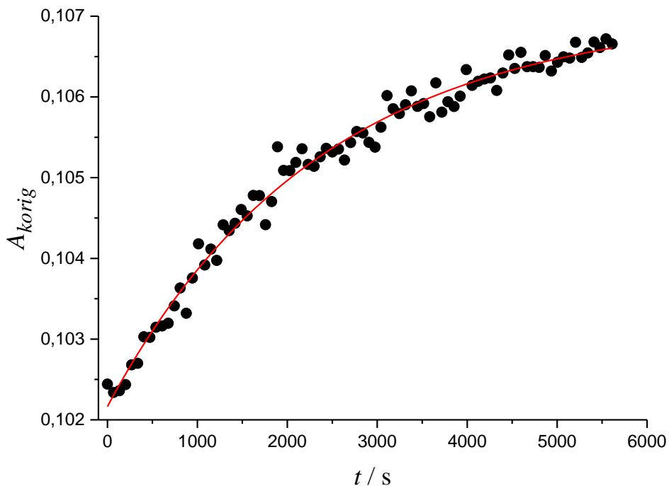
Slika 22. Ovisnost korigirane apsorbancije karakteristične vrpce  $E$ -azodioksidne skupine spoja **1** pri  $1261\text{ cm}^{-1}$  o proteklom vremenu na temperaturi od  $135\text{ K}$ .
