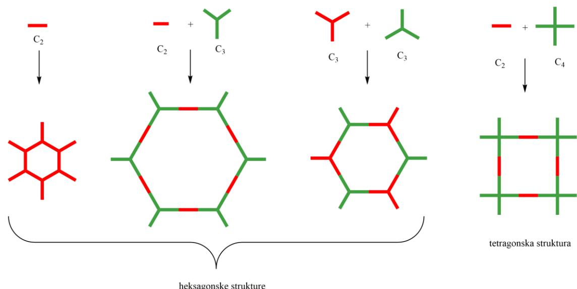
Slika 16. Prikaz mogućih građevnih blokova i nastalih struktura 2D kovalentno-organskih mreža.
