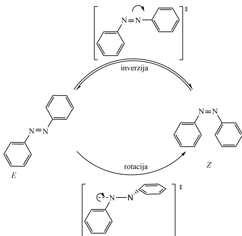
Slika 14. Predloženi mehanizam *E-Z* izomerizacije azobenzena.
