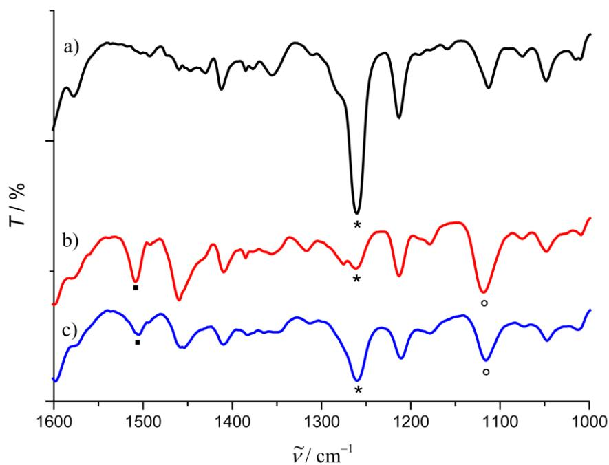
Slika 21. IR spektar spoja **1** u KBr pastili a) prije ozračivanja UV svjetlom pri  $13\text{ K}$ ; b) nakon  $120\text{ min}$  ozračivanja UV svjetlom pri  $13\text{ K}$ ; c) nakon zagrijavanja na  $298\text{ K}$ . Karakteristična vrpca asimetričnog istezanja *E*-azodioksidne veze označena je zvjezdicom, a karakteristične
