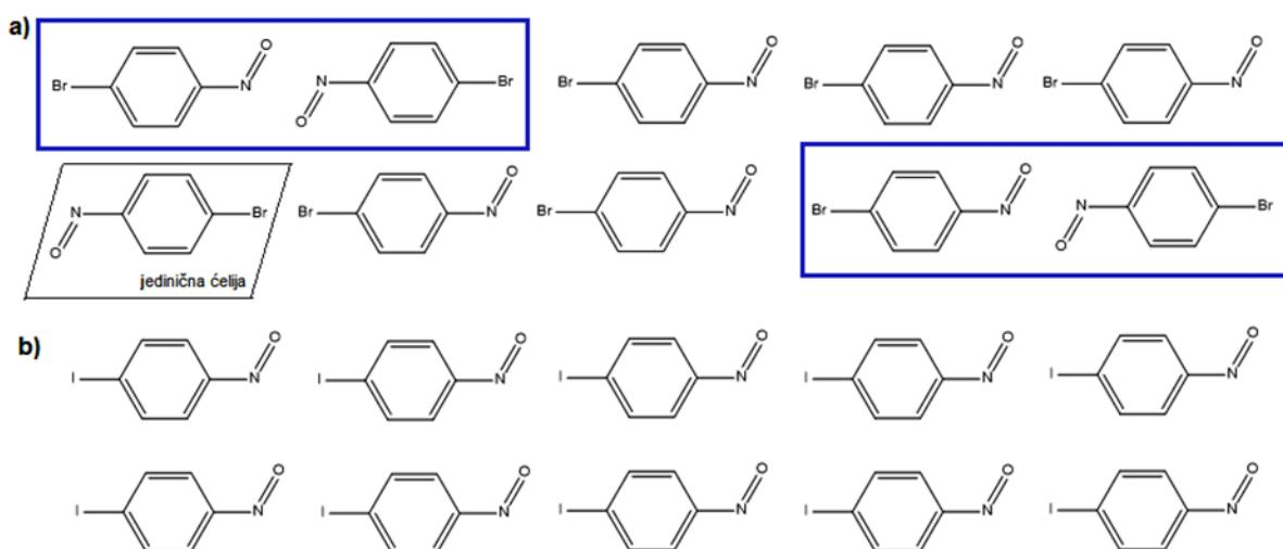
Slika 12. Prikaz rasporeda molekula u sublimiranom a) *p*-bromnitrozobenzenu i b) *p*-jodnitrozobenzenu. Plavo zakružene molekule u povoljnijem su položaju za nastajanje azodioksidne veze.<sup>28</sup>
