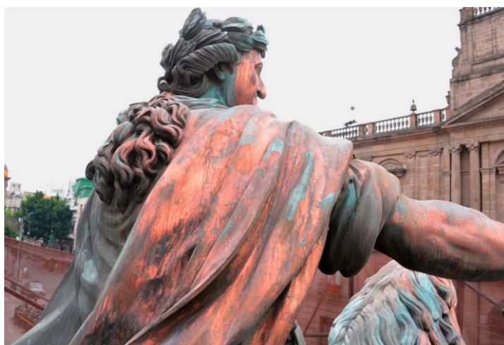
Slika 5. Bazični bakrov karbonat kao korozija na skulpturi
