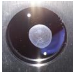
Slika 2.3 Tanki film Na-DNA u čistoj vodi (Protokol i I b ) na silicijevom nosaču. Film je pripremljen sušenjem 30 \mu\text{L} uzorka pomoću vakuumpumpe u eksikatoru tijekom 10 min.
