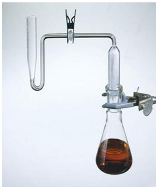
Slika 3. Aparatura za detekciju i određivanje arsena spektroskopskom metodom sa srebrovim dietilditiokarbamatom 17
