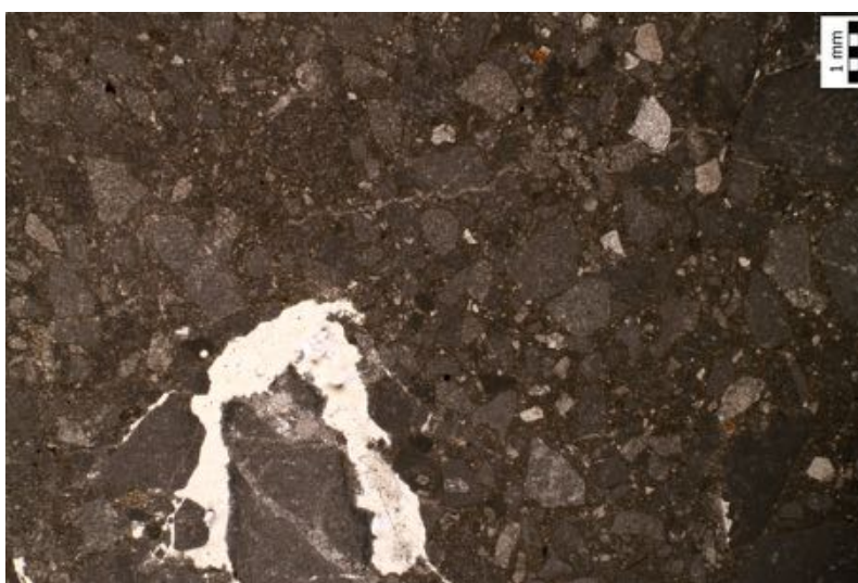
Slika 37) Mikrobreča sa zrnima biomikrita. Uzorak/točka 1222.
