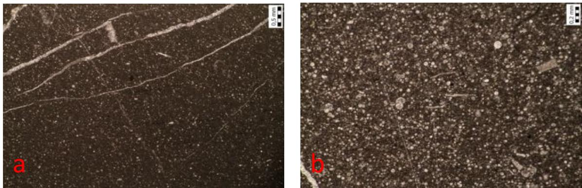
Slika 18) Biomikrit s kalcisferama i pitonelama (a uzorak T-8, točka TV6; b uzorak T-9, točka TV7).
