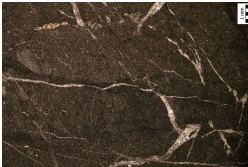
Slika 35) Mikrobreča ispresijecana kalcitnim žilama. Uzorak T-10, točka TV8.
