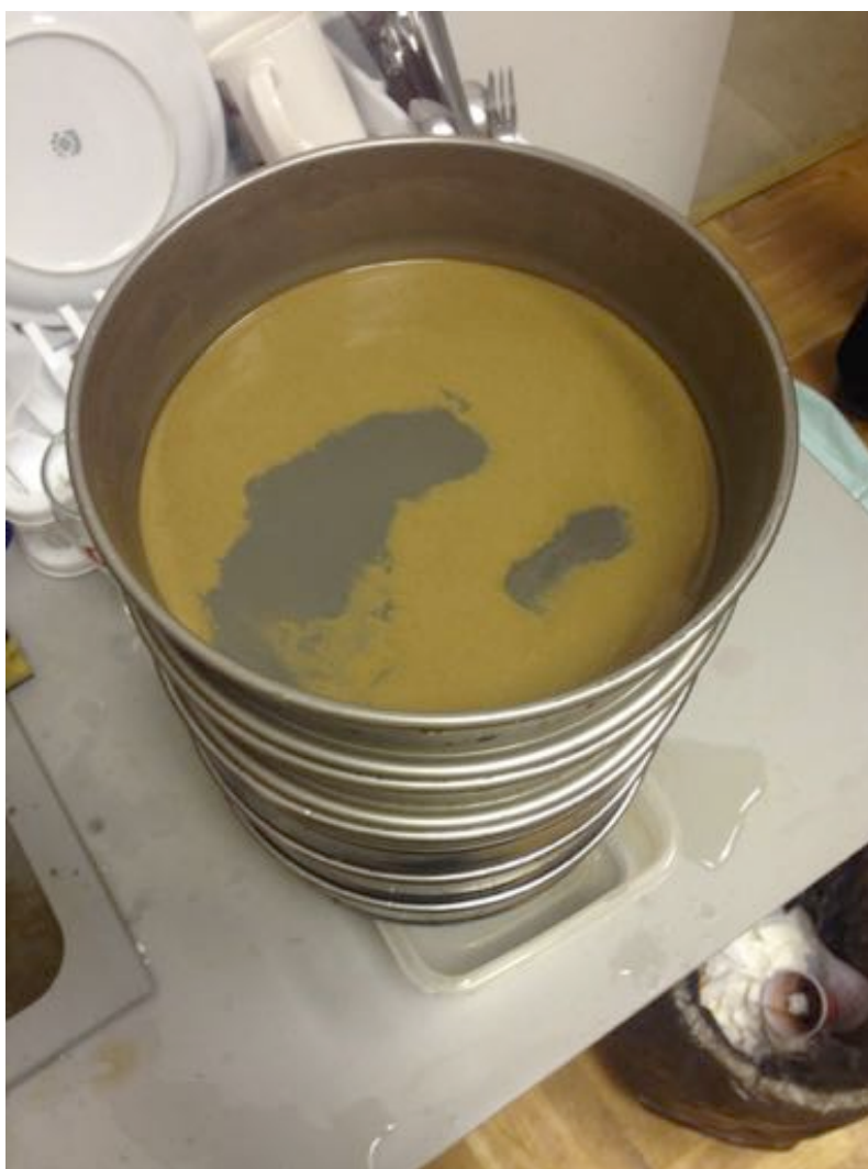
Slika 9) Sisanje uzorka pijeska kroz sita različite veličine.
