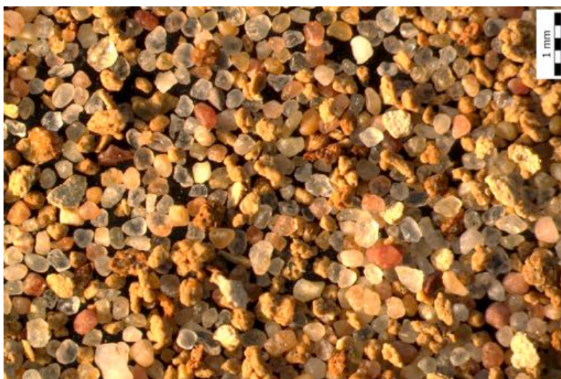
Slika 39) Kvarcni pijesak, uzorak 1272.
