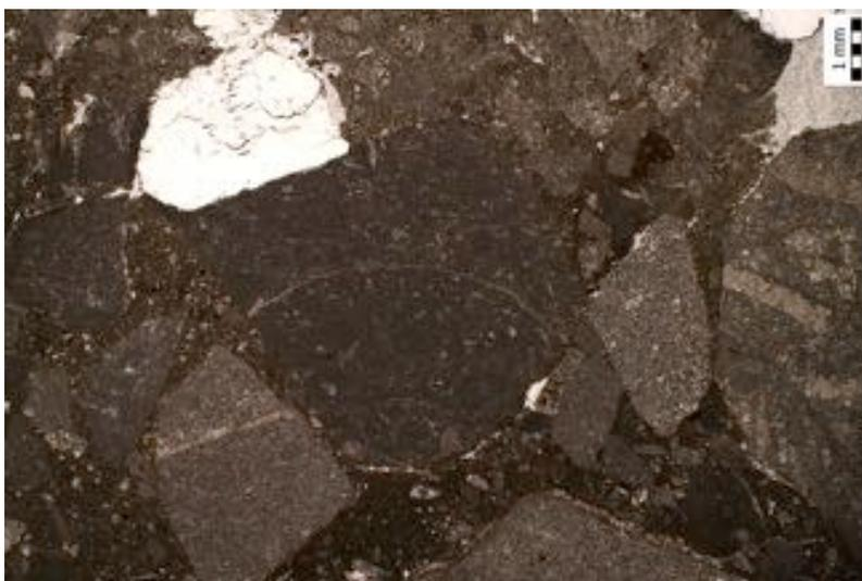
Slika 36) Mikrobreča sa zrnima biomikrita. Uzorak/točka 1222.
