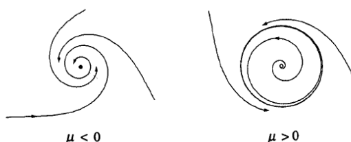
Slika 2.6: Fazni tok sustava s nadkritičnom Hopfovom bifurkacijom zavisno o vrijednosti parametra \mu
