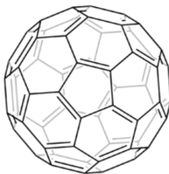
Slika 1. Struktura kavezaste molekule C_{60}
