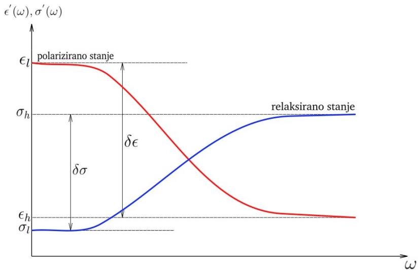
Slika 1.1.7: Realni dio kompleksne dielektrične funkcije u Debyevom modelu (crveno) sa pripadnim limesima  $\epsilon_l$  i  $\epsilon_h$ ; realni dio kompleksne vodljivosti u Debyevom modelu (plavo) i pripadni limesi  $\sigma_l, \sigma_h$
