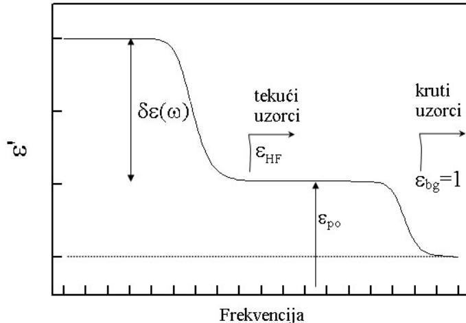
Slika 3.1.1: Puna crta prikazuje realni dio dielektrične funkcije. Za tekuće uzorke vidimo povećanje  $\epsilon_{HF}$  zbog parazitskih efekata; točkasta crta prikazuje dielektričnu konstantu vakuma. [18]
