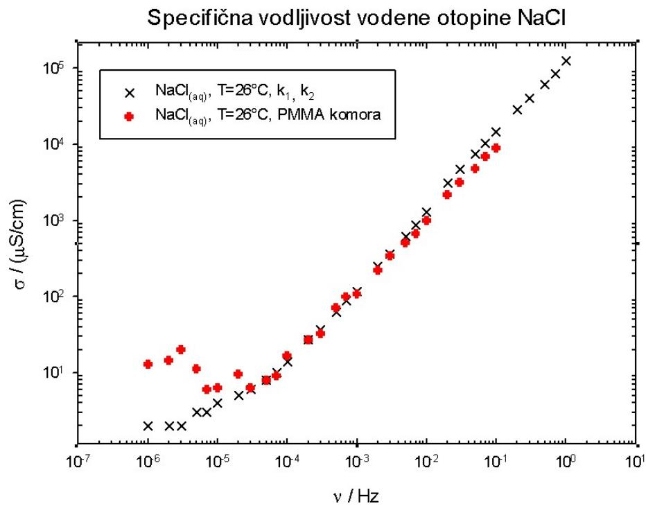
Slika 4.1.3: Specifična vodljivost vodene otopine NaCl u PMMA komori, značajna saturacija se vidi na koncentracijama ispod  $30\mu\text{M}$ , ponašanje do te koncentracije je približno linearno kako teorija i predviđa, malo odstupanje na većim koncentracijama moguće zbog elektronike.
