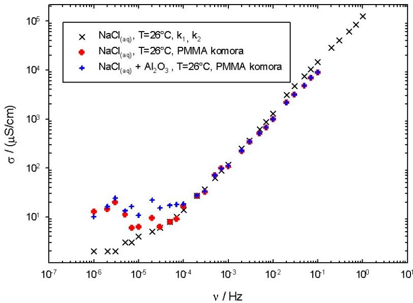
Slika 4.1.4: Specifična vodljivost vodene otopine NaCl s  $Al_2O_3$  nanoporoznom membranom u PMMA komori (plavo), nema značajne razlike u saturaciji u odnosu na samu otopinu u istoj komori, vodljivost je malo veća zbog dodatnog otpuštanja iona od membrane koji su ostali od prijašnjih mjerena.
