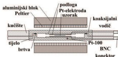
Slika 2.2.2: Shematski prikaz prve komore za dielektrična mjerena [16]
