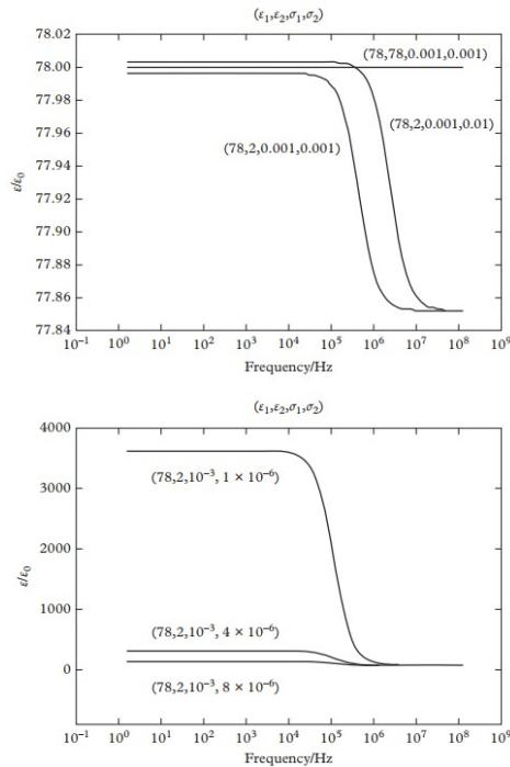
Slika 1.1.5: Numeričke simulacije prema jednadžbi (1.42) spektra permitivnosti i vodljivosti za dvoslojni dielektrik s debeljinama  $d_1 = 1\text{mm}$  i  $d_2 = 10\text{nm}$ , vrijednosti zadanih karakterističnih permitivnosti i vodljivosti su prikazane u zagradama u redu  $(\epsilon_1, \epsilon_2, \sigma_1, \sigma_2)$  [3]
