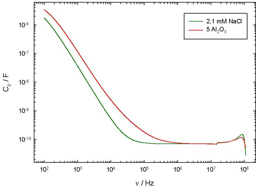
Slika 4.4.10: Dielektrični spektar također pokazuje različite vrijednosti za sustav Al<sub>2</sub>O<sub>3</sub> membrana (crveno) i 2,1 mM vodenu otopinu NaCl (zeleno)
