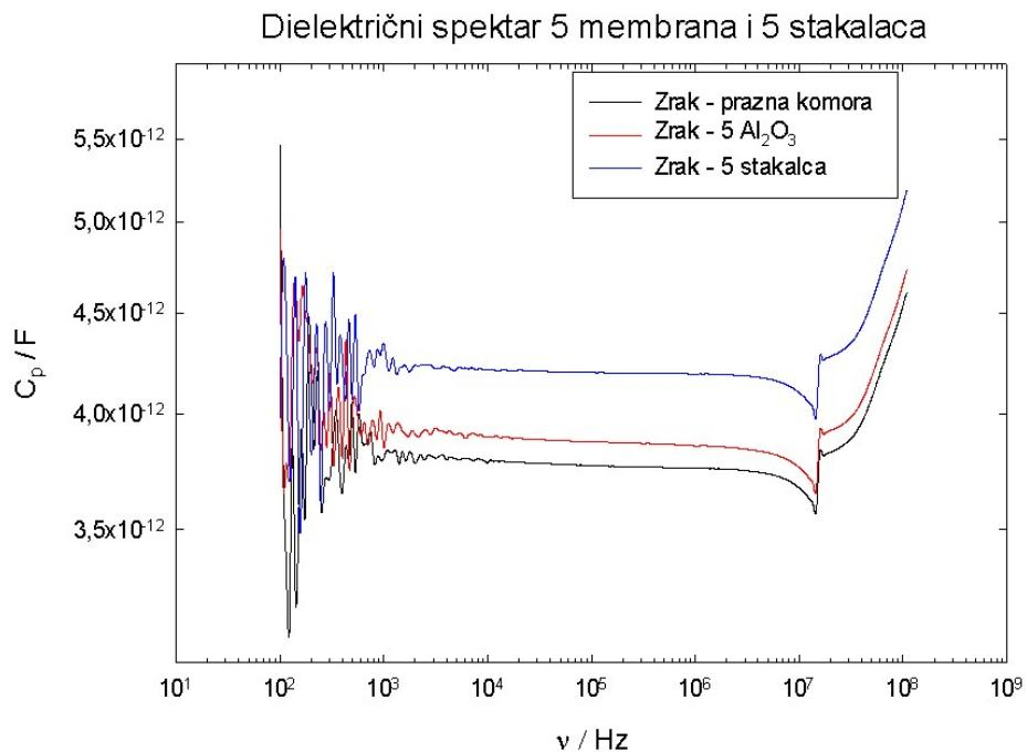
Slika 4.3.7: Dielektrični spektar prazne komore prikazan je crnom linijom, služi kao pozadina. Dielektrični spektar 5 naslaganih membrana prikazan je crvenom linijom, a stakalca plavom. U sva tri slučaja imamo velik šum na niskim frekvencijama, na visokim frekvencijama imamo rezonanciju s komorom pa taj dio spektra zanemaruјemo
