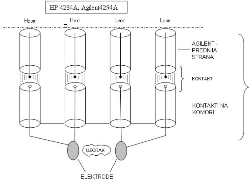
Slika 2.2.3: Spoj Agilent 4294A mjerača impedancije i komore za dielektrična mjerenja [18]
