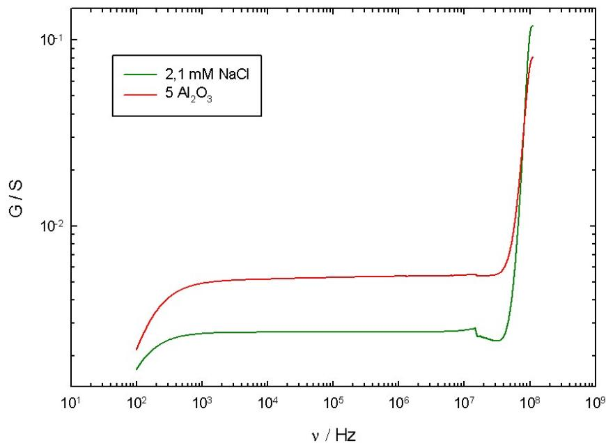
Slika 4.4.9: Spektar vodljivosti 2,1 mM NaCl (zeleno) znatno se razlikuje od mjerennog spektra vodljivosti 5  $\text{Al}_2\text{O}_3$  membrana (crveno); područje preklapanja na visokim frekvencijama ne uzimamo u obzir kao i približavanje na niskim frekvencijama jer nisu fizikalno značajna
