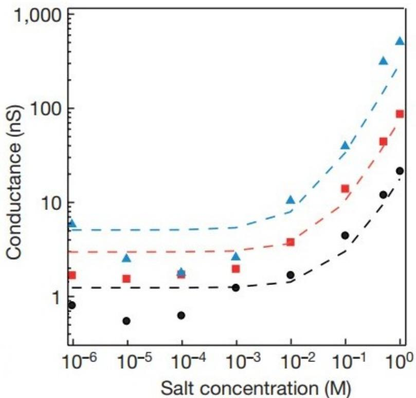
Slika 4.1.1: Saturacija vodljivosti iz *Feng et al.* (2016), tri linije su za različite veličine nanopora: crna - 2nm, crvena - 6nm i plava - 25nm; saturacija nastupa ispod 5mM KCl koncentracije, iscrtkane linije predstavljaju funkciju prilagodbe [17]
