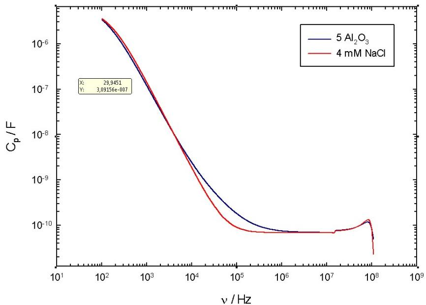
Slika 4.4.12: Dielektrični pet Al<sub>2</sub>O<sub>3</sub> membrana (plavo) i 4,4mM NaCl (crveno), u području između 10 kHz do 1 MHz vidimo odvajanje kapaciteta sustava membrana od otopine, odnosno u tom području prisutna je neka dodatna polarizacija u sustavu koja povećava dielektričnu konstantu sustava membrana
