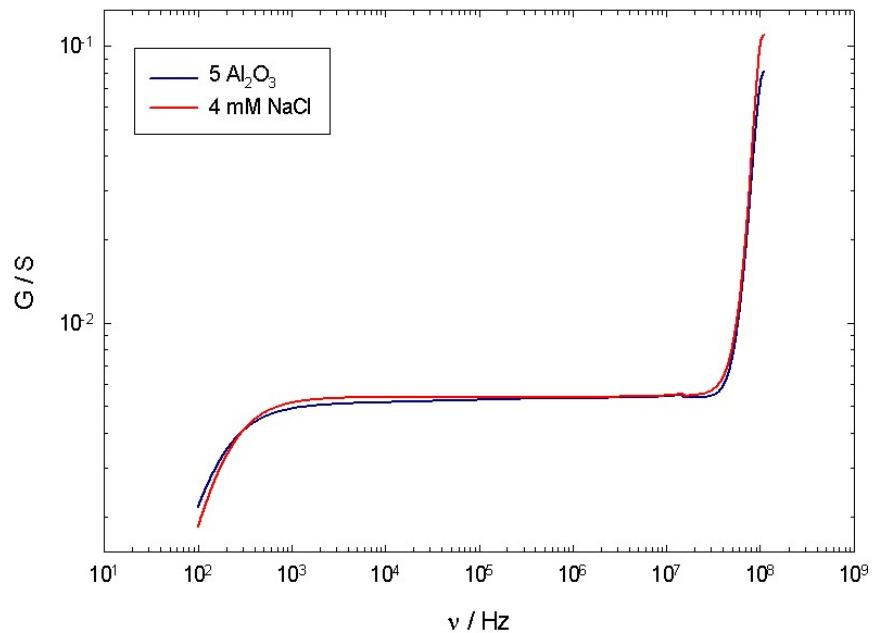
Slika 4.4.11: Spektar vodljivosti pet Al<sub>2</sub>O<sub>3</sub> membrana (plavo) i 4,4mM NaCl (crveno)
