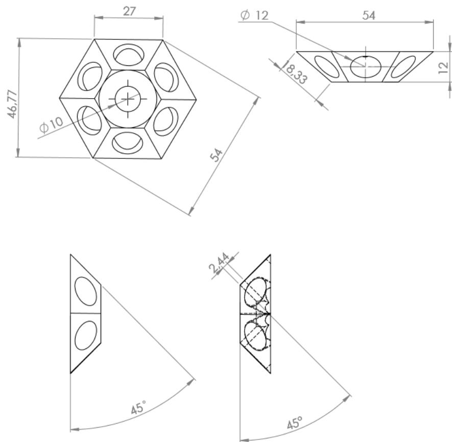
Slika 5.3: Shematski prikaz nosača [2]
