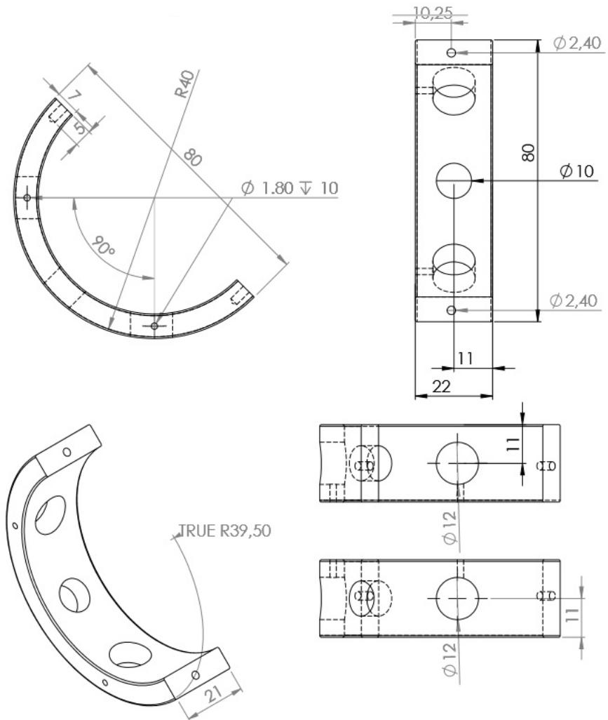
Slika 5.5: Shema drugog prototipa nosača detektora [2]
