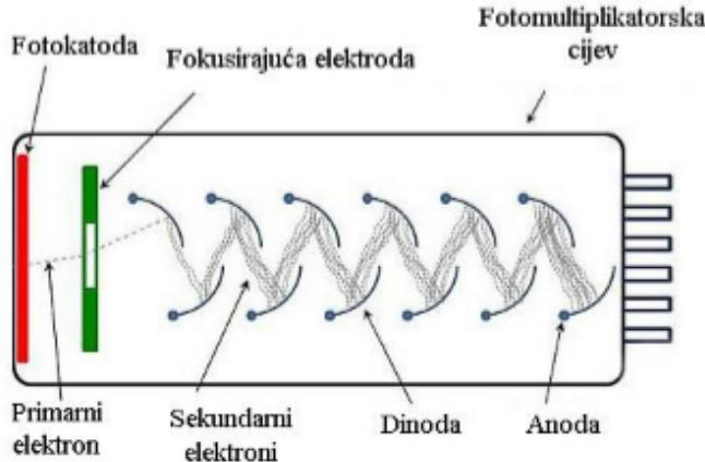
Slika 4.1: Shematski prikaz tipičnog "end-on" fotomultiplikatora [10]
