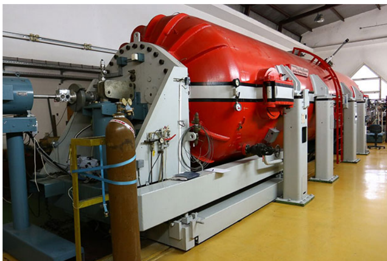
Slika 2.2: Tandem Van de Graaff akcelerator
