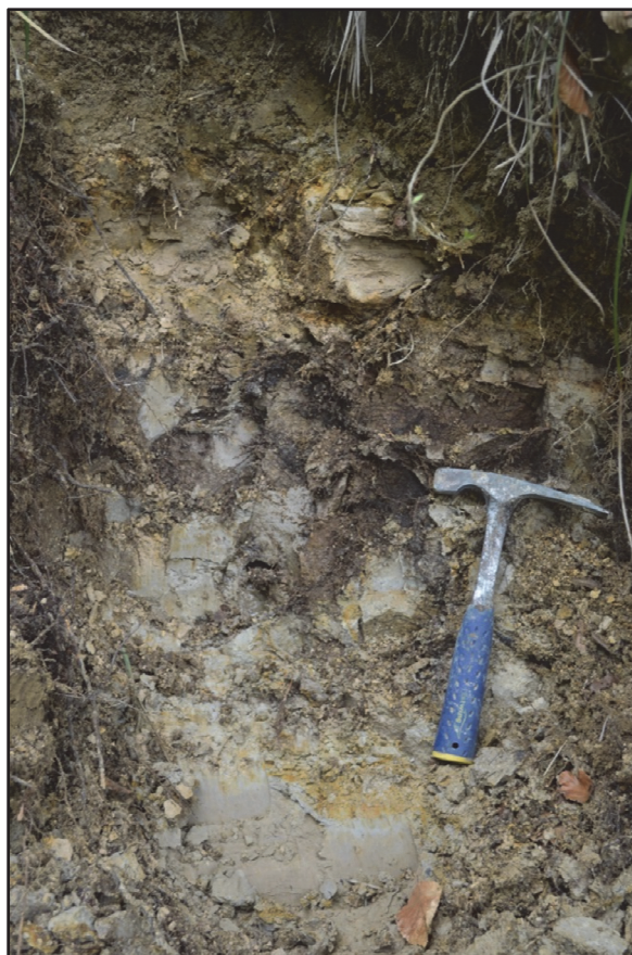
Slika 4.3. Sloj tufa na lokalitetu Sjeniĉak. Mjerilo duljine - ĉekić (25 cm).
