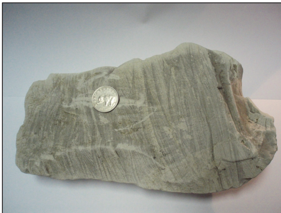
Slika 4.14. Litificirani tuf s lokaliteta Gornja Jelenska. Mjerilo – kovanica promjera 26.5 mm.
