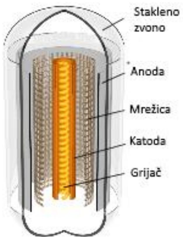
**SLIKA 13** Elektroni se emitiraju sa indirektno grijane katode nakon čega se njihovo ubrzanje kontrolira anodom. Cijela aparatura je zatvorena u stakleno zvono [16]
