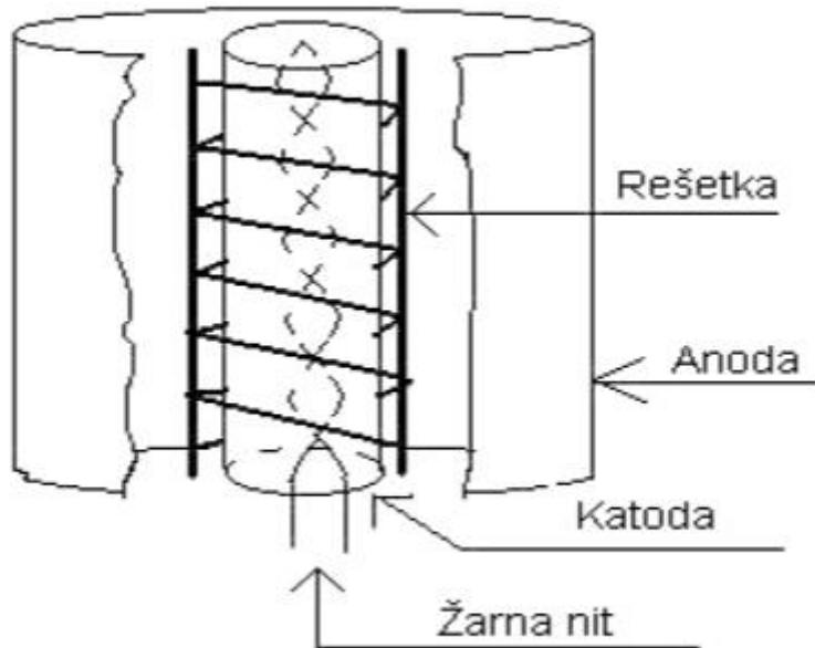
SLIKA 18 Shematski prikaz triode [23]
