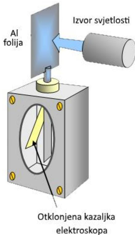
**SLIKA 28 Eksperimentalni postav za obasjavanje elektroskopa običnom žaruljom [31]**
