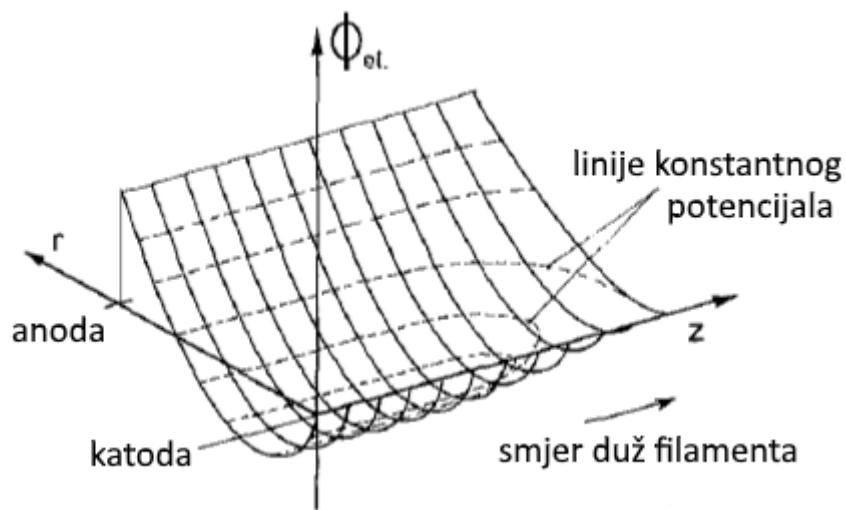
**SLIKA 26 Potencijal unutar diode kao funkcija radikalne udaljenosti od katode  $r$  i smjera duž filamenta katode  $z$  [29]**
