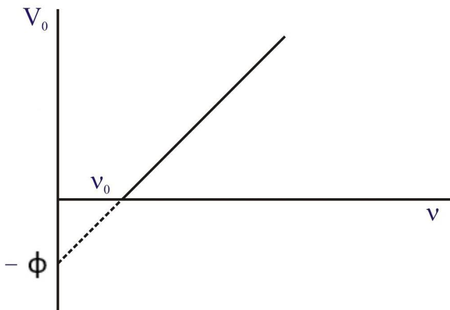
**SLIKA 4** Millikanov graf zaustavnog potencijala  $\nu_0$  u ovisnosti o frekvenciji  $\nu$  za fotolektrični efekt.  $\nu_0$  je minimalna frekvencija potrebna za izazivanje fotoefekta
