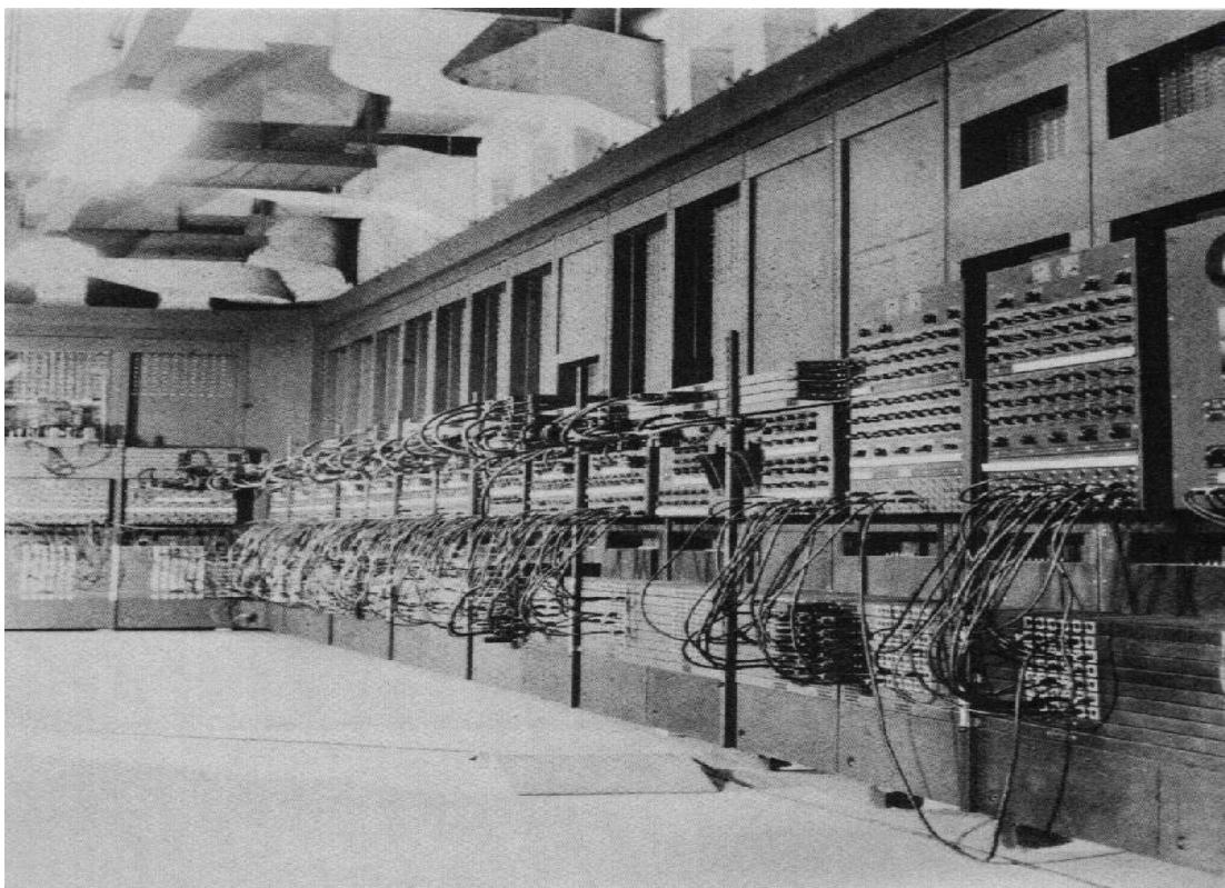
SLIKA 21 Kompjutor ENIAC, napravljen od skoro 20 000 elektronskih cijevi [22]
