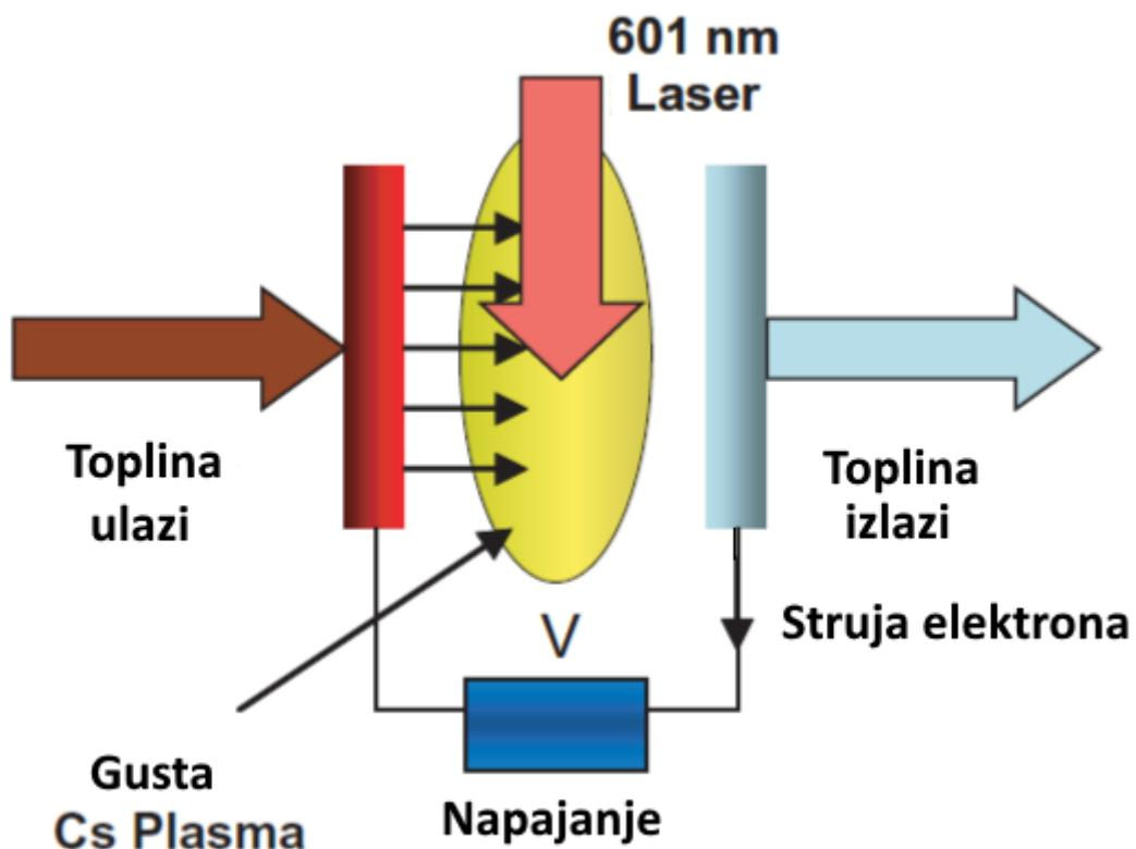
SLIKA 27 Shematski prikaz rada termionskog konvertera energije [30]
