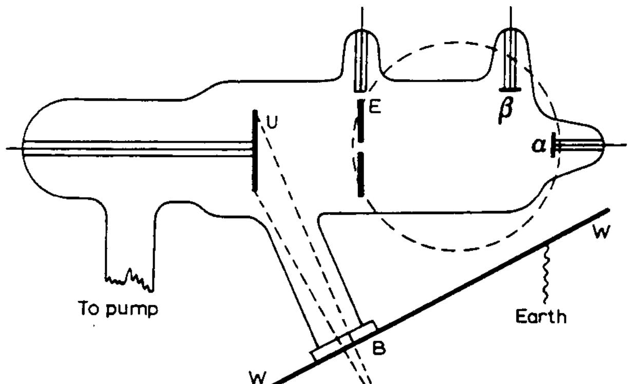
**SLIKA 2** Lenardov postav fotoelektričnog efekta. U – katoda, E – ploča koja propušta tanak snop,  $\alpha$  - pločica na koju pada neotklonjeni snop,  $\beta$  - pločica na koju pada otklonjeni snop, B – kvarcni prozor [4]
