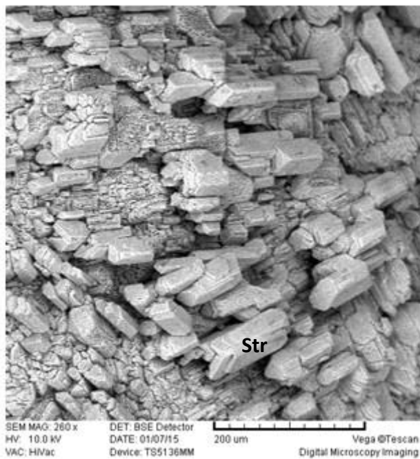
Slika 34. SEM instrumentom snimljeni kristali minerala struvita (Str), pokazuju određenu orijentaciju i pravilno slaganje, veličina kristala varira od 10 \mu\text{m} do 100 \mu\text{m}
