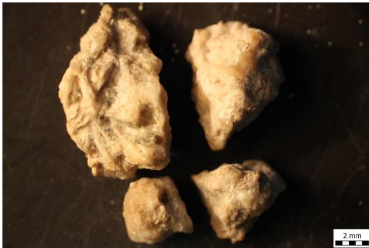
Slika 18. Uzorak Os2 sastoji se od četiri fragmenata jednog kamenca, vanjska površina se razlikuje od unutrašnjosti, s unutrašnje strane vidljivi pločasti kristali
