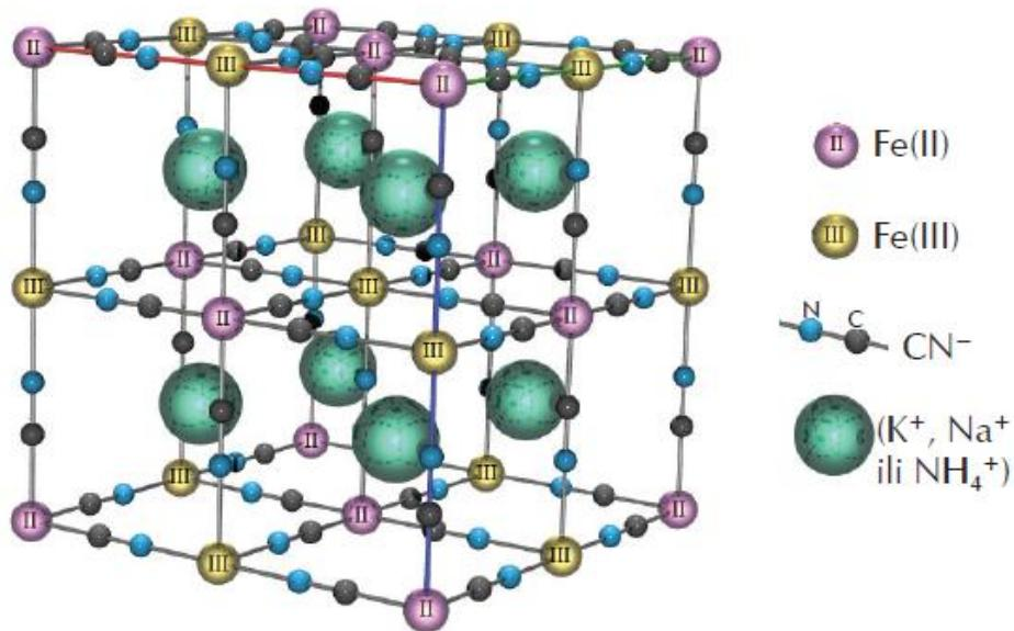
Slika M4. Prikaz jedinične čelije kristalne strukture topljivog berlinskog modrila<sup>17</sup>
