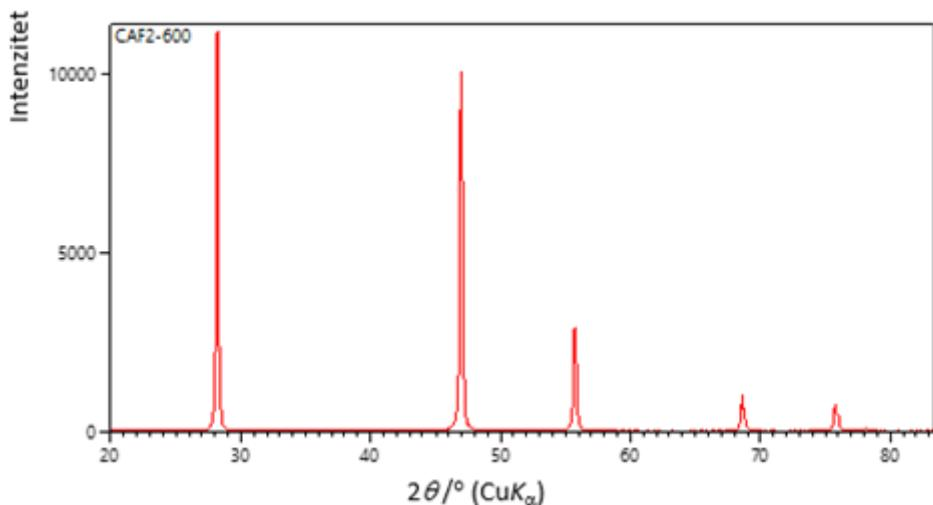
Slika 36. Difrakcijska slika uzorka CaF<sub>2</sub>
