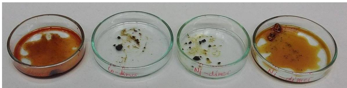
Slika 39. Dobiveni kristali  $[\text{Co(idaa)}_2]\text{I}_3\text{I}$  i  $[\text{Ni(idaa)}_2]\text{I}_3\text{I}$  te otopine iz kojih su izrasli
