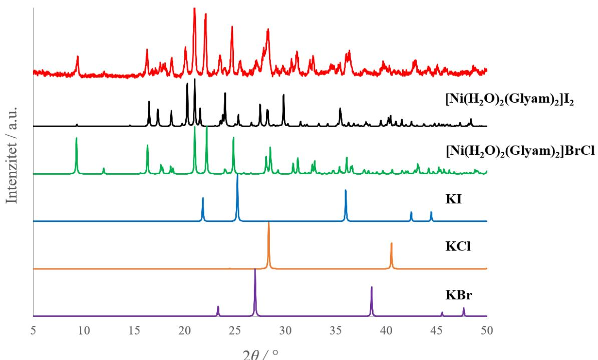
Slika D3. Usporedba snimljenog (crveno) te izračunatog (crno) rendgenskog difraktograma praha  $[\text{Ni}(\text{H}_2\text{O})_2(\text{Glyam})_2]\text{I}_2$  s difraktogramima  $[\text{Ni}(\text{H}_2\text{O})_2(\text{Glyam})_2]\text{BrCl}$ ,  $\text{KI}$ ,  $\text{KCl}$  i  $\text{KBr}$
