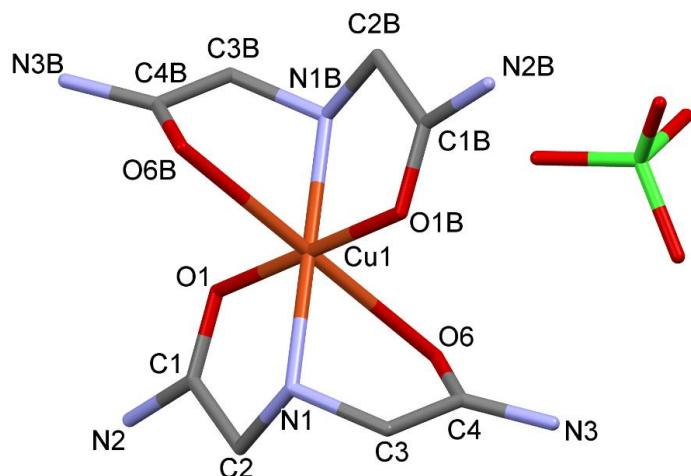
Slika 30. Prikaz kompleksnog spoja  $[\text{Cu}(\text{idaa})_2](\text{ClO}_4)_2$  (refcode: IMACUP) (za izradu crteža upotrebljen je program *Mercury 3.8.*)<sup>16</sup>
