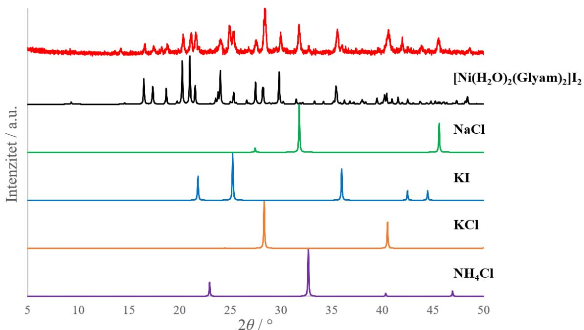
Slika D2. Usporedba snimljenog (crveno) te izračunatog (crno) rendgenskog difraktograma praha  $[\text{Ni}(\text{H}_2\text{O})_2(\text{Glyam})_2]\text{I}_2$  s difraktogramima  $\text{NaCl}$ ,  $\text{KI}$ ,  $\text{KCl}$  i  $\text{NH}_4\text{Cl}$
