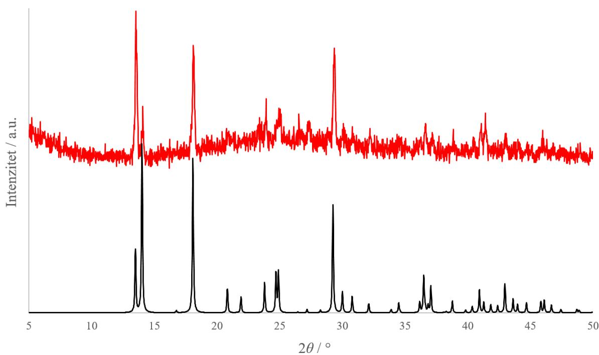
Slika D6. Usporedba rendgenskog difraktograma snimljenog polikristalnog uzorka  $[\text{CoCl}_2(\text{H}_2\text{O})(\text{idaa})]$  (crveno) s izračunatim difraktogramom riješene strukture jediničnog kristala (crno)
