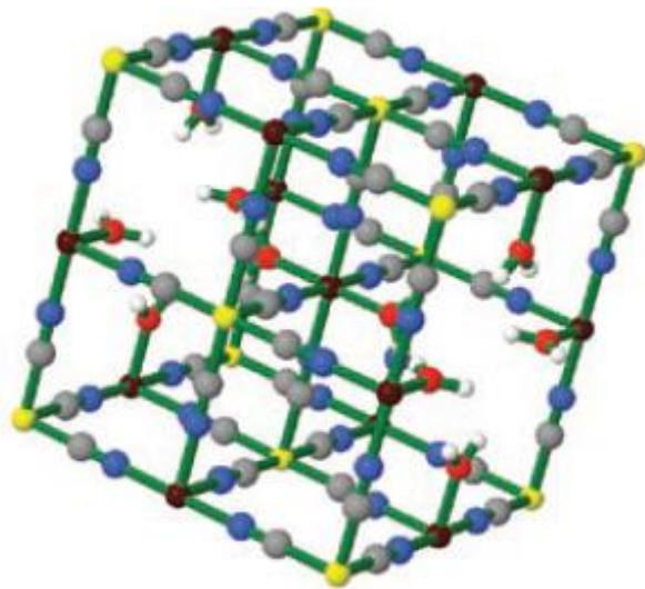
Slika M5. Prikaz jediničnećelije kristalne strukture netopljivog berlinskog modrila sa šupljinom (pričuvane vrste:  $\text{Fe}^{\text{II}}$  (žuto),  $\text{Fe}^{\text{III}}$  (smeđe), C (sivo), N (plavo), O (crveno), H (bijelo))<sup>18</sup>
