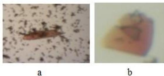
Slika 40. Kristali a)  $[\text{Co(idaa)}_2]\text{I}_3\text{I}$ , b)  $[\text{Ni(idaa)}_2]\text{I}_3\text{I}$
