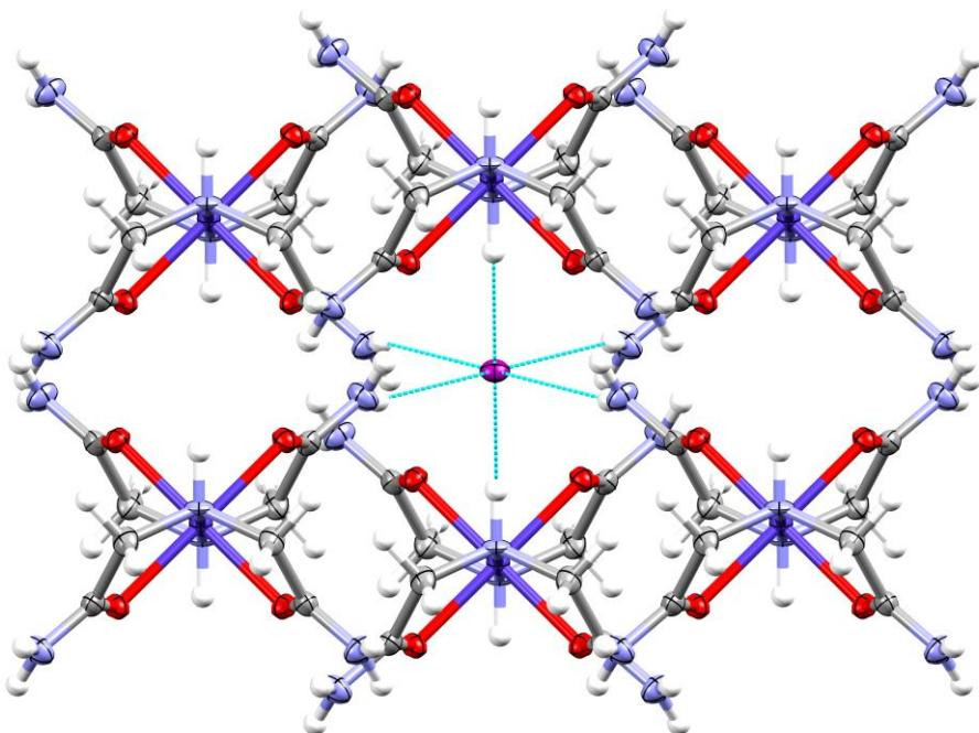
Slika 52. Prikaz oktaedarskog okruženja jodida iz spoja  $[\text{Co}(\text{idaa})_2]\text{I}_3\text{I}$  (za izradu crteža upotrebljen je program *Mercury 3.8.*)<sup>16</sup>
