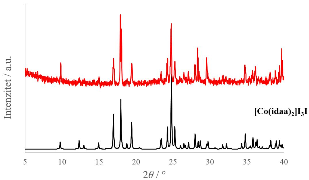
Slika D7. Usporedba rendgenskog difraktograma snimljenog polikristalnog uzorka  $[\text{Co}(\text{idaa})_2]\text{I}_3\text{I}$  (crveno) s izračunatim difraktogramom riješene strukture jediničnog kristala (crno)
