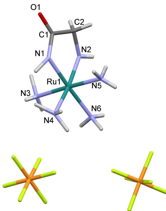
Slika 16. Kristalna struktura [Ru(Glyam)(NH<sub>3</sub>)<sub>4</sub>](PF<sub>6</sub>)<sub>2</sub> (*refcode*: DOXDID) (za izradu crteža upotrebljen je program *Mercury 3.8.*)<sup>16</sup>
