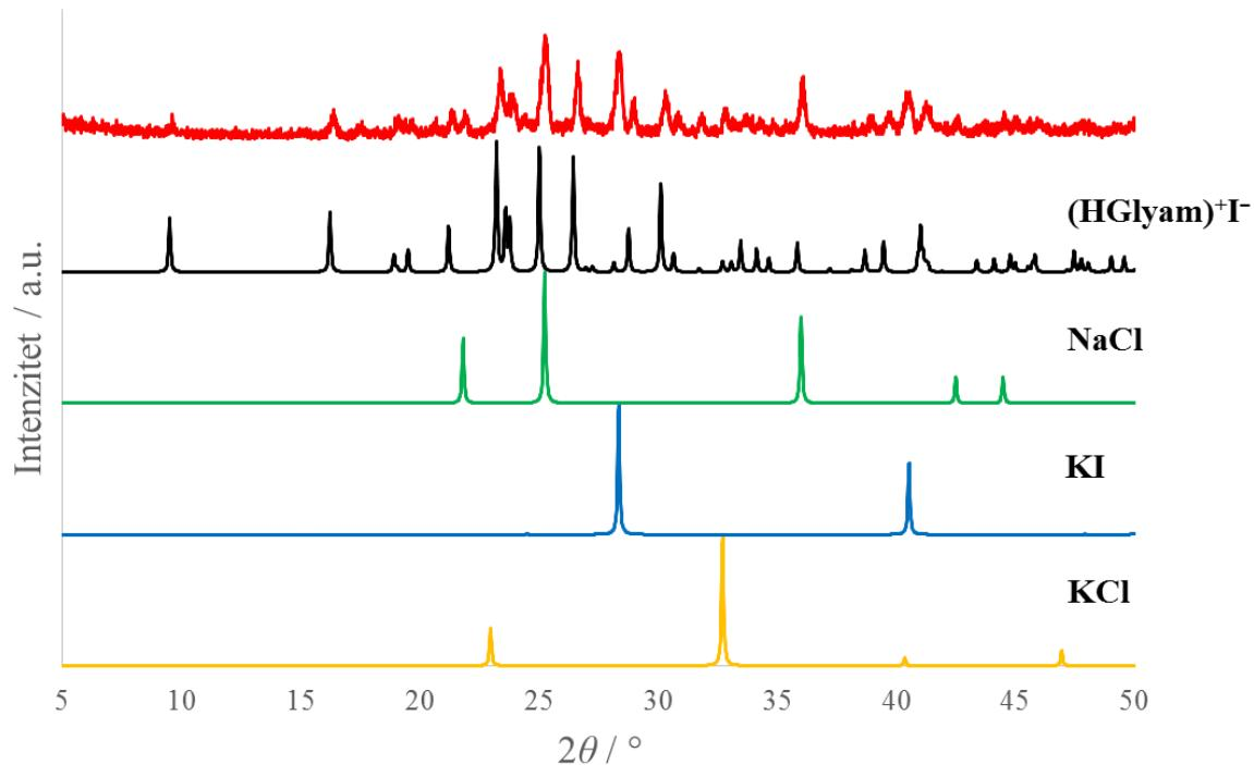
Slika D1. Usporedba snimljenog (crveno) te izračunatog (crno) rendgenskog difraktograma praha (Hidaa)<sup>+</sup>I<sup>-</sup> s difraktogramima NaCl, KI i KCl
