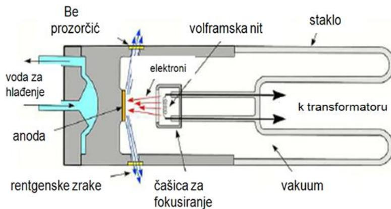
Slika 34. Shematski prikaz rendgenske cijevi<sup>19</sup>
