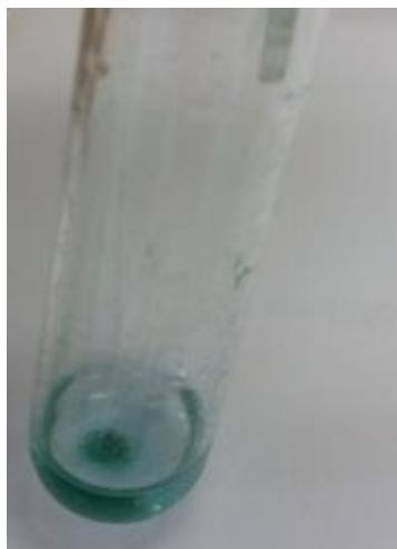
Slika M10. Uočeni zeleni talog nakon dugotrajnog uvođenja cijanovodika
