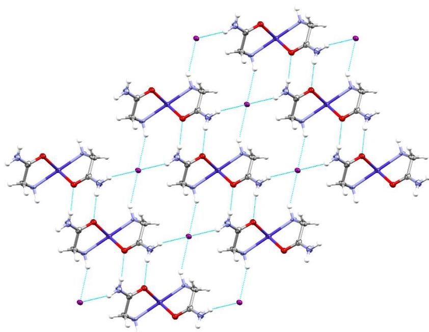
Slika 51. Vodikove veze spoja  $[\text{Co}(\text{idaa})_2]\text{I}_3\text{I}$  u ravnini (010) (za izradu crteža upotrebljen je program *Mercury 3.8.*)<sup>16</sup>
