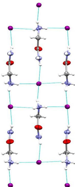
Slika 43. Prikaz pakiranja  $(\text{HGlyam})^+\text{I}^-$  duž ravnine (010) (za izradu crteža upotrebljen je program *Mercury 3.8.*)<sup>16</sup>
