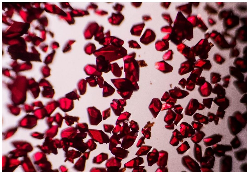
Slika 19. Mikrofotografija jediničnih kristala spoja [\text{CoC}_2\text{O}_4(\text{NH}_3)_4][\text{Fe}(\text{C}_2\text{O}_4)_2(\text{OH}_2)_2] \cdot 2\text{H}_2\text{O} , poliedarske morfologije (10x uvećanje).
