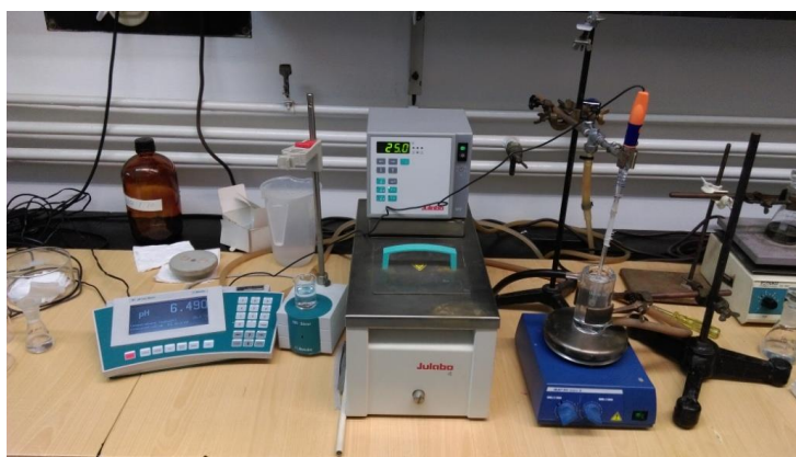
Slika 15. Aparatura za pripremu taložnih sustava i potencijometrijsko praćenje napredovanja reakcije.
