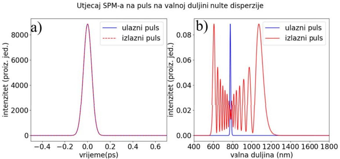
Slika 3.10: Ulagni i izlagni oblik pulsa (a) i odgovarajući spektri (b) pri propagaciji pulsa kroz 10 cm nelinearnog optičkog vlakna. Puls se ne mjenja pri propagaciji. Pod utjecajem SPM-a dolazi do oscilacija u spektru. Ulagni spektar je skaliran zbog preglednosti. U frekventnoj skali širenje spektra na Slici 3.10b) je simetrično.
