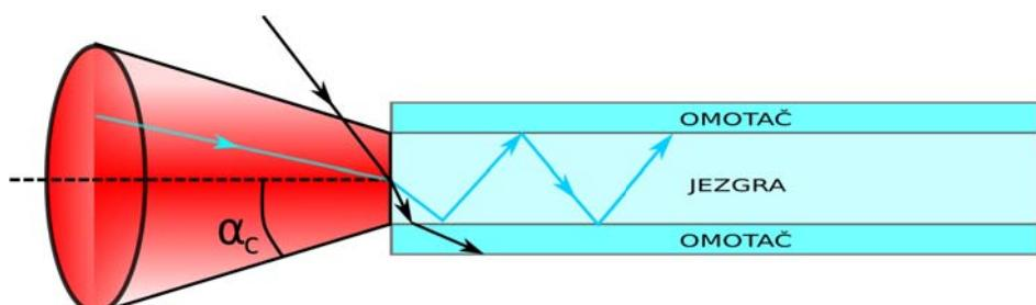
Slika 4.3: Prikaz upadanja svjetlosti na optičko vlakno. Zrake koje na jezgru optičkog vlakna upadaju pod kutem manjim ili jednakim  $\alpha_c$  (svjetloplava strelica) će se uspešno propagirati kroz vlakno, dok će zrake s kutem većim od kritičnog biti transmitirane u okolni omotač i apsorbirane.
