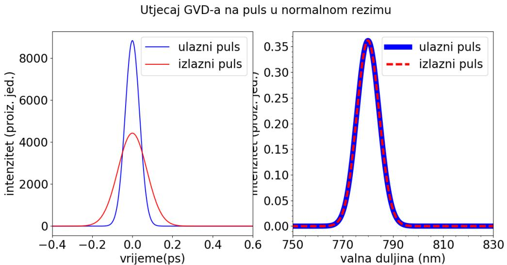
Slika 3.7: Prikaz pulsa na ulazu i izlazu iz optičkog vlakna. Ulagani puls ima gaussov profil. Puls se vremenski proširi propagacijom kroz vlakno, no zadržava gaussov profil, jasno vidljivo na Slici 3.7a. Spektar pulsa ostaje nepromjenjen.
