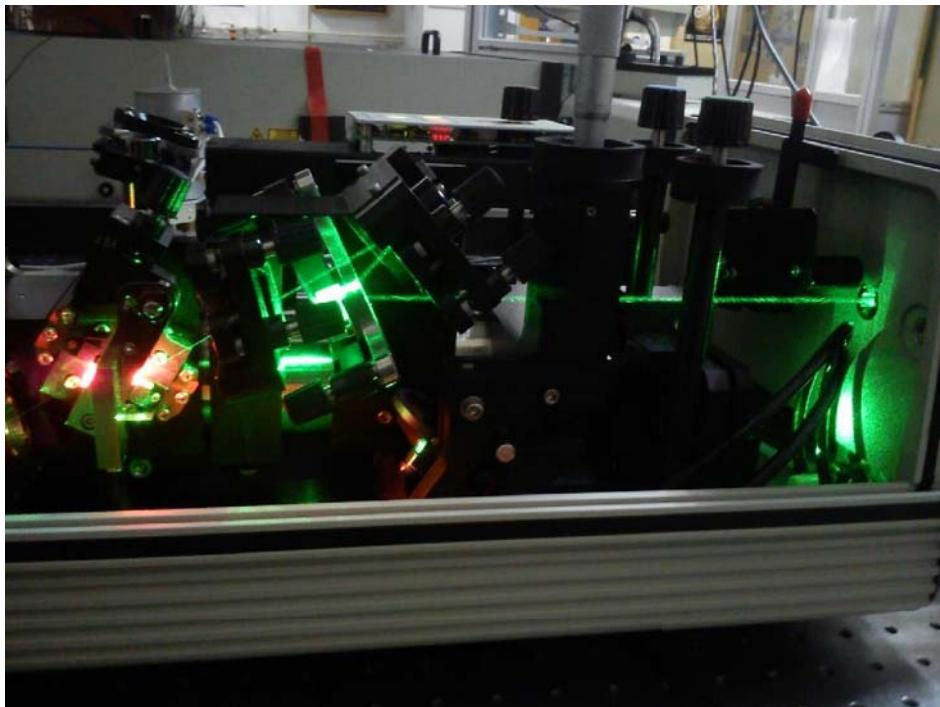
Slika 4.2: TSUNAMI Ti:Safir femtosekundni laser tvrtke Spectra-Physics.
