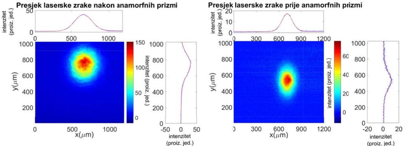
Slika 4.4: Presjek laserske zrake prije i nakon sustava dviju anamorfnih prizmi.
