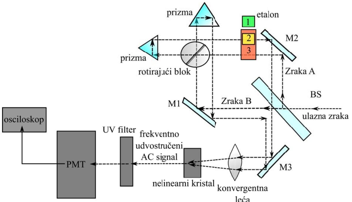
Slika 4.6: Shema autokorelatora. Oznake: BS- djelitelj zrake;  $M_i$ -zrcalo; PMT- fotomultiplikator. Etalon za kalibraciju vremenske skale stvara konstatno vremensko kašnjenje između dviju zraka i ima tri moguće pozicije (1. zeleno, 2. žuto, 3. crveno). Ovisno o položaju etalon stvara kašnjenje između zraka od 0 fs (1. položaj), 311 fs (2. položaj) ili 622 fs (3. položaj).
