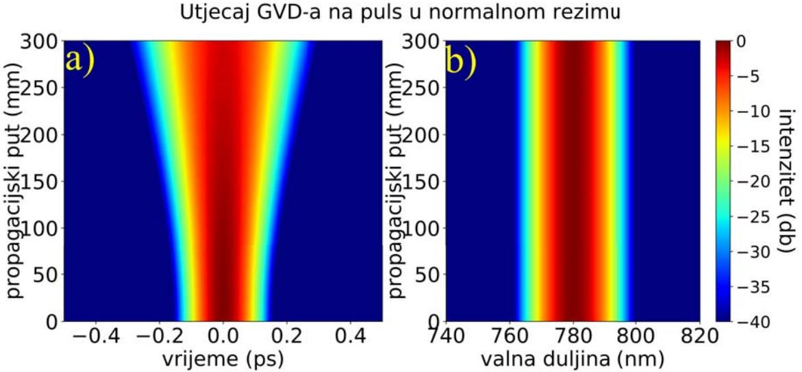
Slika 3.6: Puls u vremenskoj (a) i spektralnoj (b) domeni prilikom propagacije kroz vlakno. Puls se širi u vremenu, no ne dolazi do promjena u spektru. Parametri optičkog vlakna su:  $\beta_2 = 15 \frac{ps^2}{km}$ ,  $\beta_3 = 0$ ,  $\gamma = 0$ .
