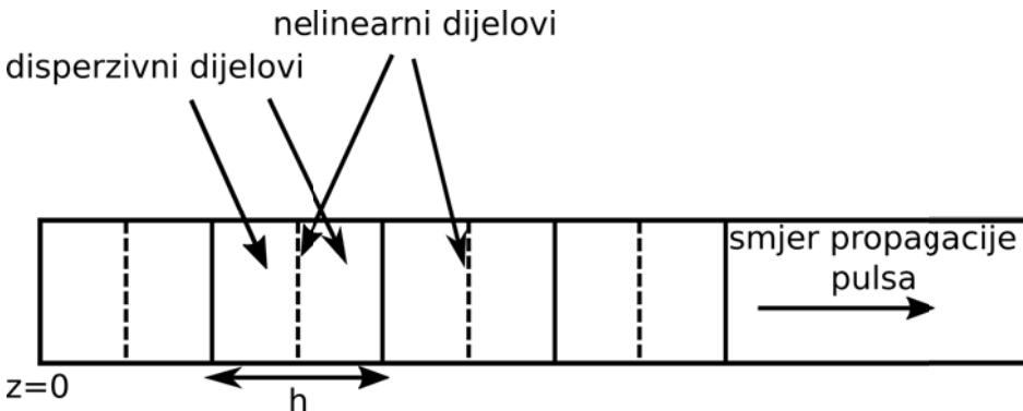
Slika 3.3: Shematski prikaz dvokoračne metode. Optičko vlakno je jednoliko podjeljeno u velik broj dijelova duljine  $h$ . Nelinearnost se nalazi na sredini segmenta. Disperzija i nelinearnice primjenjuju se naizmjenice na puls.
