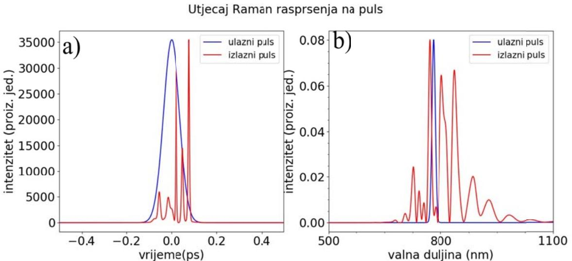
Slika 3.21: Prikaz ulaznog i izlaznog spektra pulsa. Puls se raspada na niz solitonu. Snažno spektralno širenje prema infracrvenom uzrokovano je Raman raspršenjima. Parametri optičkog vlakna:  $\beta_2 = -15 \frac{ps^2}{km}$ ,  $\beta_3 = 0.0 \frac{ps^3}{km}$ ,  $\gamma = 50 \frac{1}{Wkm}$ . Ulagni spektar je skaliran radi preglednosti.
