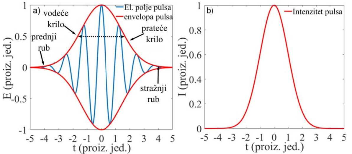
Slika 3.1: Slika 3.1a) Prikaz električnog polja i envelope femtosekundnog pulsa. Frekvencija oscilacija električnog polja jednaka je  $\omega_0$ . Envelopa ima gaussov profil. Trajanje pulsa definirano je sa FWHM envelope, označeno crtkanom linijom. Slika 3.1b) Prikaz intenziteta pulsa u vremenu. Intenzitet pulsa je definiran kao  $I = |A|^2$ .
