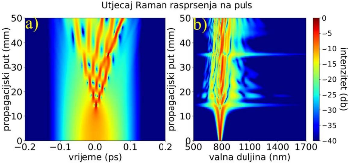
Slika 3.20: Raman raspršenja u anomalnom disperzivnom režimu. Slika a) prikazuje vremensku evoluciju pulsa u anomalnom režimu. Vidljiv je fenomen solitonske fisije pod utjecajem Raman raspršenja. Spektar pulsa dan je na Slici b). Raman pomiče spektar prema višim valnim duljinama te spektar prestaje biti simetričan. Parametri optičkog vlakna:  $\beta_2 = -15 \frac{ps^2}{km}$ ,  $\beta_3 = 0.0 \frac{ps^3}{km}$ ,  $\gamma = 50 \frac{1}{Wkm}$
