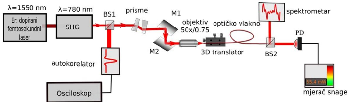
Slika 4.11: Prikaz postava za stvaranje superkontinuuma na Er:dopiranom femtosekundnom fiber laseru. Oznake: BS1/BS2-djelitelji zrake, M1/M2-optička zrcala, PD-fotodioda.
