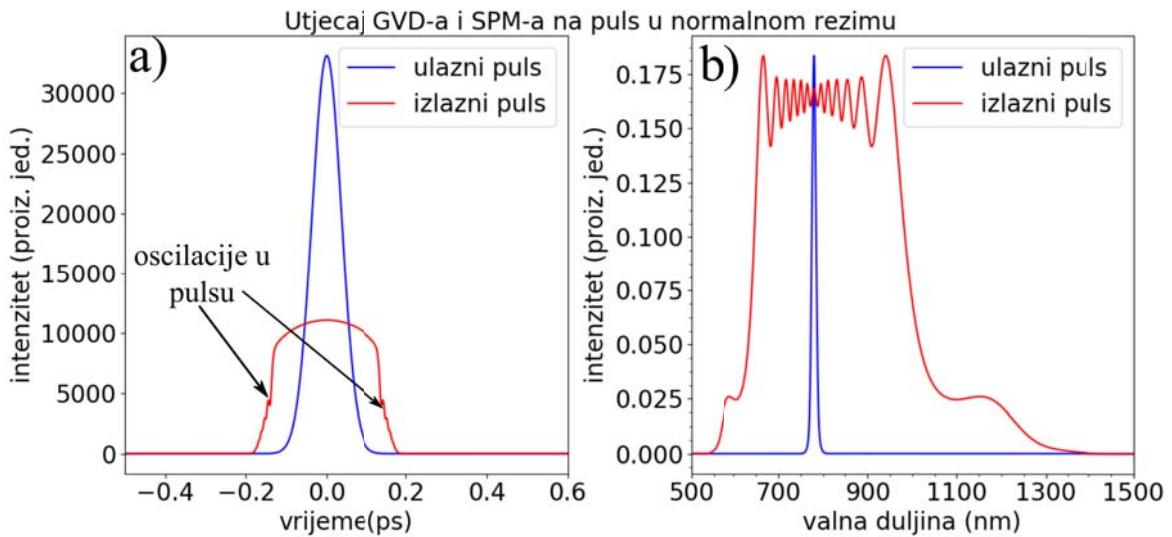
Slika 3.12: Detaljni prikaz vremenske(a) i spektralne(b) domene pulsa pod utjecajem SPMa i GVDa. Oscilacije u krilima pulsa uzrokovane su superpozicijom linearног GVD cvrkuta te nelinearnog SPM cvrkuta. Parametri optičkog vlakna su:  $\beta_2 = 5 \frac{ps^2}{km}$ ,  $\beta_3 = 0$ ,  $\gamma = 50 \frac{1}{W km}$  u točki L=4 cm. Ulazni spektar je skaliran radi preglednosti.
