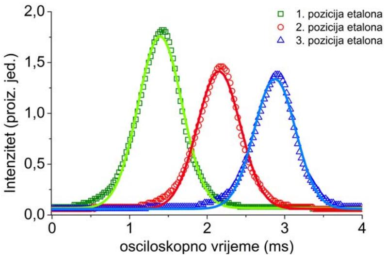
Slika 4.8: Prikaz signalna na autokoreegratoru za 3 položaja etalona sa gaussovim prilagodbama. Položaji centara AC signala odgovaraju kašnjenjima od 0, 311 i 622 femtosekunde u AC vremenu. Za te iste prilagodbe parametri  $t_{osc}$  predstavljaju centre AC signala u osciloskopnom vremenu.
