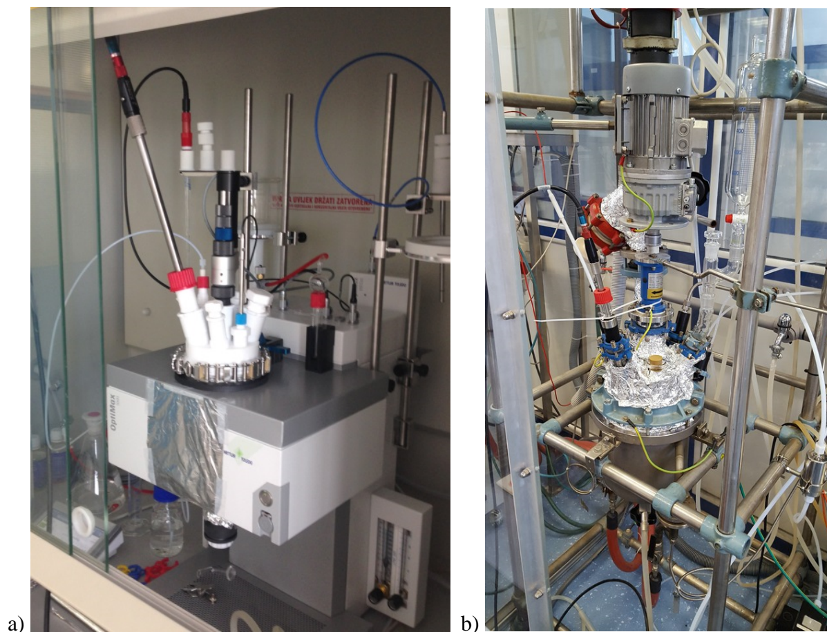
Slika 3.2. Prikaz reaktorskih jedinica korištenih za provođenje reakcija sinteze spoja 2 u mjerilu (a) 1 L (Mettler Toledo Optimax 1001) i (b) 7 L (Büchi).
