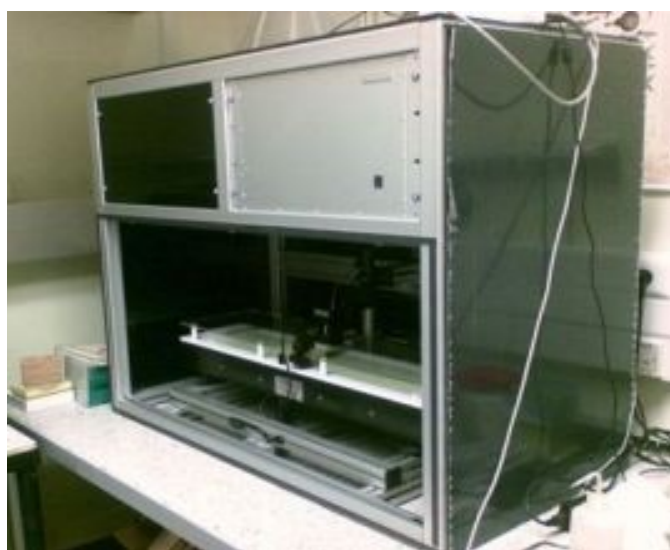
Slika 19. NIMA Langmuir-Blodgett Deposition kada unutar kutije s poklopcem, na antivibracijskom stolu.
