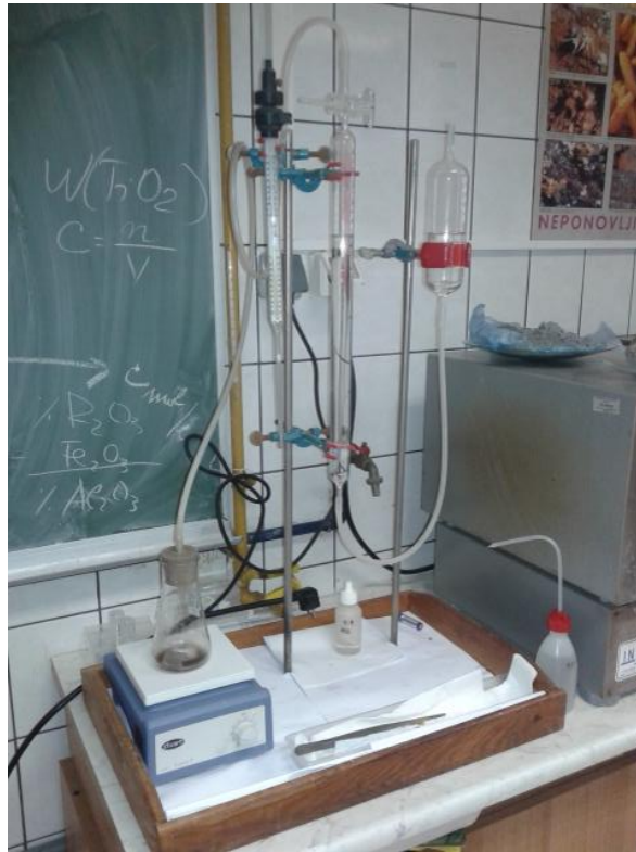
Slika 7. Scheiblerov kalcimetar za određivanje sadržaja karbonata u tlu (Geološki odsjek PMF-a)
