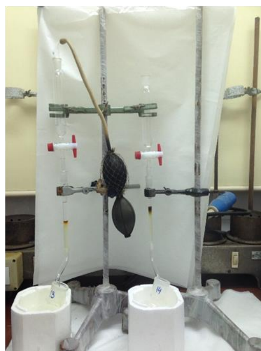
Slika 11. Slika uparavanja do suha u struji dušika i slika pročišćavanja uzoraka kroz kolonu silikagela
