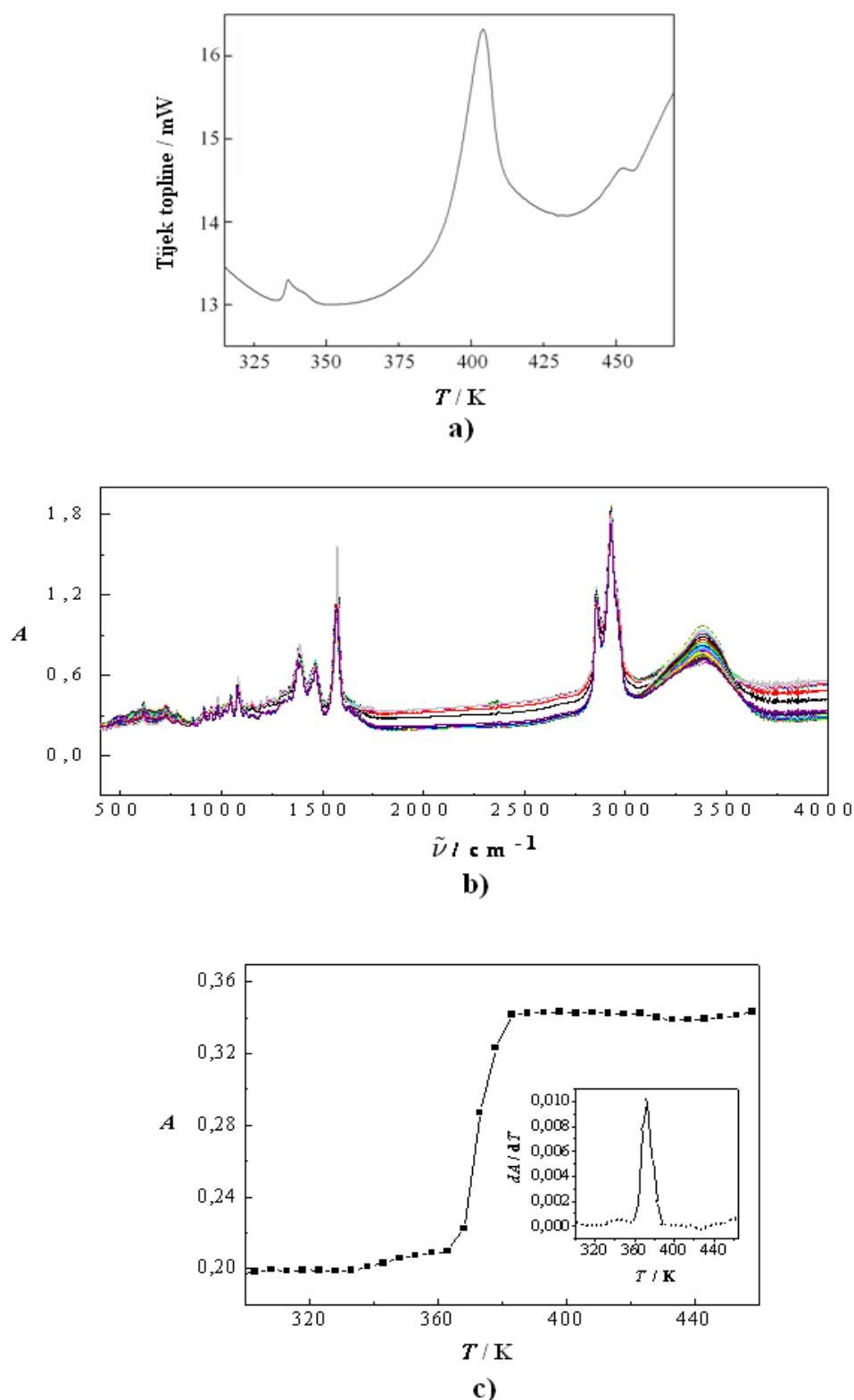
**Slika 90.** a) DSC krivulja; b) IR spektri u temperaturnom području 298 – 468 K; c) temperaturna ovisnost apsorbancije bazne linije (prije korekcije) na  $2000 \text{ cm}^{-1}$  katanionske PAT Tetramer–Ch. Umetak prikazuje prvu derivaciju bazne linije za određivanje temperatura faznih prijelaza.<sup>285</sup>
