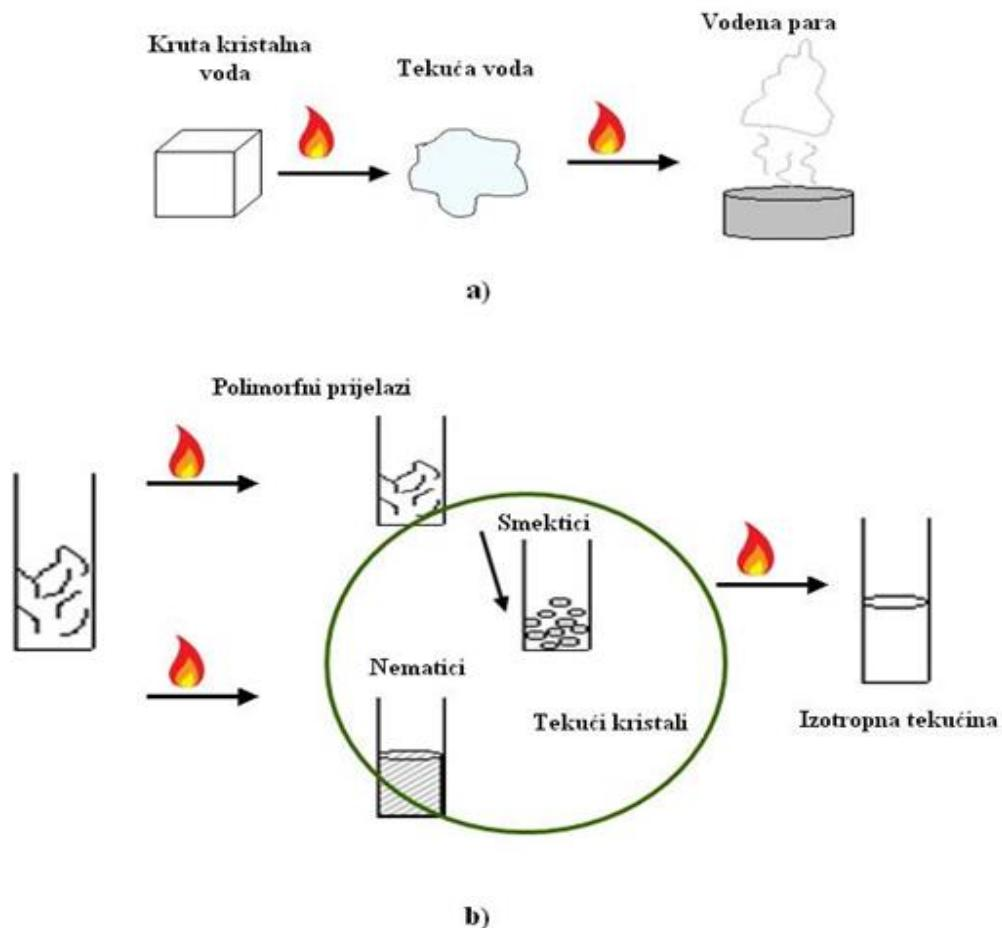
**Slika 46.** Za razliku od **a)** vode koja grijanjem prolazi kroz taljenje i isparavanje, te **b)** tipičnih organskih tvari kod kojih grijanjem nastupa prijelaz taljenjem iz kristalnog stanja u izotropnu tekućinu, PAT prolaze kroz jednu ili više termotropnih mezofaza (zaokruženo na slici **b**).
