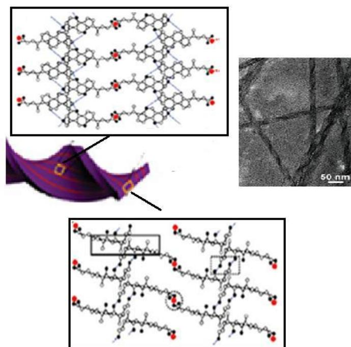
**Slika 35.** Shema strukture unutar nanospirale kalcijevog kolata sa TEM mikrografijom nanospirale.<sup>44</sup>
