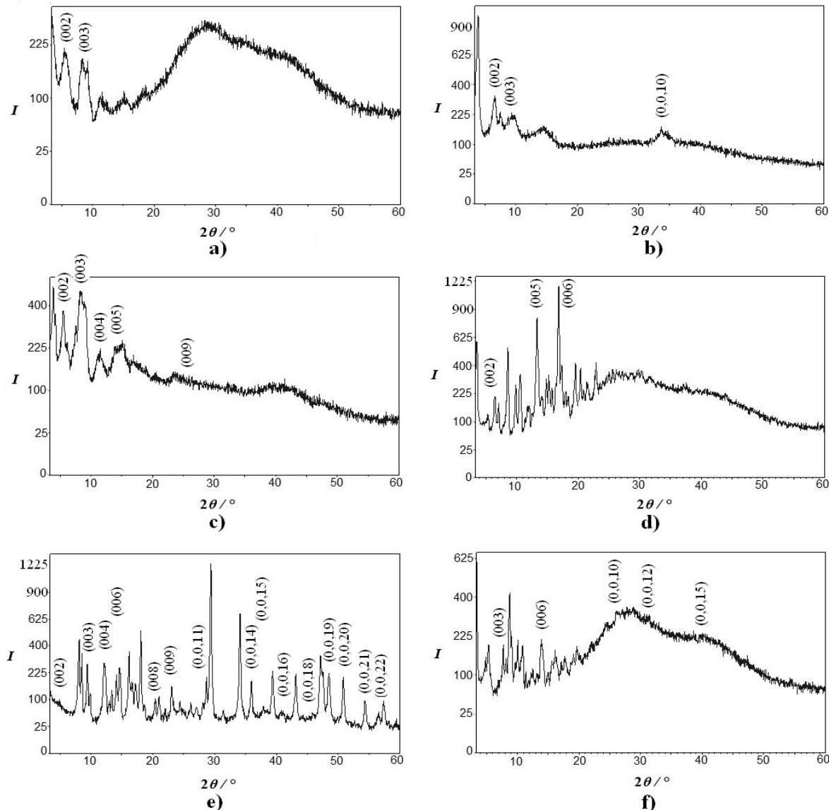
**Slika 109.** Difraktogrami RT faza metaloamfifila s označenim  $00l$  indeksima: a)  $\text{Ag}-\text{Ch}^G$ ; b)  $\text{Ag}-\text{Ch}^N$ ; c)  $\text{Ba}-\text{Ch}^G$ ; d)  $\text{Ca}-\text{Ch}^G$ ; e)  $\text{Ca}-\text{Ch}^N$ ; f)  $\text{La}-\text{Ch}^G$ .
