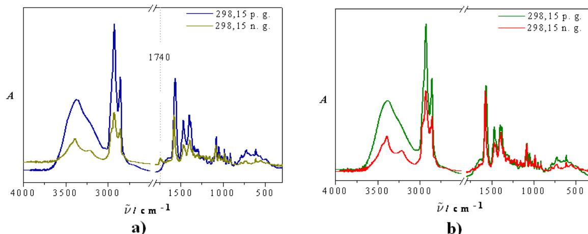
**Slika 93.** IR spektri katanionskih PAT **a)** Trimer–Ch i **b)** Tetramer–Ch, snimljeni prije (p.g.) i nakon (n.g.) termičkog tretmana.<sup>285</sup>
