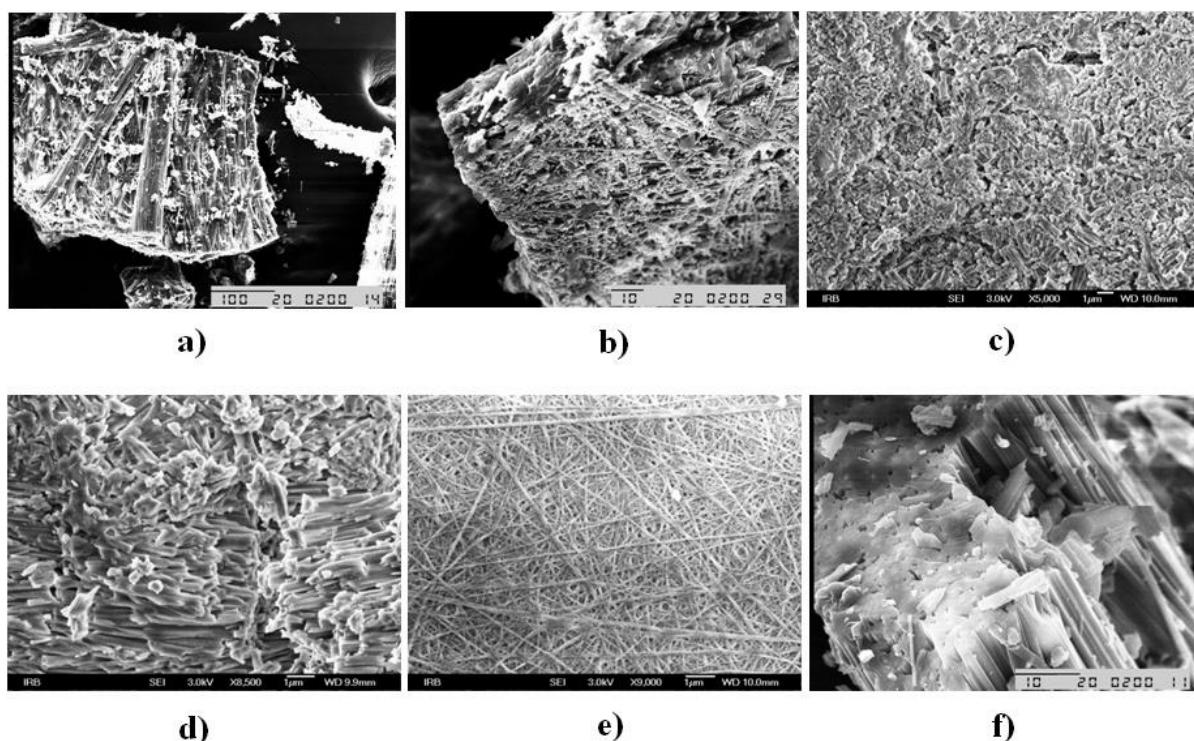
**Slika 105.** SEM mikrografije uzoraka: a) i b)  $\text{Ba}-\text{Ch}^{\text{G}}$ ; c) i d)  $\text{Ca}-\text{Ch}^{\text{G}}$ ; e)  $\text{La}-\text{Ch}^{\text{G}}$ ; f)  $\text{Ag}-\text{Ch}^{\text{N}}$ . Povećanja su označena na pojedinoj mikrografiji.
