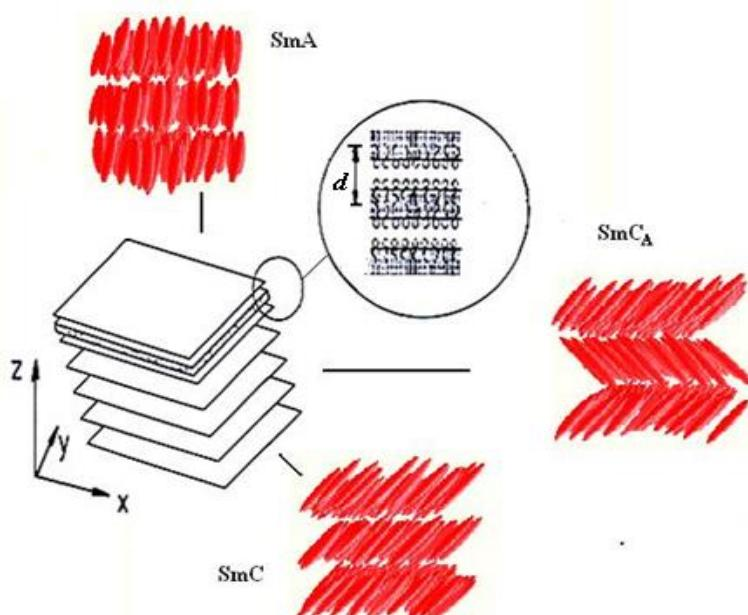
**Slika 56.** Shematski prikaz periodičkog ponavljanja strukture, s označenom debljinom dvosloja  $d$ , koja se u difraktogramima očitava kao difrakcijski maksimum 001.
