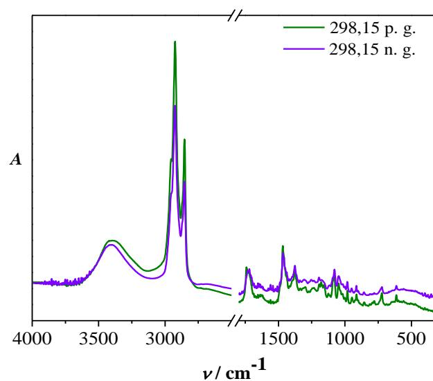
**Slika 84.** IR spektar TDMA–Ch snimljen prije (p.g.) i nakon (n.g.) termičkog tretmana.<sup>285</sup>
