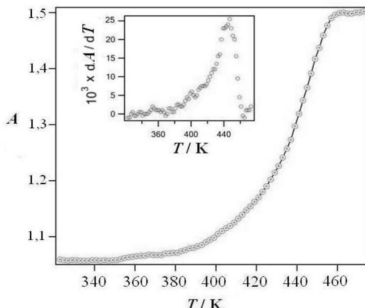
**Slika 126.** Temperaturna ovisnost apsorbancije bazne linije (prije korekcije) na  $2500\text{ cm}^{-1}$  za kompleks 18C6-NaCh. Umetak prikazuje prvu derivaciju apsorbancije bazne linije za određivanje temperatura faznih prijelaza.<sup>328</sup>
