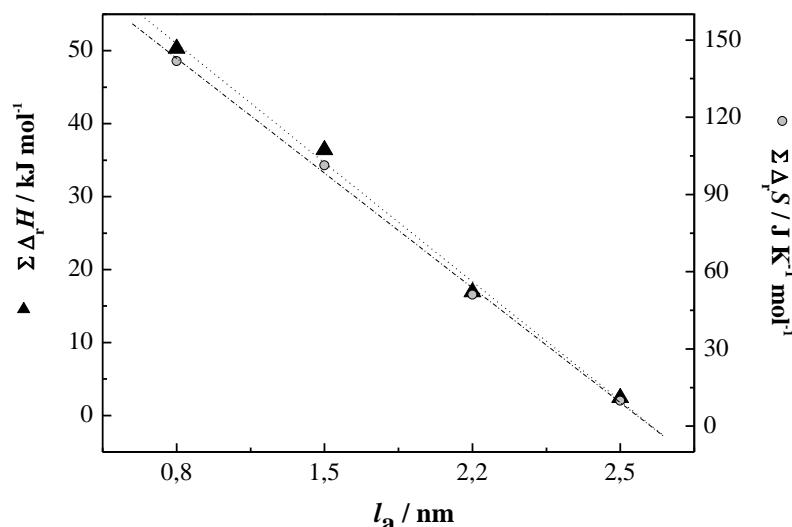
**Slika 151.** Grafički prikaz ovisnosti ukupne promjene reakcijske entalpije ( $\Sigma\Delta_rH$ , puni trokut), i ukupne promjene reakcijske entropije ( $\Sigma\Delta_rS$ , puni krug) faznih prijelaza pojedinog kompleksa, o duljini presjeka aniona gosta,  $l_a$ .
