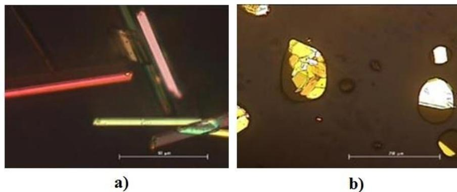
**Slika 147.** Mikrografije tekstura 18C6·KP, snimljene uz polarizirano svjetlo: **a)** RT; **b)** 473 K. Oznaka predstavlja veličinu objekta od 250 µm (b) i 50 µm (a).<sup>295</sup>
