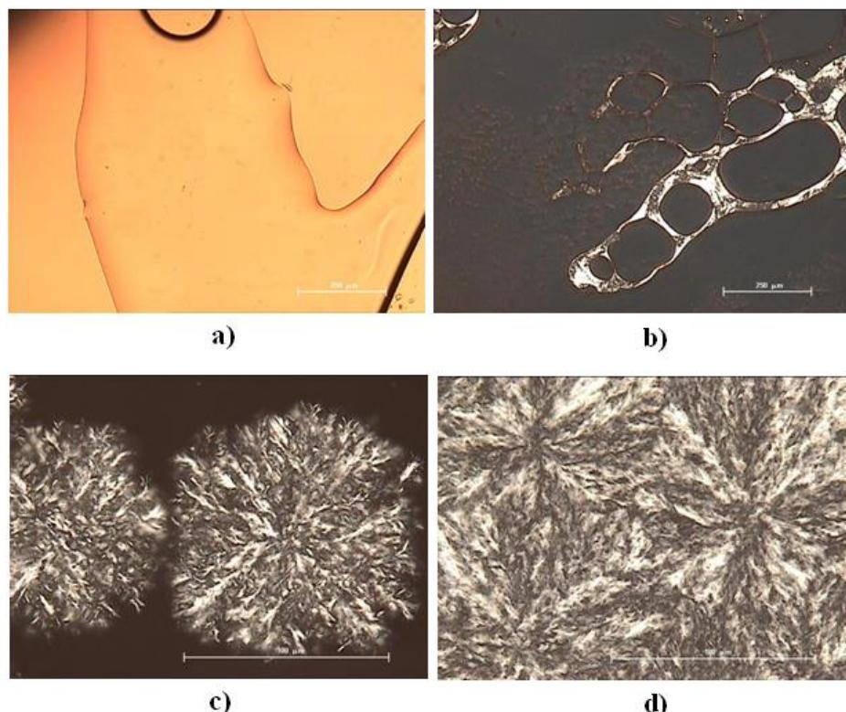
**Slika 81.** Mikrografije karakterističnih tekstura katanionske PAT TDMA–Ch, snimljene optičkim mikroskopom uz polarizirano svjetlo tijekom termičkog tretmana: a) RT; b) 330 K; c) par sati nakon hlađenja na RT i d) idući dan. Oznaka predstavlja veličinu objekta od 250  $\mu\text{m}$  (a i b) i 100  $\mu\text{m}$  (c i d).
