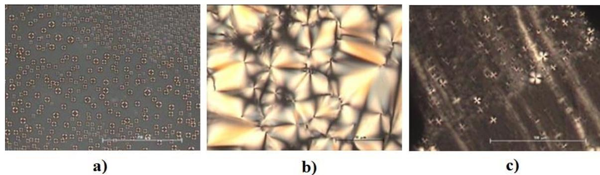
**Slika 141.** Mikrografije karakterističnih tekstura kompleksa 18C6·NaDBS, snimljene optičkim mikroskopom uz polarizirano svjetlo: **a)** 310 K; **b)** i **c)** 243 K. Oznaka predstavlja veličinu objekta od 250  $\mu\text{m}$  (**a**) 100  $\mu\text{m}$  (**b**) i 50  $\mu\text{m}$  (**c**).<sup>295</sup>
