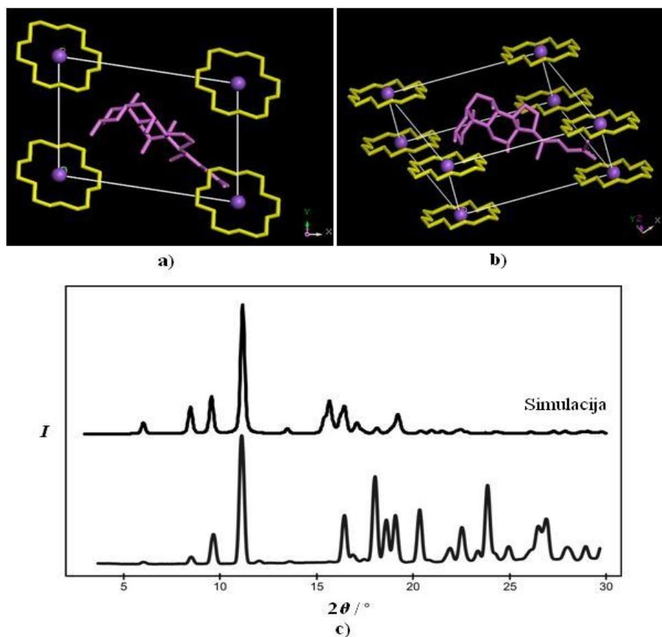
**Slika 123.** Molekulski model RT faze 18C6·NaCh; **a)** projekcija duž  $c$ -osi; **b)** bočni prikaz. Molekule 18C6 prikazane su u žuto, a one NaCh ružičasto. Atomi vodika su izostavljeni zbog jasnijeg prikaza. **c)** Eksperimentalni i simulirani difraktogram RT faze 18C6·NaCh.<sup>328</sup>
