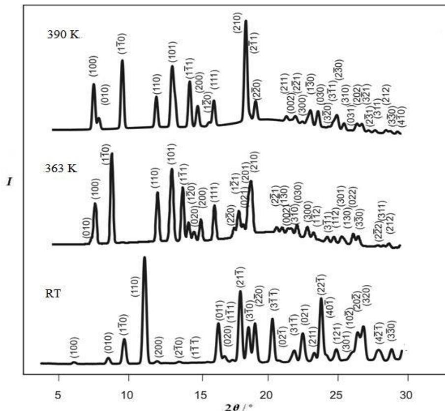
**Slika 129.** Difraktogrami RT i visokotemperurnih faza  $18\text{C}6\text{-NaCh}$ , s indeksiranim difrakcijskim maksimumima.<sup>328</sup>
