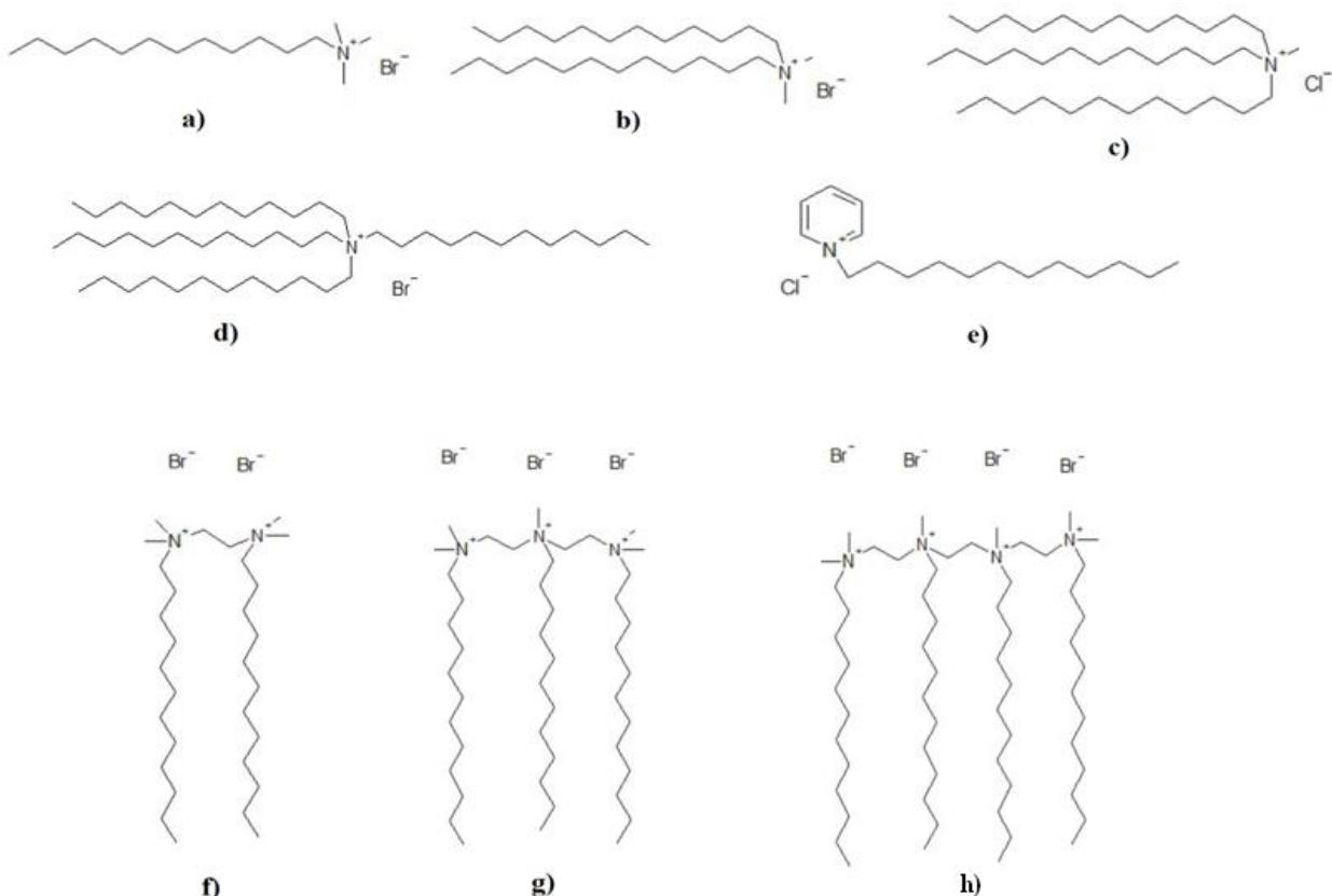
**Shema 3.** Kvaterne amonijeve soli korišene u sintezi spojeva ispitivanih u ovom radu: **a)** dodeciltrimetilamonijev bromid; **b)** didodecildimetilamonijev bromid; **c)** tridodecilmethylammonijev klorid; **d)** tetradodecilmamonijev bromid; **e)** dodecilpiridinijev klorid; te **f)** dimerna; **g)** trimerna, i **h)** tetramerna PAT.
