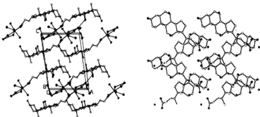
**Slika 111.** Kristalna struktura kalcijevog klorida kolata heptahidrata.<sup>153</sup>
