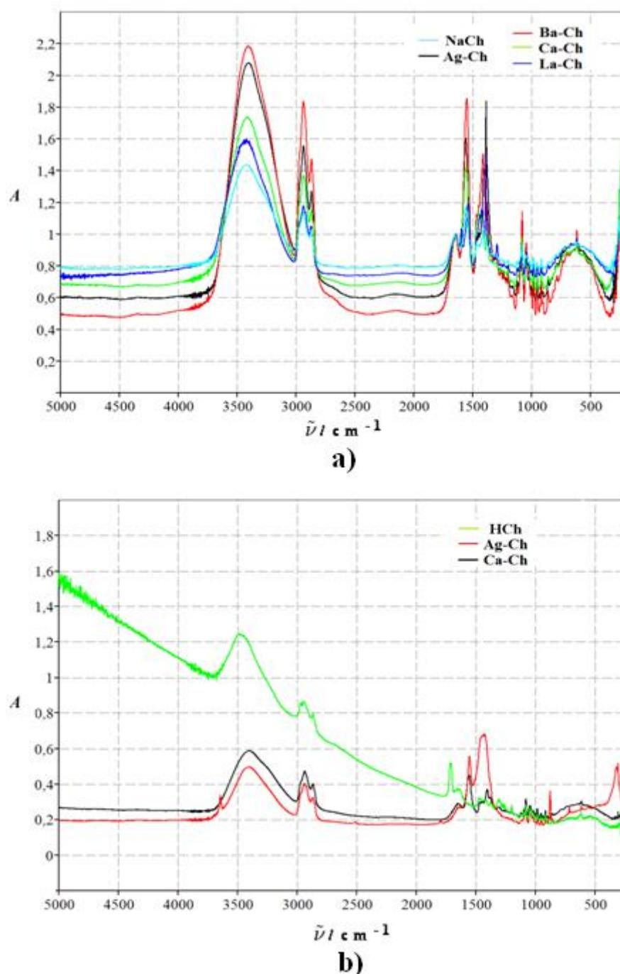
**Slika 108.** IR spektri metaloamfifilnih kompleksa na sobnoj temperaturi: **a)** kompleksi dobiveni međudjelovanjem NaCh i metalnih nitrata ili klorida; **b)** kompleksi dobiveni neutralizacijom metalnih oksida ili hidroksida HCh.
