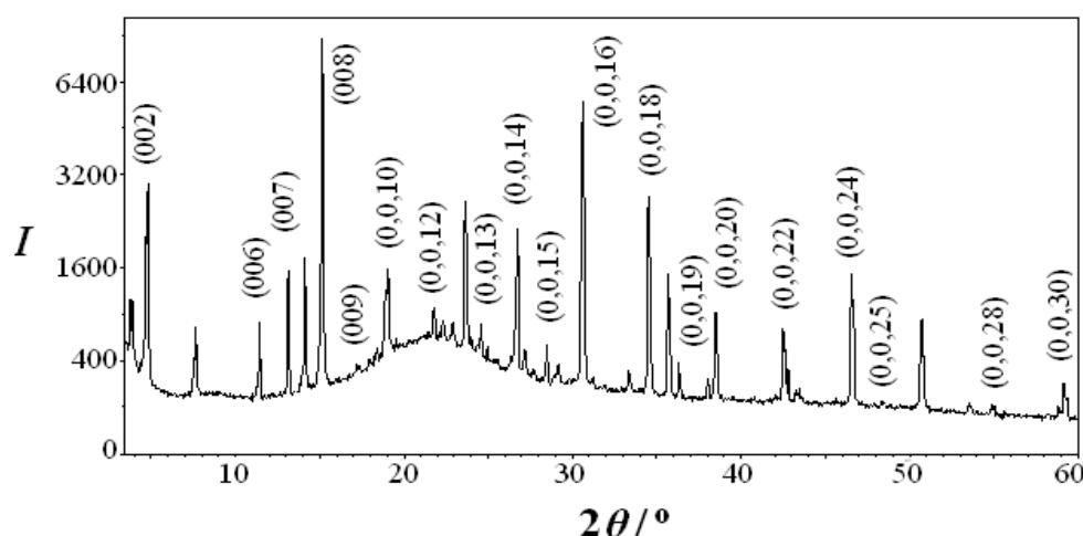
Slika 98. Difraktogram RT faze DPy–P snimljene metodom WAXD.<sup>214</sup>
