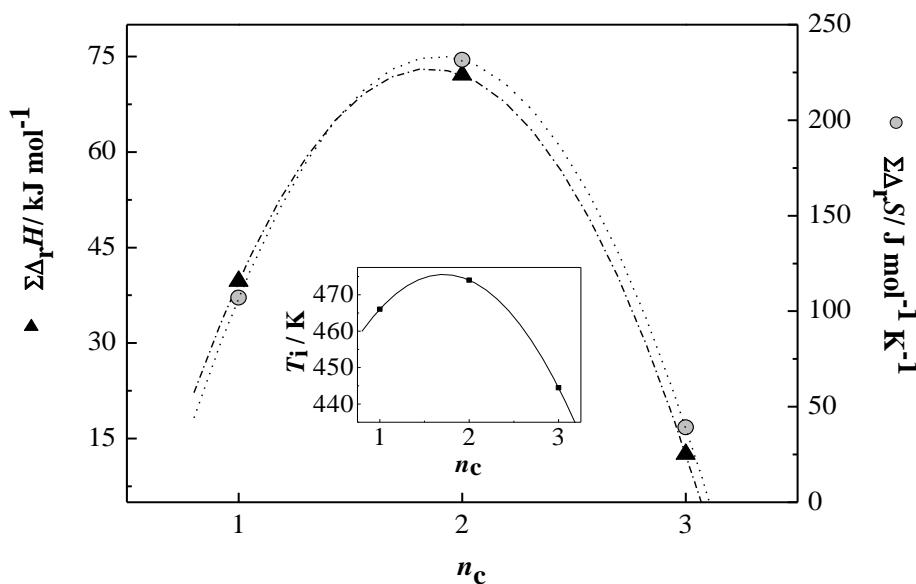
**Slika 102.** Grafički prikaz ovisnosti temperatura izotropizacije ( $T_i$ , umetak), ukupne promjene reakcijske entalpije ( $\Sigma \Delta_r H$ , crni trokut), i ukupne promjene reakcijske entropije ( $\Sigma \Delta_r S$ , sivi krug) faznih prijelaza pojedinog katanionika o broju dodecilnih lanaca na istoj amonijevoj grupi kationske PAT,  $n_c$ .<sup>285</sup>
