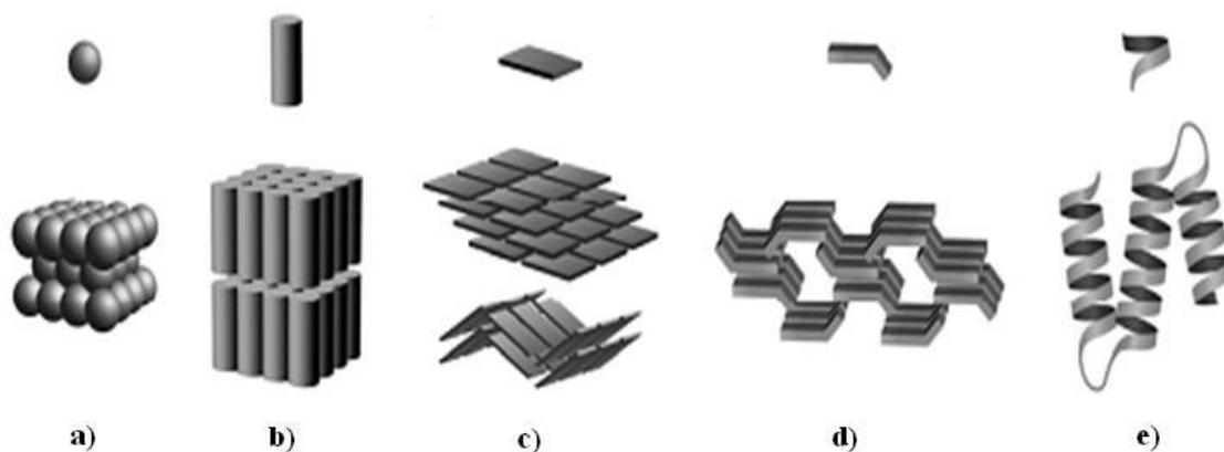
**Slika 31.** Povezanost molekulske i kristalne strukture: **a)** kuglasta; **b)** valjkasta; **c)** plošna; **d)** zasvođena; i **e)** lančana molekula.<sup>137</sup>
