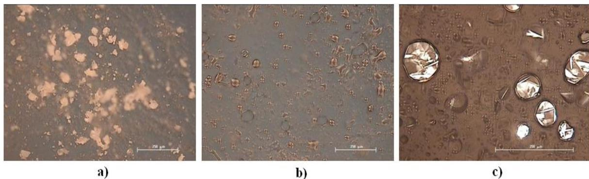
**Slika 79.** Mikrografije karakterističnih tekstura katanionske PAT DDA–Ch, snimljene optičkim mikroskopom uz polarizirano svjetlo tijekom termičkog tretmana: **a)** RT; **b)** 326 K; **c)** 407 K. Oznaka predstavlja veličinu objekta od 250  $\mu\text{m}$ .<sup>285</sup>
