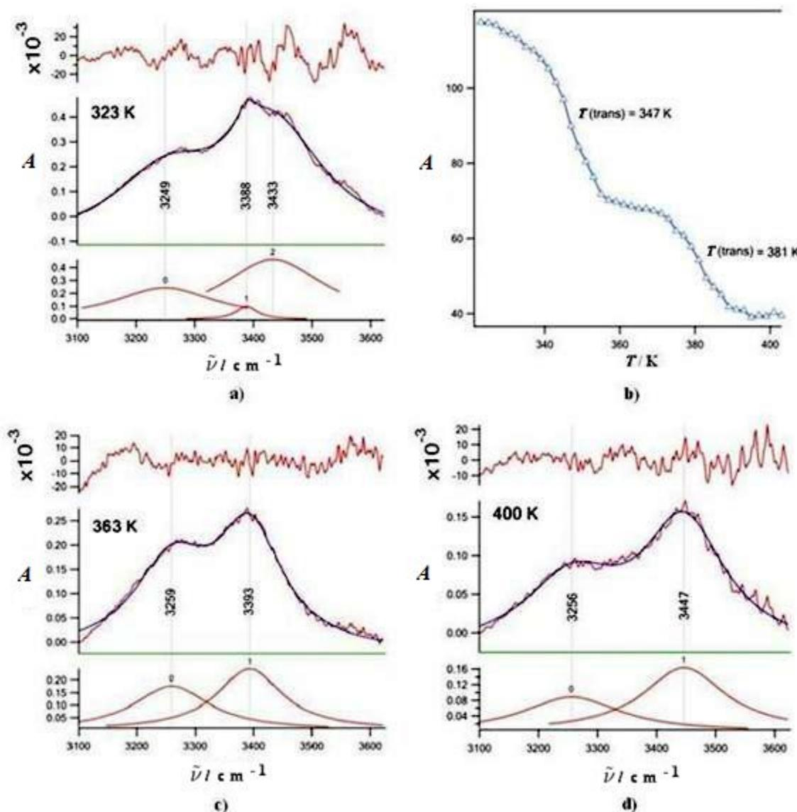
**Slika 127.** IR spektar  $^{18}\text{C}_6\text{-NaCh}$  kompleksa u području snimljen na raznim temperaturama: a) 323 K; b) 363 K; d) 400 K; te c) temperaturna ovisnost apsorbancije vrpcu OH istezanja (površina ispod cijelog područja  $3700 - 3100 \text{ cm}^{-1}$ ).<sup>328</sup>
