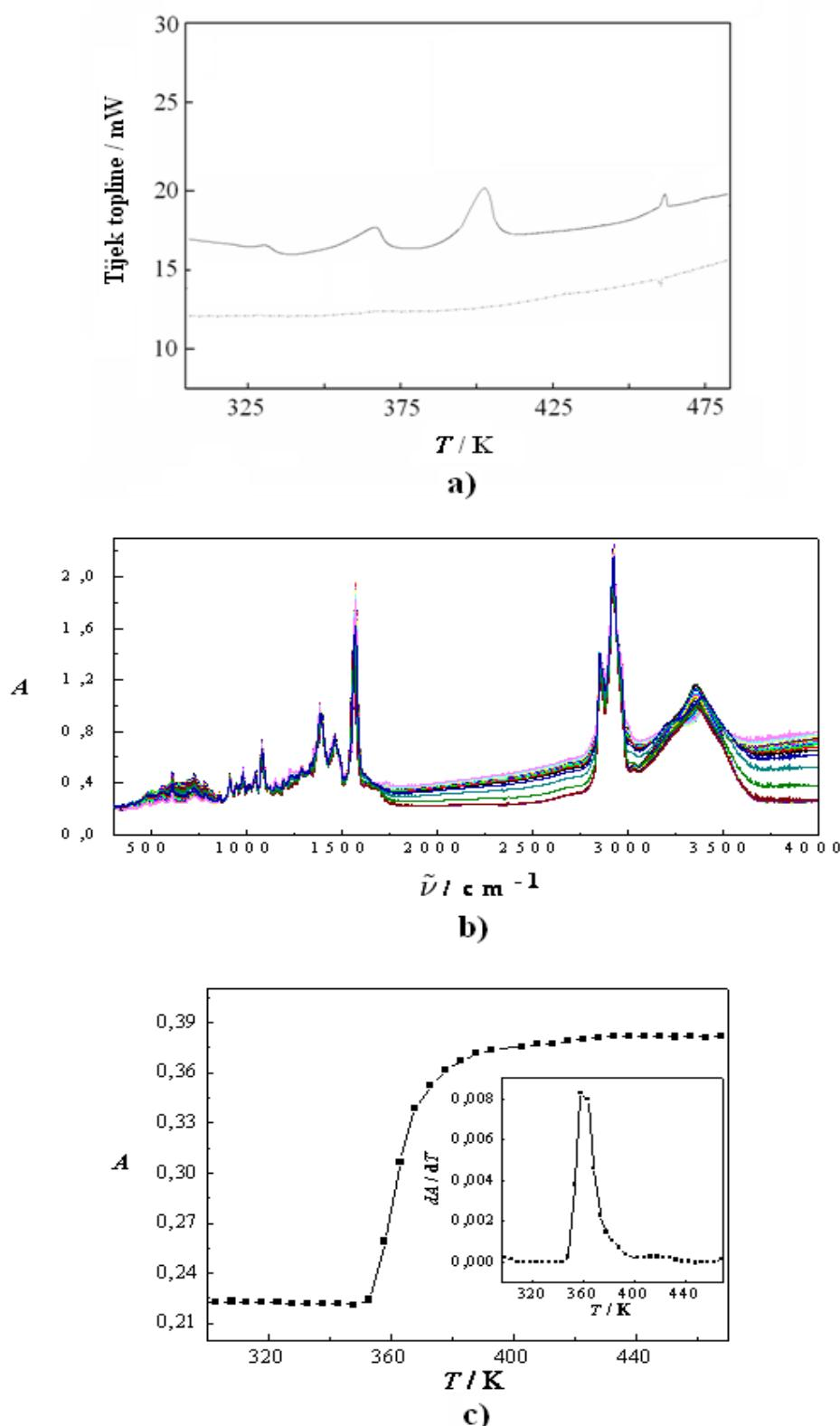
**Slika 74.** a) DSC krivulja; b) IR spektri u temperaturnom području 298 – 468 K (puna linija je ciklus grijanja, a iscrtkana ciklus hlađenja); c) temperaturna ovisnost apsorbancije bazne linije (prije korekcije) na  $2000 \text{ cm}^{-1}$  katanionske PAT DTA–Ch. Umetak prikazuje prvu derivaciju apsorbancije bazne linije za određivanje temperature faznih prijelaza.<sup>285</sup>
