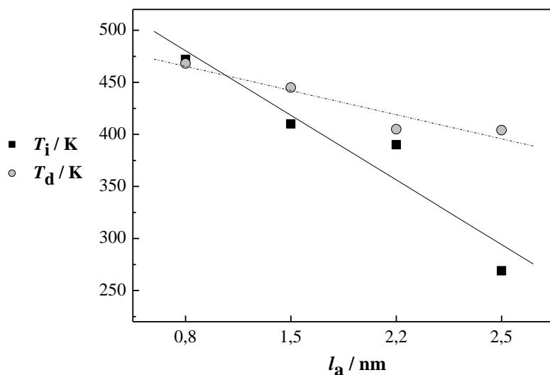
**Slika 150.** Grafički prikaz ovisnosti temperatura izotropizacije ( $T_i$ , puni kvadrat), i temperatura dekompozicije ( $T_d$ , puni krug) o duljini presjeka aniona gosta,  $l_a$ .
