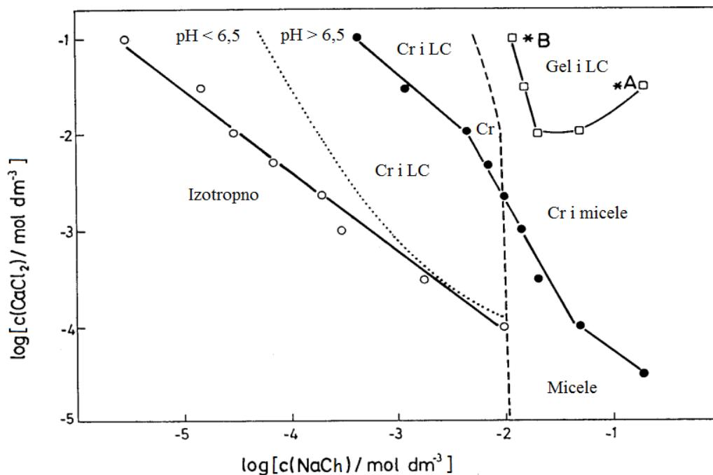
**Slika 114.** Fazni dijagram sustava NaCh – CaCl<sub>2</sub>. Pune linije predstavljaju linije precipitacije i geliranja, točkasta linija dijeli regiju na pH ispod i iznad 6,5, a iscrtkana linija je granica formiranja micela; Cr - kruta kristalna faza, LC - liotropni tekući kristali.<sup>75</sup>
