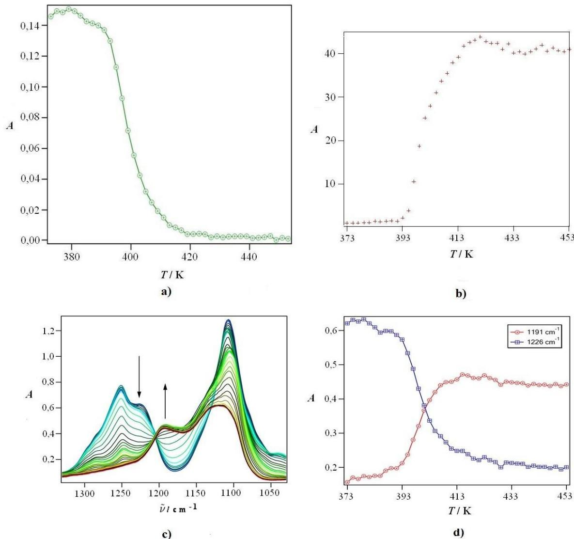
**Slika 140.** Temperaturna ovisnost karakterističnih IR vrpcia za kompleks 18C6·NaDS: **a)** vrpyca 18C6 etera na  $582 \text{ cm}^{-1}$ ; **b)** vrpyca sulfatnog aniona na  $1140 \text{ cm}^{-1}$ . **c)** Temperaturno ovisni infracrveni spektri kompleksa 18C6·NaDS u regiji  $1330 - 1030 \text{ cm}^{-1}$ , s naznačenim promjenama u apsorbanciji tijekom termičkog tretmana. **d)** Paralelni pregled apsorbancija na  $1191$  i  $1226 \text{ cm}^{-1}$  tijekom termičkog tretmana.<sup>295</sup>
