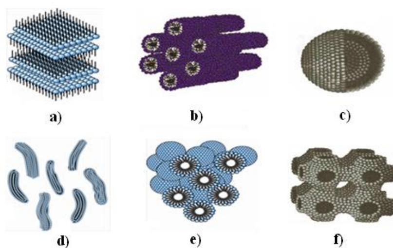
**Slika 50.** Prikaz vrsta liotropnih mezofaza: **a)** ispružena lamelna; **b)** heksagonalna; **c)** sferna lamelna (vezikula); **d)** nematička; **e)** kubična; **f)** bikontinuirana kubična.<sup>206</sup>
