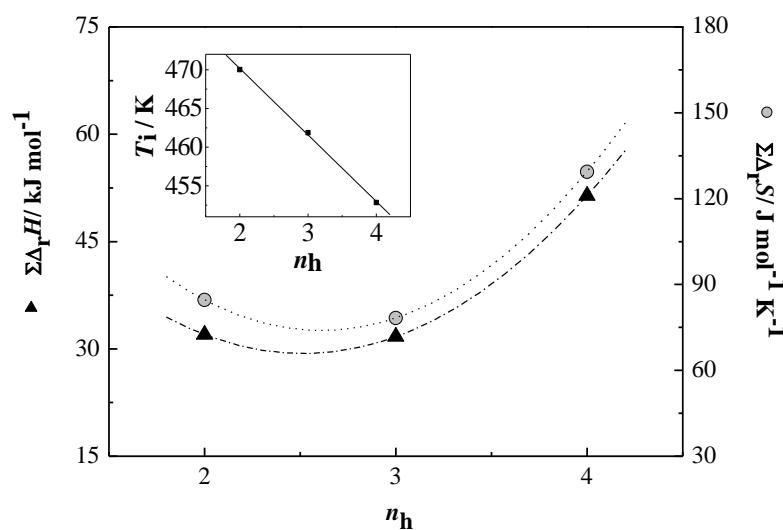
**Slika 103.** Grafički prikaz ovisnosti temperatura izotropizacije ( $T_i$ , umetak), ukupne promjene reakcijske entalpije ( $\Sigma\Delta_r H$ , crni trokut), i ukupne promjene reakcijske entropije ( $\Sigma\Delta_r S$ , sivi krug) faznih prijelaza pojedinog katanionika o broju amonijevih grupa kationske PAT,  $n_h$ .<sup>285</sup>
