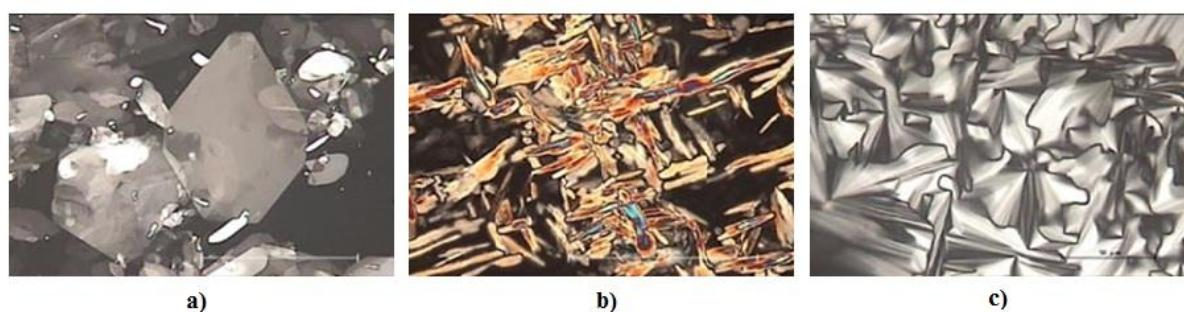
**Slika 133.** Mikrografije karakterističnih tekstura kompleksa 18C6-NaDS, snimljene optičkim mikroskopom u ciklusu grijanja uz polarizirano svjetlo: a) RT; b) 380 K; i hlađenja: c) 265 K. Oznaka predstavlja veličinu objekta od  $250\text{ }\mu\text{m}$  (a i b) i  $100\text{ }\mu\text{m}$  (c).<sup>295</sup>
