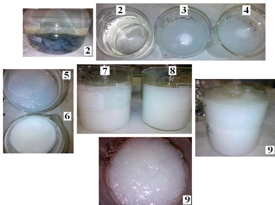
**Slika 115.** Fotografije gelova Ca–Ch<sup>G</sup> 2 – 9, pripremljenih prema tablici 27, a označene prema rednom broju uzorka.
