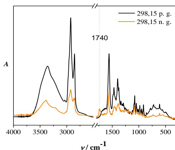
**Slika 78.** IR spektar DTA–Ch snimljen prije (p.g.) i nakon (n.g.) termičkog tretmana.<sup>285</sup>
