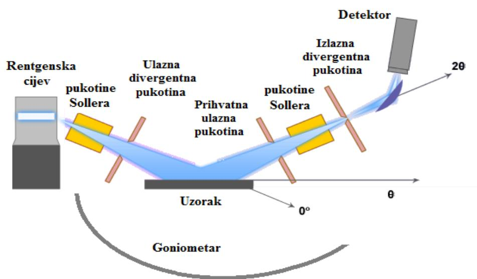
**Slika 66.** Shematski prikaz rentgenskog difraktometra za polikristalne materijale.
