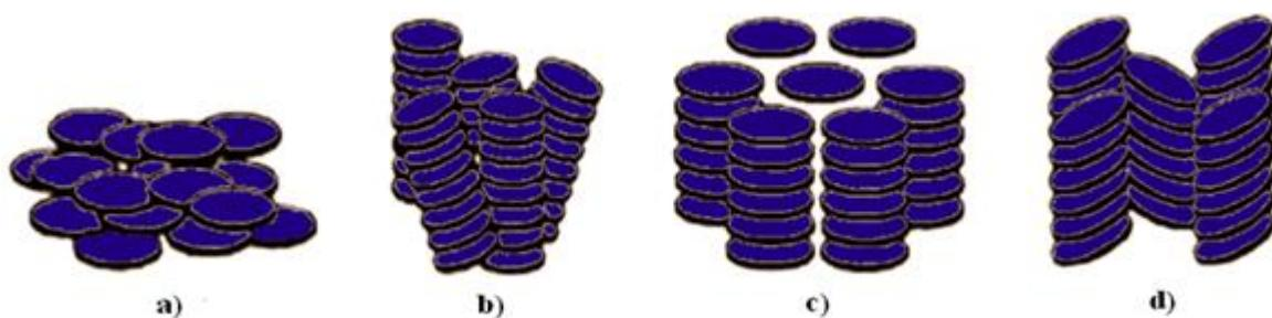
**Slika 55.** Pregled diskotičnih faza: **a)** diskotični nematik; **b)** nematička; **c)** heksagonska; te **d)** pravokutna stupčasta mezofaza.<sup>202</sup>
