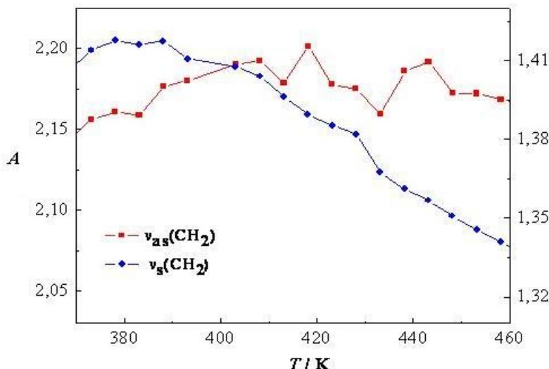
**Slika 77.** Temperaturna ovisnost vrpcu simetričnih i antisimetričnih vibracija  $CH_2$  skupina: crveno,  $\nu_{as}(CH_2)$  i plavo,  $\nu_s(CH_2)$  za temperaturno područje 370 – 460 K.<sup>285</sup>
