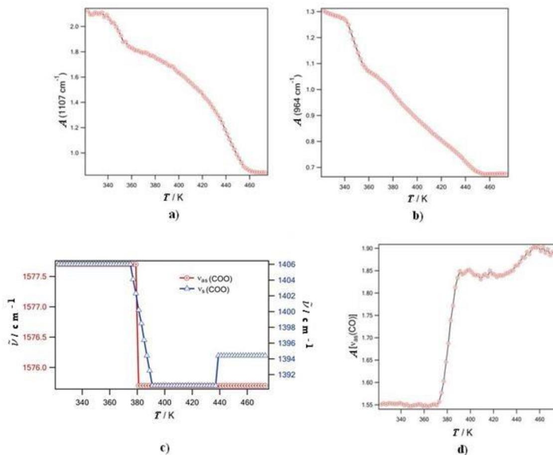
**Slika 128.** Temperaturna ovisnost karakterističnih IR vrpci 18C6 etera kompleksa 18C6·NaCh: **a)** vrpca na  $1107 \text{ cm}^{-1}$ ; **b)**  $964 \text{ cm}^{-1}$ ; **c)** temperaturna ovisnost pozicije maksimuma karakterističnih IR vrpci kolatnog aniona,  $v_s(\text{COO}^-)$  - plavo i  $v_{as}(\text{COO}^-)$  - crveno; **d)** temperaturna ovisnost apsorbancije  $v_{as}(\text{COO}^-)$  vrpce kolatnog aniona.<sup>328</sup>
