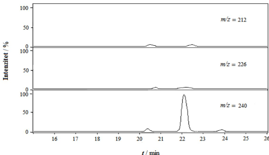
**Slika 57.** HPLC-ESI-MS/MS ionski kromatogrami na vrijednostima  $m/z$ , odabranim za determinaciju alkilbenzensulfonatnih izomera.<sup>120</sup>
