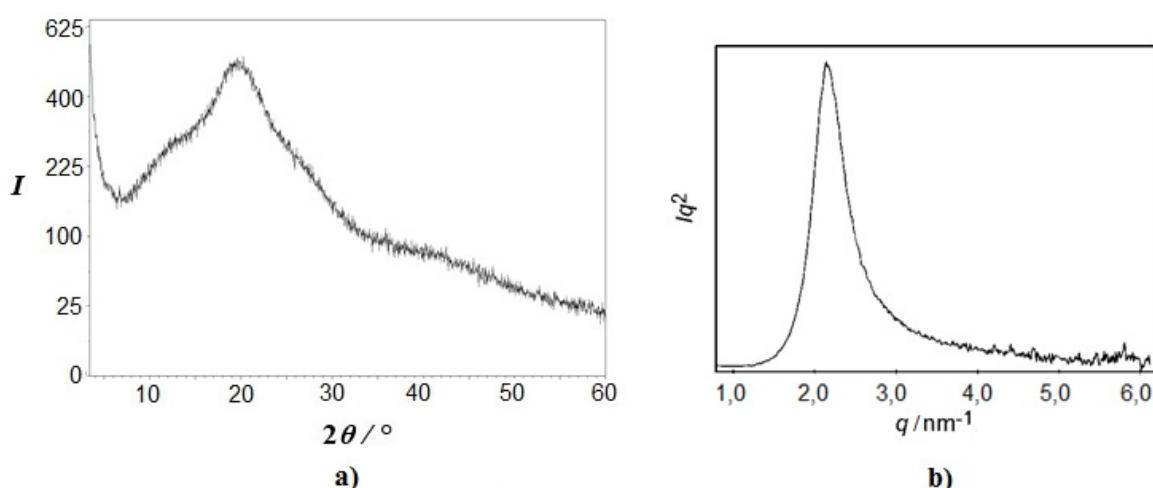
**Slika 143.** Difraktogram kompleksa 18C6-NaDBS: **a)** snimljen na RT metodom WAXD; i **b)** na 253 K metodom SAXD.<sup>295</sup>
