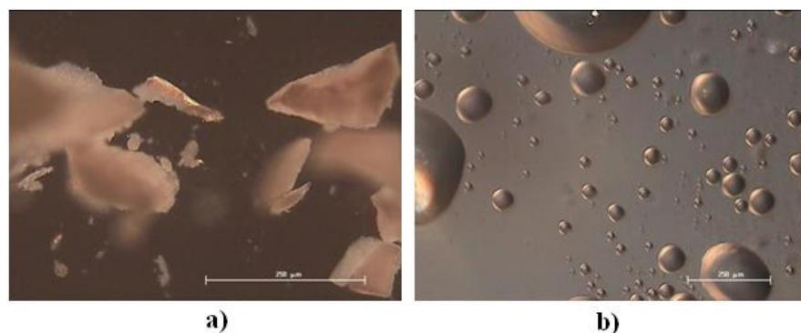
**Slika 85.** Mikrografije karakterističnih tekstura katanionske PAT Dimer–Ch, snimljene optičkim mikroskopom uz polarizirano svjetlo (a) i fazni kontrast (b), tijekom termičkog tretmana: a) RT; b) 425 K. Oznaka predstavlja veličinu objekta od 250 μm.<sup>285</sup>
