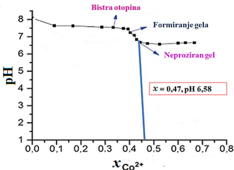
**Slika 26.** Promjena pH sustava s množinskim udjelom titranta, te utjecaj na stabilnost hidrogela titracijom  $2,0 \cdot 10^{-2}$  mol dm $^{-3}$  NaCh s  $4,0 \cdot 10^{-2}$  mol dm $^{-3}$  Co(NO<sub>3</sub>)<sub>2</sub> · 6 H<sub>2</sub>O.<sup>110</sup>
