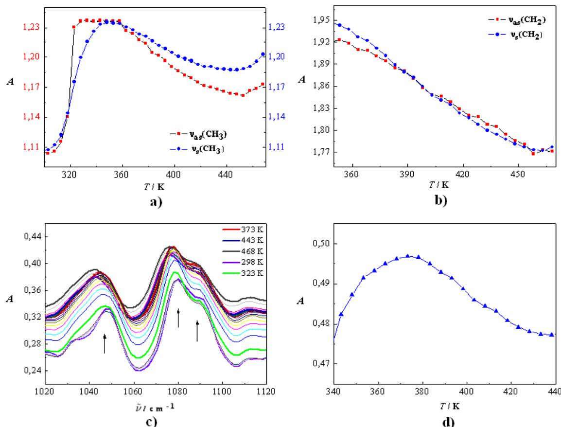
**Slika 83.** Karakteristične IR vrpce katanionske PAT TDMA–Ch: **a)** temperaturna ovisnost vrpci  $v_{as}(\text{CH}_3)$  (crveno) i  $v_s(\text{CH}_3)$  (plavo); **b)** temperaturna ovisnost vrpci  $v_{as}(\text{CH}_2)$  (plavo) i  $v_s(\text{CH}_2)$  (crveno); **c)** promjene pozicija i intenziteta vrpci vibracija -C-C- veza steroidnog kostura; **d)** temperaturno ponašanje vrpce  $v(\text{C=O})$ .<sup>285</sup>
