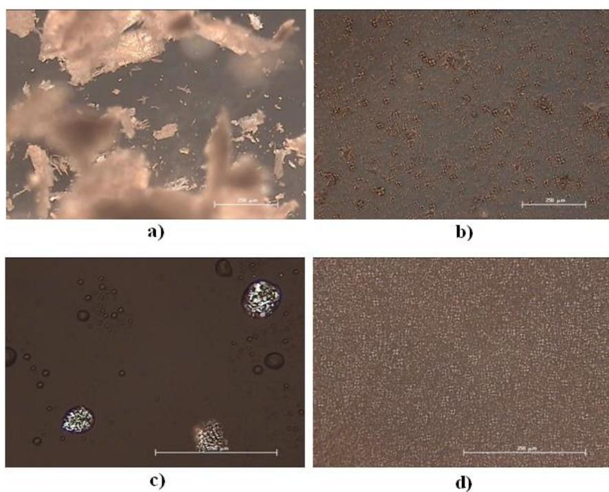
**Slika 73.** Mikrografije karakterističnih tekstura katanionske PAT DTA–Ch, snimljene optičkim mikroskopom uz polarizirano svjetlo tijekom termičkog tretmana: **a)** RT; **b)** 400 K; **c)** u ciklusu hlađenja na 463 K; te **d)** 48 h nakon hlađenja na RT. Oznaka predstavlja veličinu objekta od 250  $\mu\text{m}$ .<sup>285</sup>
