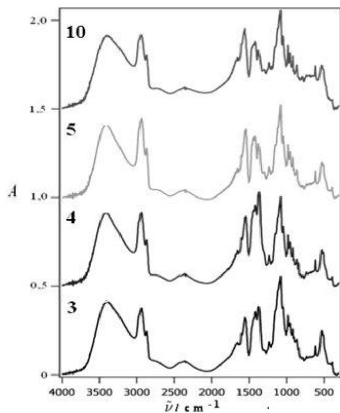
**Slika 119.** IR spektri La–Ch<sup>G</sup> sintetizirani pri raznim ekvimolnim koncentracijama komponenata La(NO<sub>3</sub>)<sub>3</sub> i NaCh (uzorci 3 – 5, tablica 30) i u suvišku NaCh (uzorak 10, tablica 30), u području valnih brojeva 450 – 4000 cm<sup>–1</sup>.
