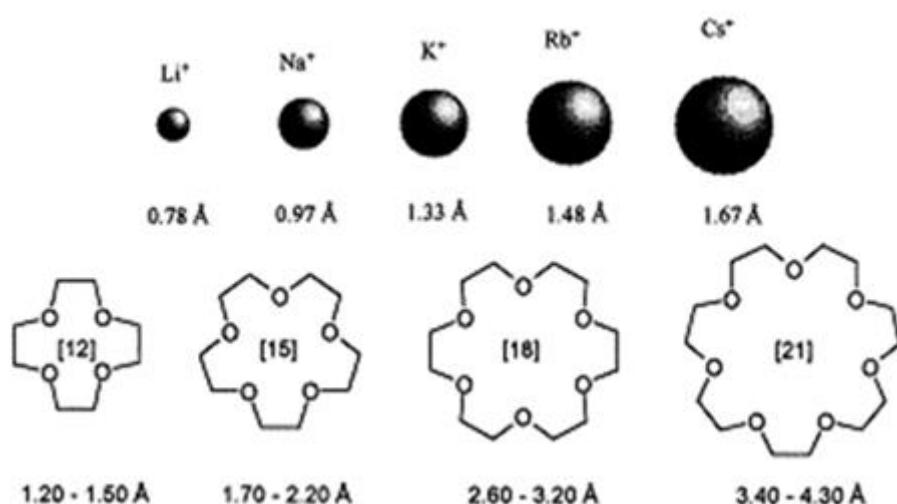
Slika 41. Usporedba ionskih radijusa alkalijskih metala sa veličinom šupljine krunastog etera.<sup>157</sup>
