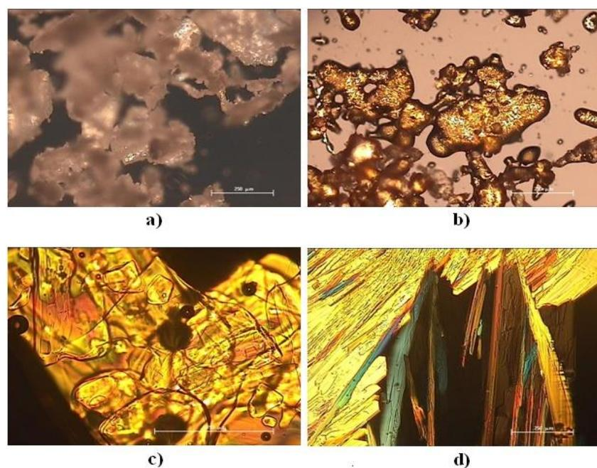
**Slika 97.** Mikrografije snimljene optičkim mikroskopom uz polarizirano svjetlo tijekom termičkog tretmana za uzorak DPy–Ch na: a) RT; b) 385 K; i uzorak DPy–P na: c) RT; i d) 24 h nakon hlađenja na RT. Oznaka predstavlja veličinu objekta od  $250 \mu\text{m}$ .<sup>214</sup>
