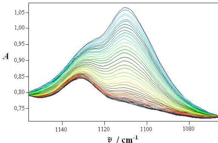
**Slika 145.** Temperaturno ovisni IR spektri ( $323 - 473\text{ K}$ )  $18\text{C}_6\text{-NaDBS}$  u regiji  $1160 - 1060\text{ cm}^{-1}$ .
