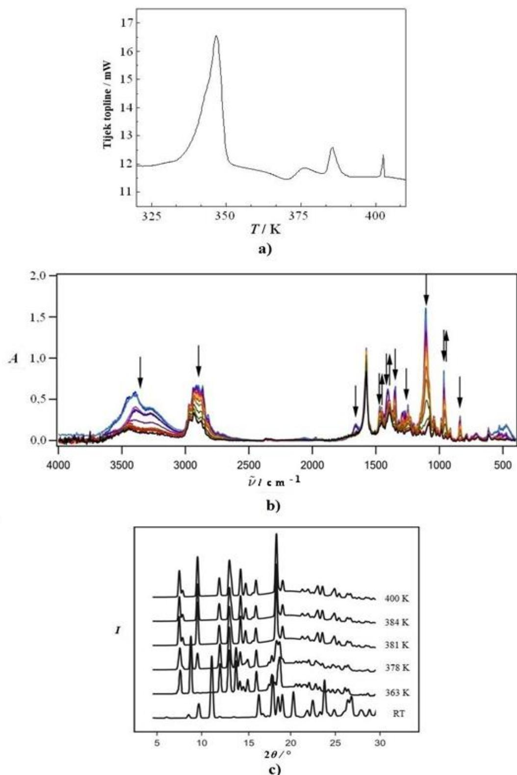
**Slika 125.** a) DSC krivulja adicijskog kompleksa 18C6-NaCh; b) IR spektri u temperaturnom području 323 – 473 K s istaknutim promjenama; c) difraktogrami u temperaturnom području 273 – 400 K, s vremenom izloženosti 10 min na pojedinoj temperaturi.<sup>328</sup>
