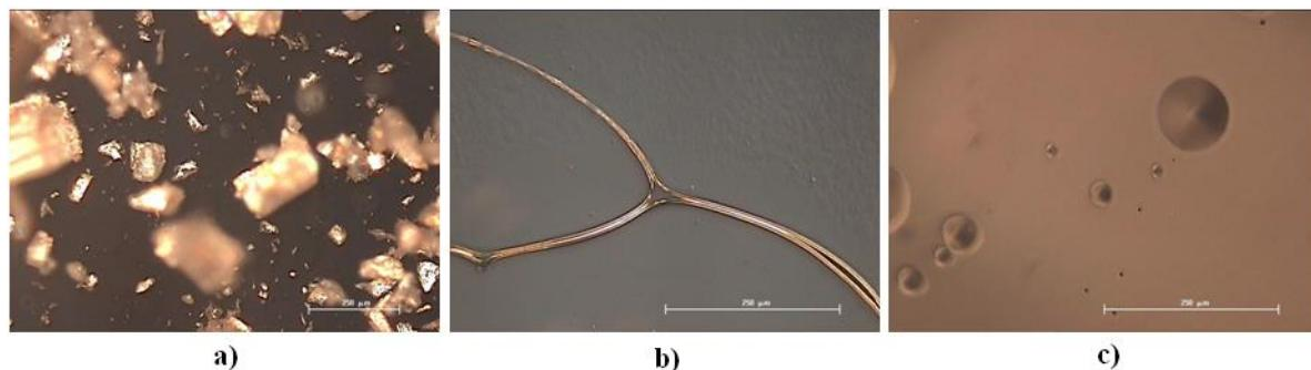
**Slika 87.** Mikrografije karakterističnih tekstura katanionske PAT Trimer–Ch, snimljene optičkim mikroskopom uz polarizirano svjetlo tijekom termičkog tretmana: **a)** RT; **b)** 415 K, i **c)** 48 h nakon hlađenja na RT. Oznaka predstavlja veličinu objekta od 250  $\mu\text{m}$ .<sup>285</sup>
