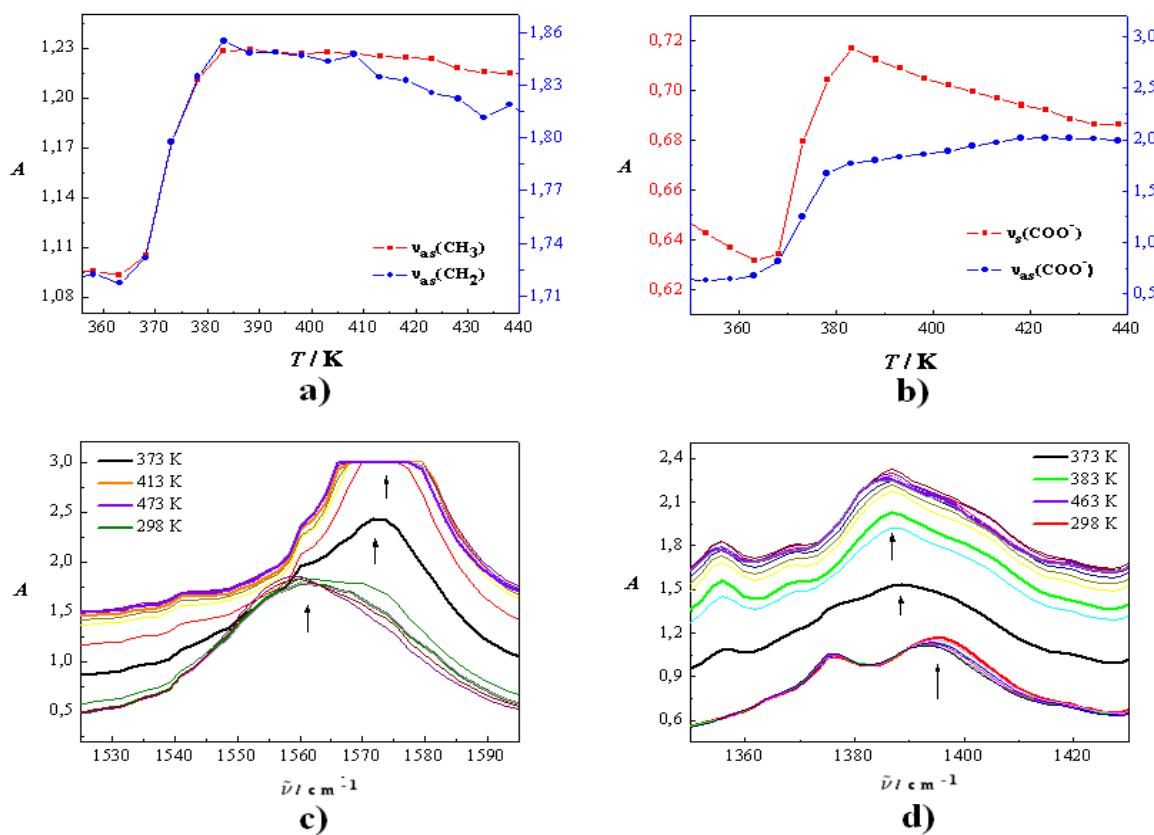
**Slika 91.** Karakteristične IR vrpce katanionskih PAT Trimer–Ch i Tetramer–Ch: **a**) temperaturna ovisnost vrpci  $\nu_{as}(CH_3)$  (crveno) i  $\nu_{as}(CH_2)$  (plavo); **b**) promjene intenziteta vrpci  $\nu_{as}(COO^-)$  (plavo) i  $\nu_s(COO^-)$  (crveno) s temperaturom. Promjene pozicija vrpci s temperaturom: **c**)  $\nu_{as}(COO^-)$  i **d**)  $\nu_s(COO^-)$ .<sup>285</sup>
