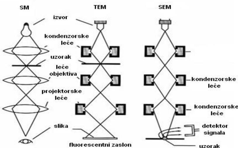
**Slika 63.** Podjela mikroskopa: SM - svjetlosni mikroskop, TEM - transmisijski elektronski mikroskop, SEM - skenirajući elektronski mikroskop. Umjesto izvora svjetlosti, u elektronskom mikroskopu postoji izvor elektrona, a umjesto staklenih leća za sabiranje ili rasipanje zraka elektrona koriste se tzv. elektronske leće.
