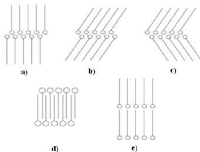
**Slika 48.** Prikaz pakiranja PAT unutar slojevitih struktura: pakiranje amfifilnih jedinica **a)**, **b)** i **c)** u tipu "glava-glava" s **a)** ispruženim, ili **b)** i **c)** ukošenim lancima; ili **d)** i **e)** pakiranje tipa "glava-rep", pri čemu se lanci mogu **d)** uklopiti, ili biti pod nekim kutom, ili se molekule organiziraju u **e)** monosloj.<sup>17</sup>
