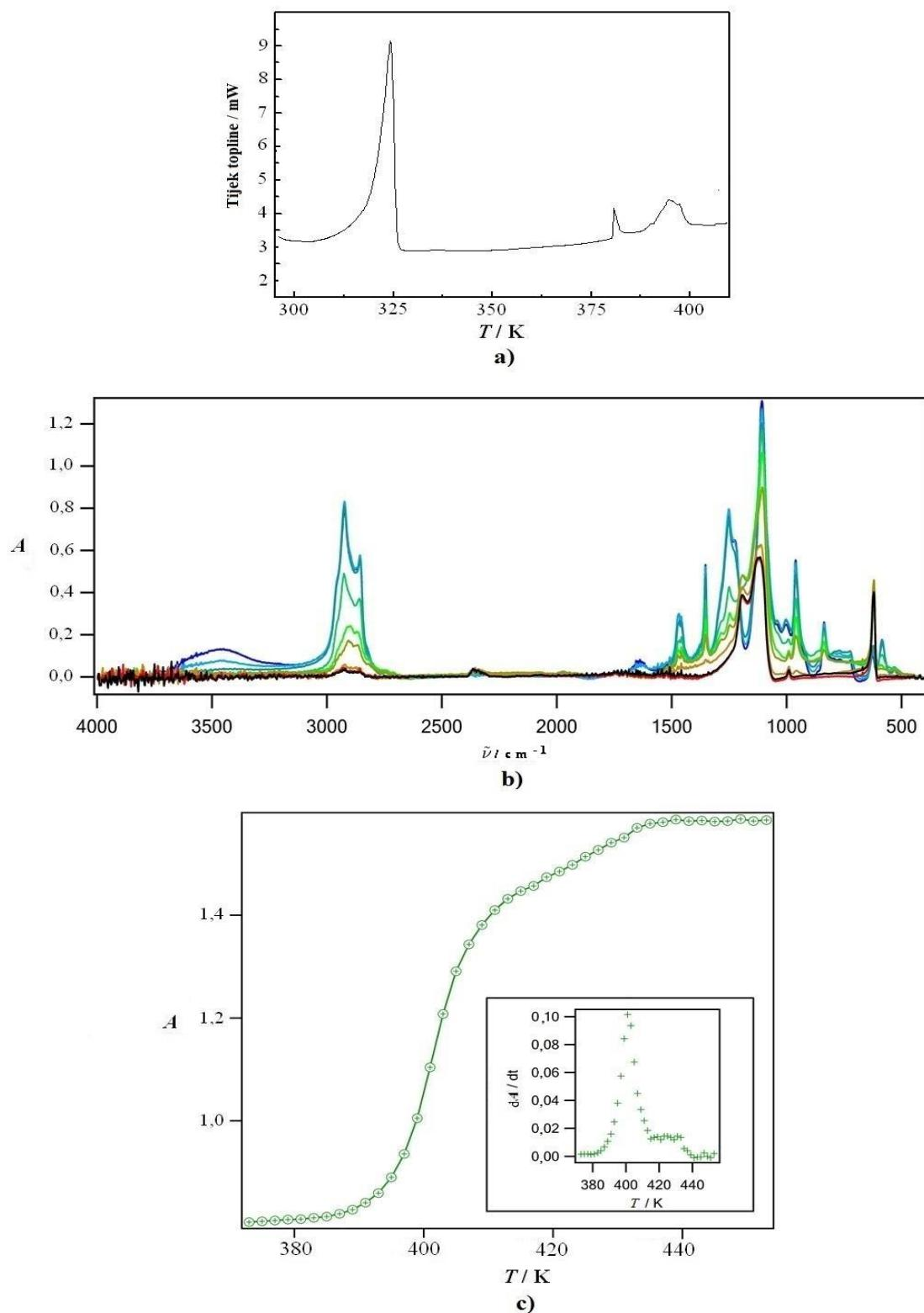
**Slika 137.** a) DSC krivulja za adicijski kompleks 18C6-NaDS; b) odgovarajući IR spektri u temperaturnom području 323 – 473 K. c) Temperaturna ovisnost apsorbancije bazne linije (prije korekcije) na  $2500 \text{ cm}^{-1}$  za kompleks 18C6-NaDS. Umetak prikazuje prvu derivaciju apsorbancije bazne linije za određivanje temperatura faznih prijelaza.<sup>295</sup>
