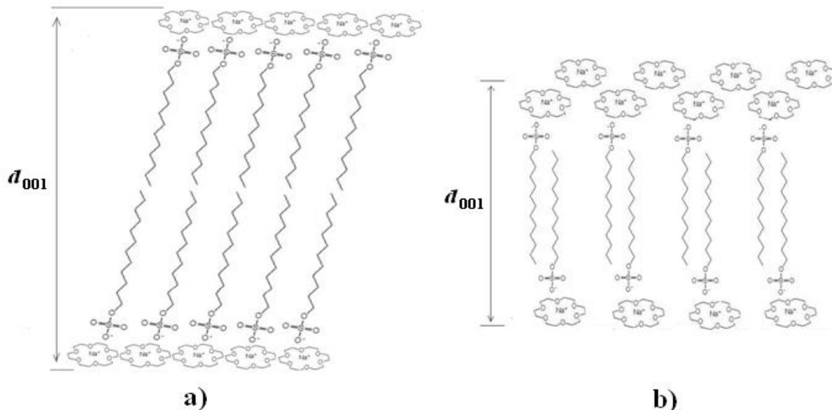
**Slika 136.** Prikaz mogućih pakiranja kompleksa 18C6-NaDS na RT, prema izračunima s ustanovljenom debljinom dvosloja od  $d_{001} = 3,89$  nm s: **a)** ukošenim molekulama; **b)** uklopljenim dodecilnim lancima.
