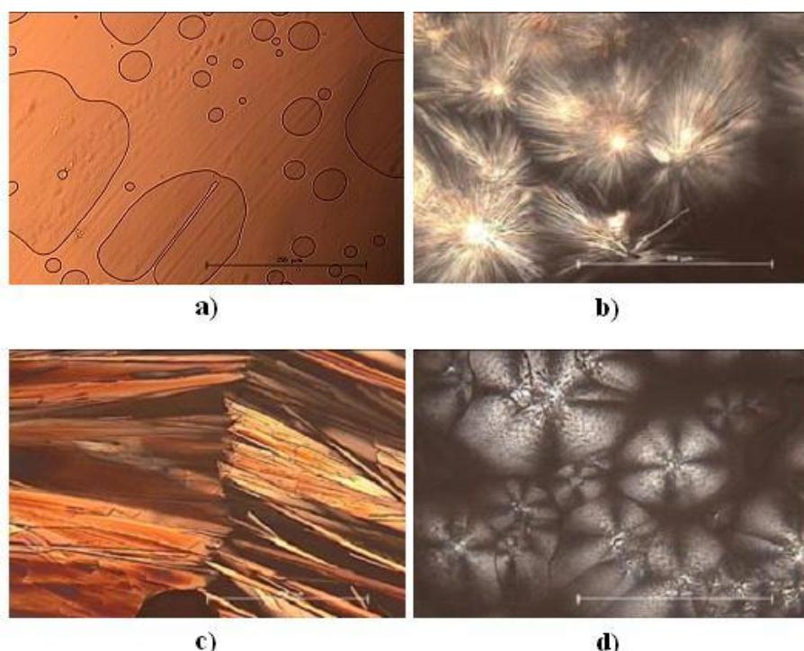
**Slika 124.** Mikrografije karakterističnih tekstura kompleksa 18C6-NaCh, snimljenih optičkim mikroskopom tijekom termičkog tretmana, uz fazni kontrast (a) i polarizirano svjetlo (b – d): **a)** RT; **b)** 355 K; **c)** 386 K; **d)** 400 K. Oznaka predstavlja veličinu objekta od 250  $\mu\text{m}$  (a i c) i 100  $\mu\text{m}$  (b i d).<sup>328</sup>
