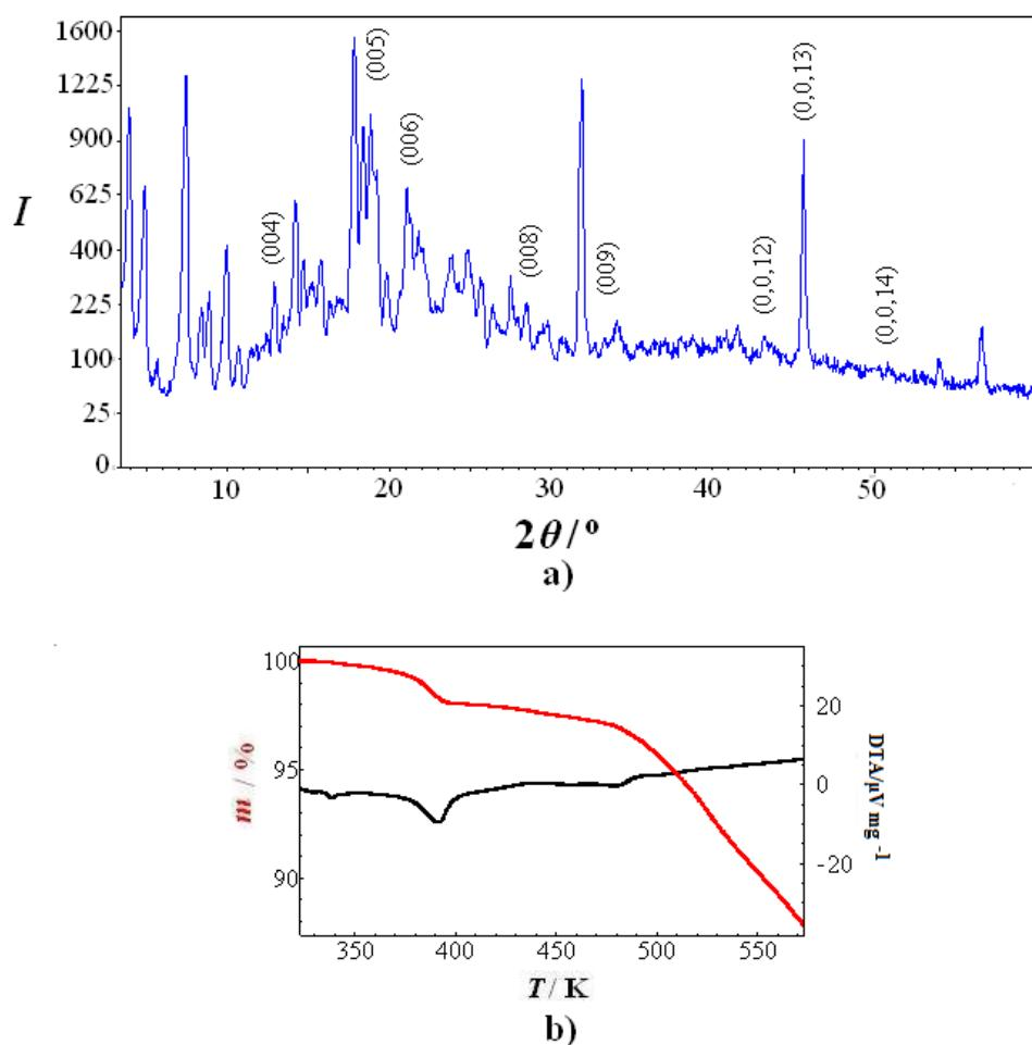
**Slika 96.** a) Difraktogram snimljen na sobnoj temperaturi<sup>214</sup> i b) termogram (crvena krivulja) i rezultat DTA analize (crna krivulja) za katanionski spoj DPy–Ch.
