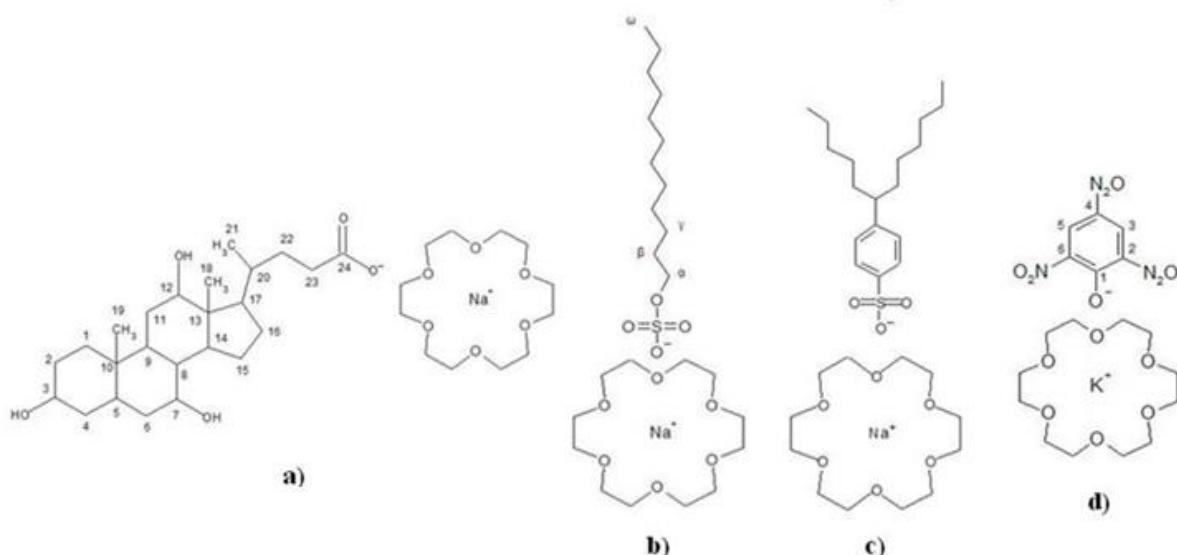
**Shema 6.** Prikaz sintetiziranih adicijskih kompleksa s odgovarajućim numeracijama C-atoma za NMR spektroskopiju: **a)** 18C6 – natrijev kolat (18C6NaCh); **b)** 18C6 – natrijev *n*-dodecilsulfat (18C6NaDS); **c)** 18C6 – natrijev 4-(1-pentilheptil)benzensulfonat (18C6NaDBS); **d)** 18C6 – kalijev pikrat (18C6-KP).
