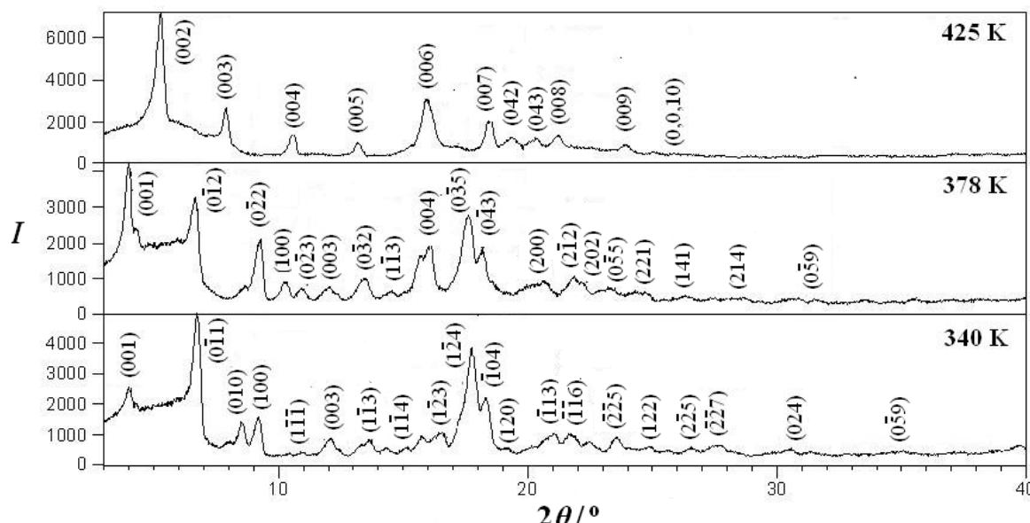
**Slika 76.** Indeksirani difraktogrami praha uzorka DTA–Ch tijekom termičkog tretmana, s označenim temperaturama.
