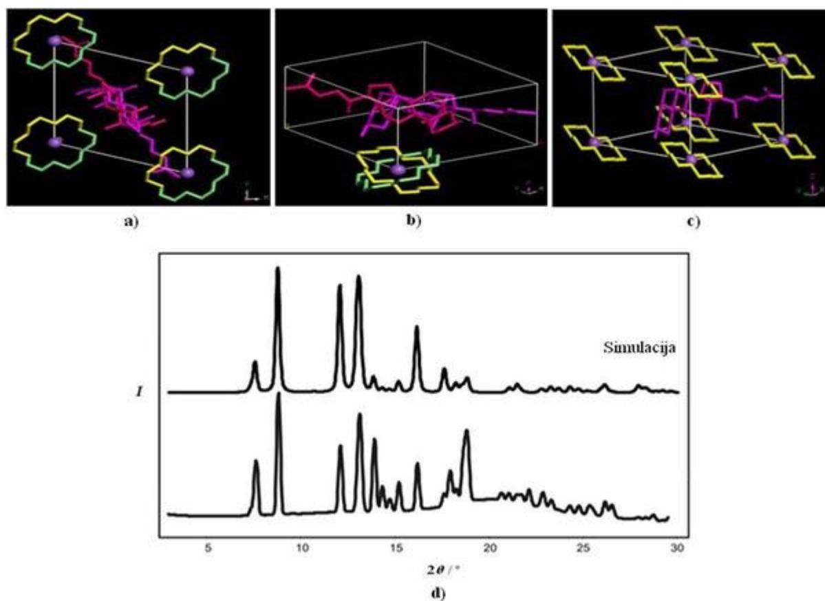
**Slika 130.** Molekulski model faze 18C6·NaCl na 363 K: **a)** projekcija duž  $c$ -osi; **b)** i **c)** bočni prikazi s i bez osi simetrije drugog reda. Molekule 18C6 obojene su u žuto i zeleno, a NaCl ružičasto i ljubičasto. Atomi vodika su izostavljeni zbog jasnijeg prikaza. **d)** Eksperimentalni i simulirani difraktogram faze 18C6·NaCl na 363 K.<sup>328</sup>
