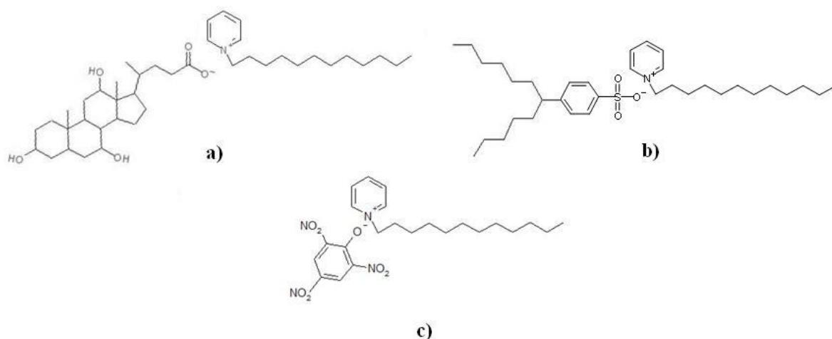
**Shema 5.** Prikaz sintetiziranih spojeva baziranih na dodecyliridinijevom kationu: **a)** dodecyliridinijev kolat (DPy–Ch); **b)** dodecyliridinijev 4-(1-pentilheptil)benzensulfonat (DPy–DBS); **c)** dodecyliridinijev pikrat, (DPy–P).
