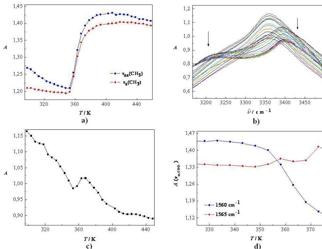
**Slika 75.** Karakteristične IR vrpce katanionske PAT DTA–Ch: **a)** temperaturna ovisnost vrpci  $\nu_{\text{as}}(\text{CH}_3)$  (plavo) i  $\nu_s(\text{CH}_3)$  (crveno); **b)** promjena pozicije maksimuma i dijeljenje vrpce  $\nu(\text{OH})$ ; **c)** temperaturna ovisnost  $\nu(\text{OH})$ ; **d)** temperaturno ponašanje vrpce  $\nu_{\text{as}}(\text{COO}^-)$ .<sup>285</sup>
