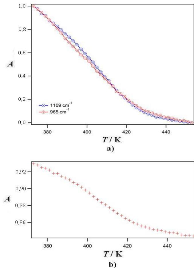
**Slika 144.** Temperaturna ovisnost karakterističnih IR vrpcia 18C6 etera za kompleks 18C6-NaDBS: a)  $1109 \text{ i } 965 \text{ cm}^{-1}$ , te c)  $1130 \text{ cm}^{-1}$ .<sup>295</sup>
