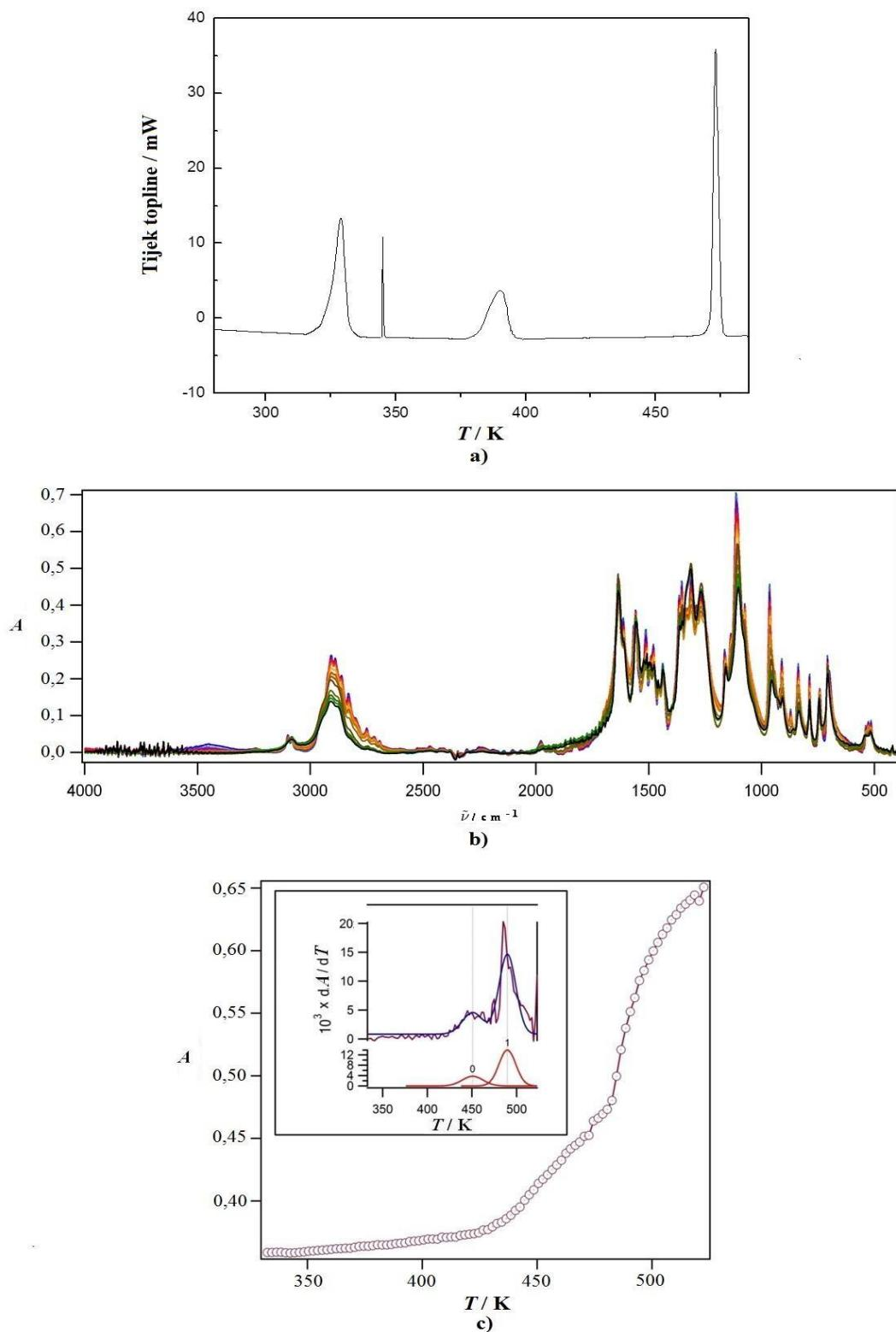
**Slika 148.** a) DSC krivulja za adicijski kompleks 18C6-KP; b) odgovarajući IR spektri u temperaturnom području 333 – 523 K. c) Temperaturna ovisnost apsorbancije bazne linije (prije korekcije) na  $2500 \text{ cm}^{-1}$  za kompleks 18C6-KP. Umetak prikazuje prvu derivaciju apsorbancije na  $2830 \text{ cm}^{-1}$  za određivanje temperature faznih prijelaza i usklađivanje s Lorentzovim funkcijama.<sup>295</sup>
