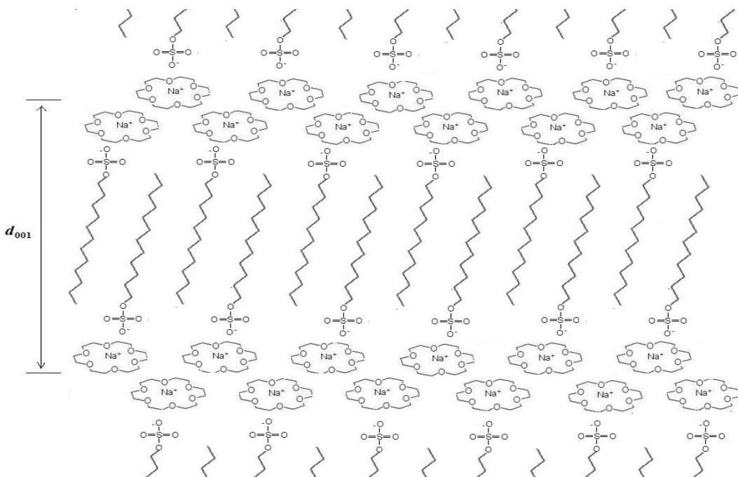
**Slika 139.** Prikaz moguće strukture SmC kompleksa 18C6-NaDS prema izračunima s ustanovljenom debljinom dvosloja od  $d_{001} = 3,08 \text{ nm}$ .
