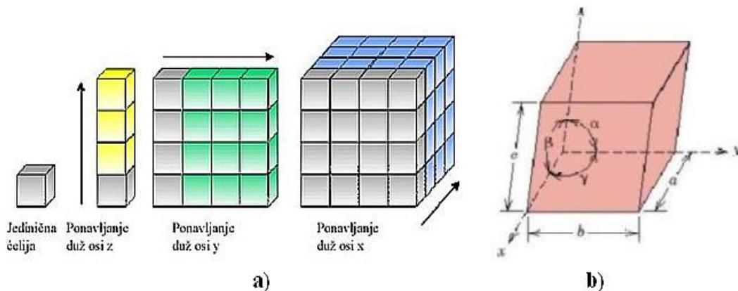
**Slika 47. a)** Kristalna rešetka, prikazana kao rezultat periodičkog ponavljanja jediničnih celija duž osi  $x$ ,  $y$  i  $z$ . **b)** Jedinična celija definirana je određenom vrijednosti stranica  $a$ ,  $b$  i  $c$ , kutova  $\alpha$ ,  $\beta$  i  $\gamma$ , te smjerom kristalografskih osi  $x$ ,  $y$  i  $z$ .
