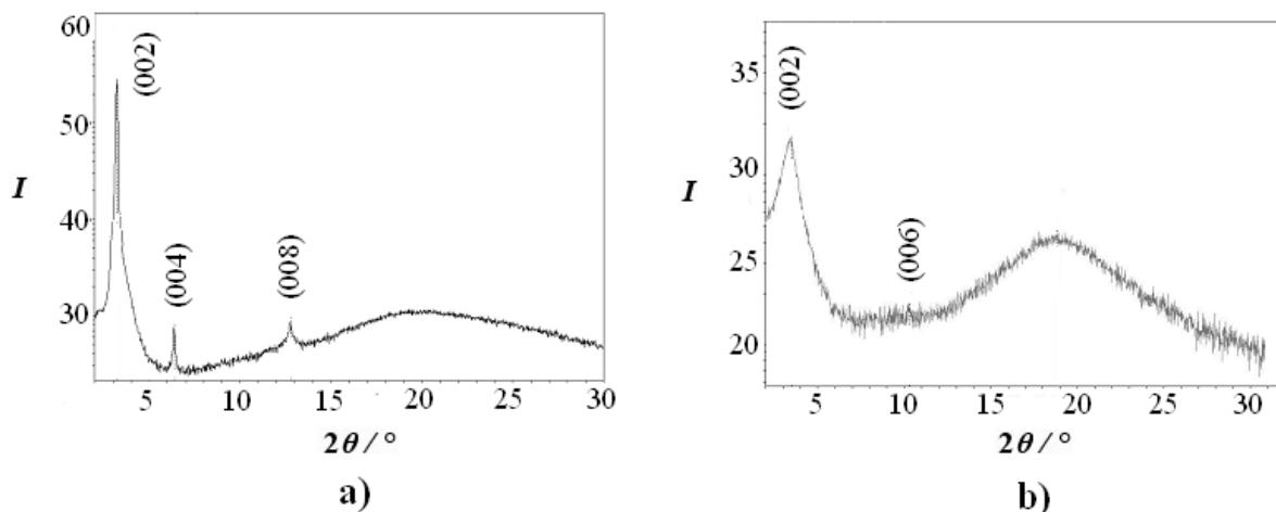
**Slika 101.** Difraktogrami DPy–DBS dobiveni metodom WAXD na: **a)** 300 K; **b)** 383 K.<sup>214</sup>
