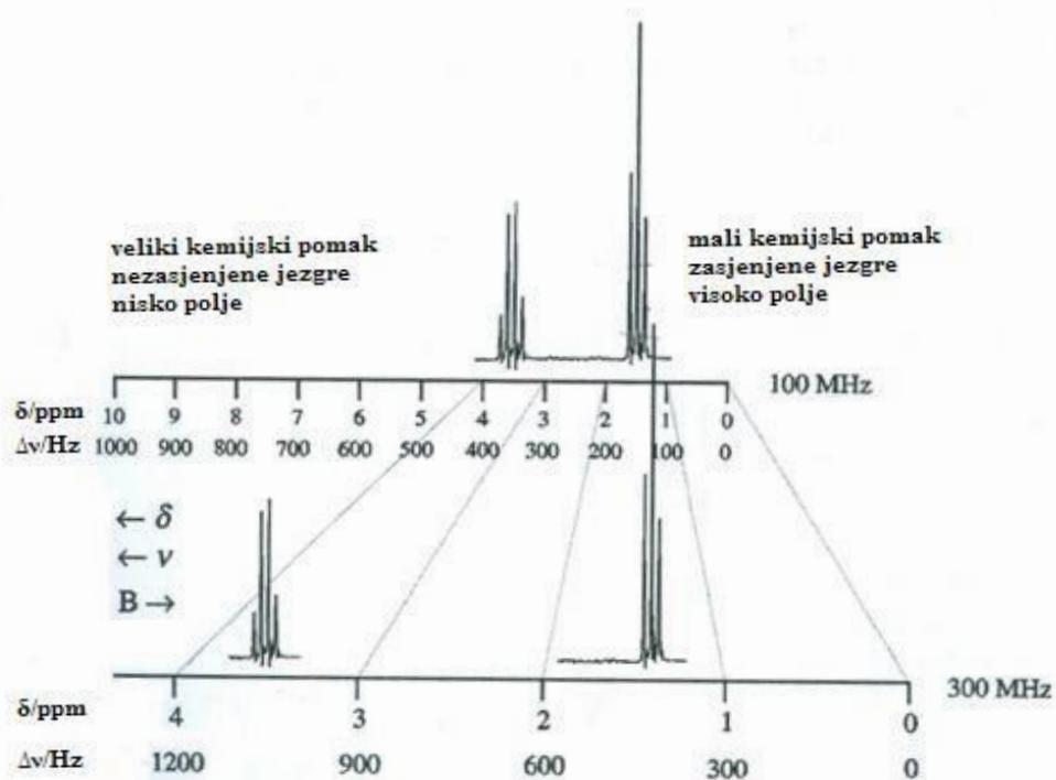
**Slika 60.** Spektri NMR se prikazuju tako da magnetska indukcija raste s lijeva na desno, a razlika frekvencija pa tako i kemijski pomak rastu s desna na lijevo. Zasjenjene jezgre pokazuju apsorpciju pri visokom polju, a nezasjenjene jezgre pri niskom.<sup>259</sup>
