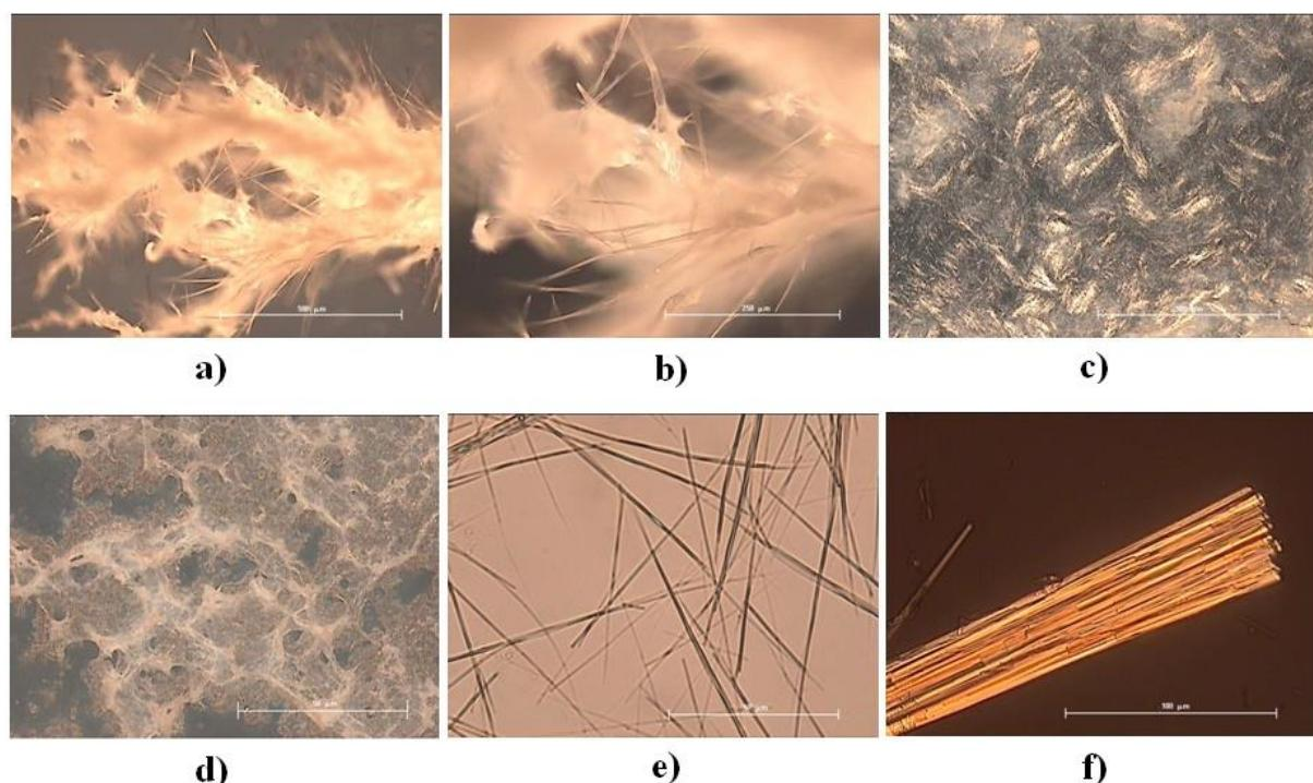
**Slika 106.** Mikrografije tekstura metaloamfifila snimljene optičkim mikroskopom uz polarizirano svjetlo (a – d) i fazni kontrast (e, f): a) i b) kserogel Ca–Ch<sup>G</sup>; gel La–Ch<sup>G</sup> c) prije i d) nakon zagrijavanja na 373 K; igličaste tvorevine e) Ag–Ch<sup>N</sup> i f) Ca–Ch<sup>N</sup>. Oznaka predstavlja veličinu objekta od 500 µm (a, c), 250 µm (b), 100 µm (f) i 50 µm (e, d).
