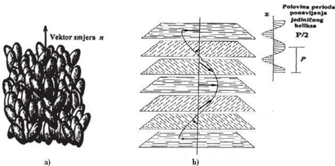
**Slika 53. a)** Nematička faza sa označenim vektorom smjera  $n$ ;<sup>204</sup> te **b)** prikaz helikoidne strukture kiralne nematičke faze. Os uzduž koje dolazi do periodičkog ponavljanja zavojite strukture označena je kao os  $z$ .<sup>206</sup>
