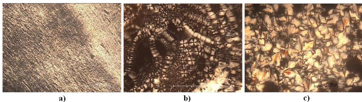
**Slika 100.** Mikrografije karakterističnih tekstura katanionske PAT DPy–DBS, snimljene optičkim mikroskopom uz polarizirano svjetlo tijekom termičkog tretmana: **a)** 300 K; **b)** 390 K; i u hlađenju: **c)** 300 K. Oznaka predstavlja veličinu objekta od 250  $\mu\text{m}$  (**a**) i 100  $\mu\text{m}$  (**b, c**).
