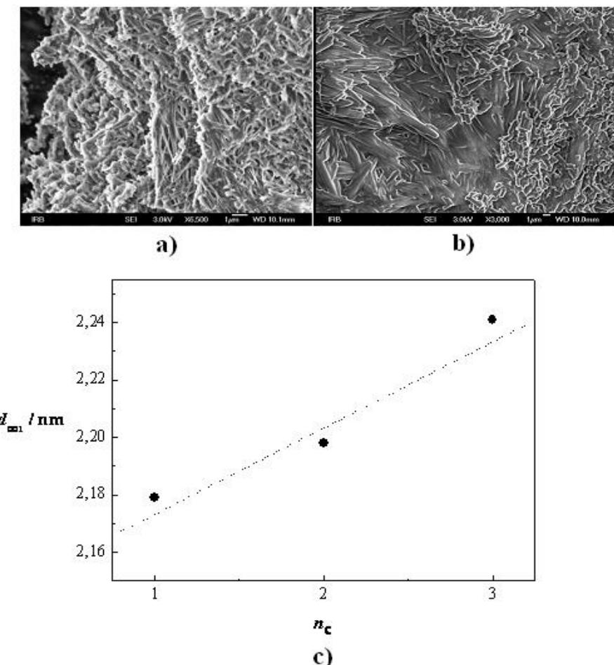
**Slika 70.** SEM mikrografije uzoraka a) DTA–Ch i b) TDMA–Ch, s povećanjima označenim na mikrografijama; te c) ovisnost debljina dvoslojeva dobivenih kao vrijednosti međumrežnih udaljenosti  $d_{001}$ , o broju dodecilnih lanaca,  $n_c$ .
