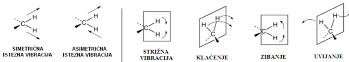
**Slika 61.** Načini vibriranja molekula; istezne vibracije prilikom kojih se mijenja duljina veza (lijevo), vibracije prilikom kojih dolazi do promjene kuta (desno).<sup>261</sup>
