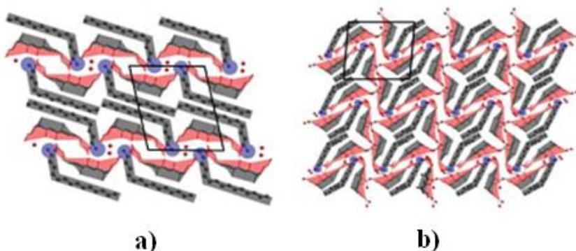
**Slika 69.** Usporedba dvoslojnog pakiranja molekula alkilamonijevih kolata: **a)** strukture tipa "sendviča"; **b)** "ukršteni" tip strukture.<sup>5</sup>
