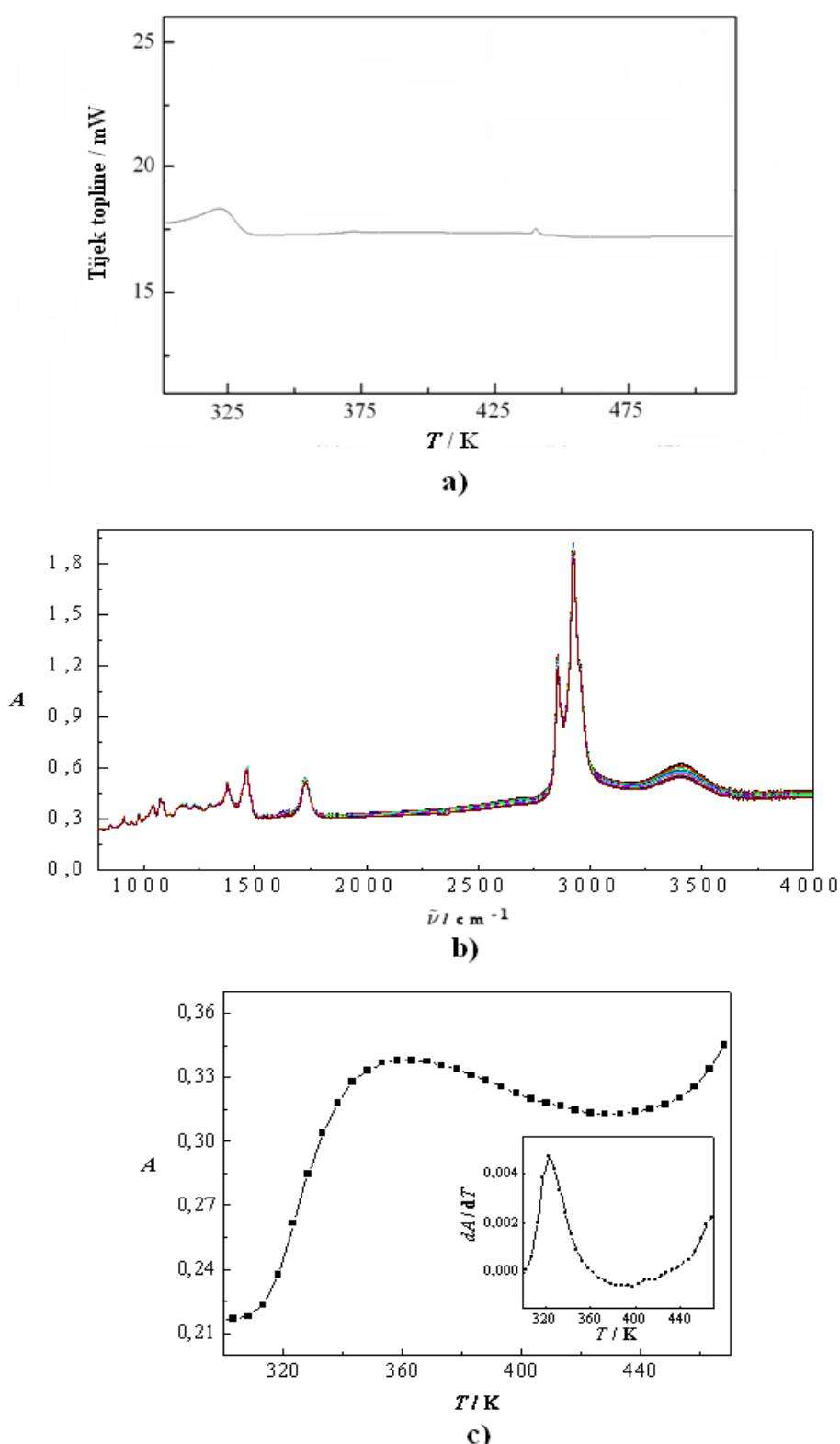
**Slika 82. a)** DSC krivulja; **b)** IR spektri u temperaturnom području 298 – 468 K; **c)** temperaturna ovisnost apsorbancije bazne linije (prije korekcije) na  $2000 \text{ cm}^{-1}$  katanionske PAT TDMA–Ch. Umetak je prva derivacija apsorbancije bazne linije za određivanje temperatura faznih prijelaza.<sup>285</sup>
