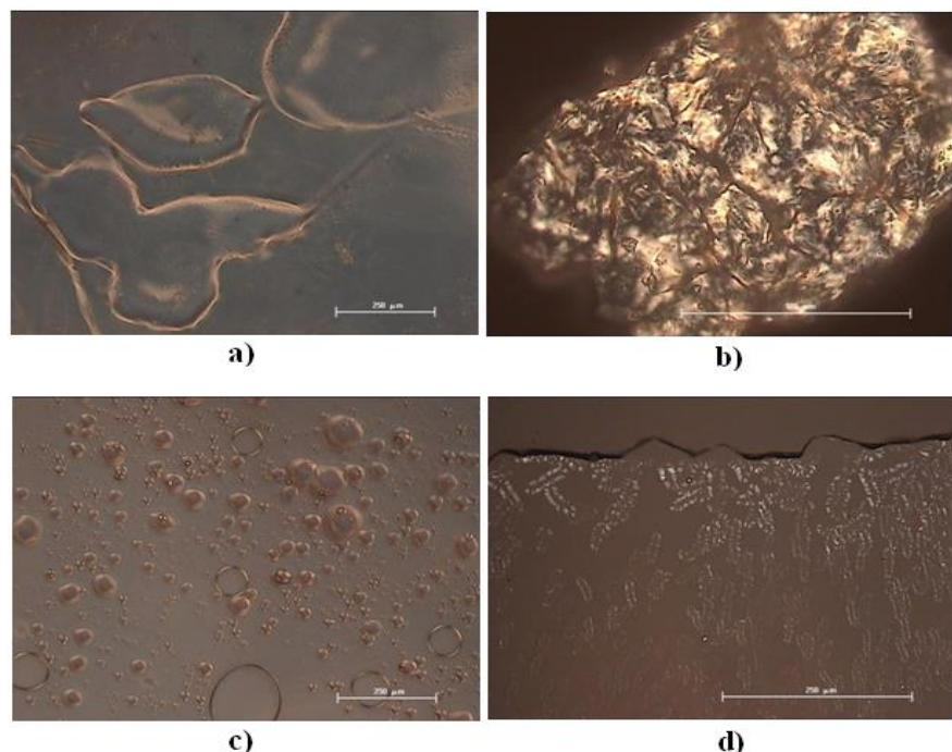
**Slika 89.** Mikrografije karakterističnih tekstura katanijske PAT Tetramer–Ch, snimljene optičkim mikroskopom uz fazni kontrast (**a, c**) i polarizirano svjetlo (**b i d**) tijekom termičkog tretmana: **a)** RT; **b)** 340 K; **c)** 404 K; **d)** 72 h nakon hlađenja na RT. Oznaka predstavlja veličinu objekta od 250  $\mu\text{m}$  (**a, c, d**) i 100  $\mu\text{m}$  (**b**).<sup>285</sup>
