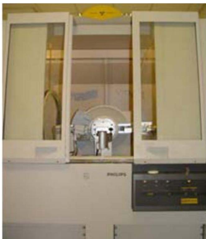
Slika 20. Rengenski difraktometar Philips PW3040/60 X'Pert Pro.
