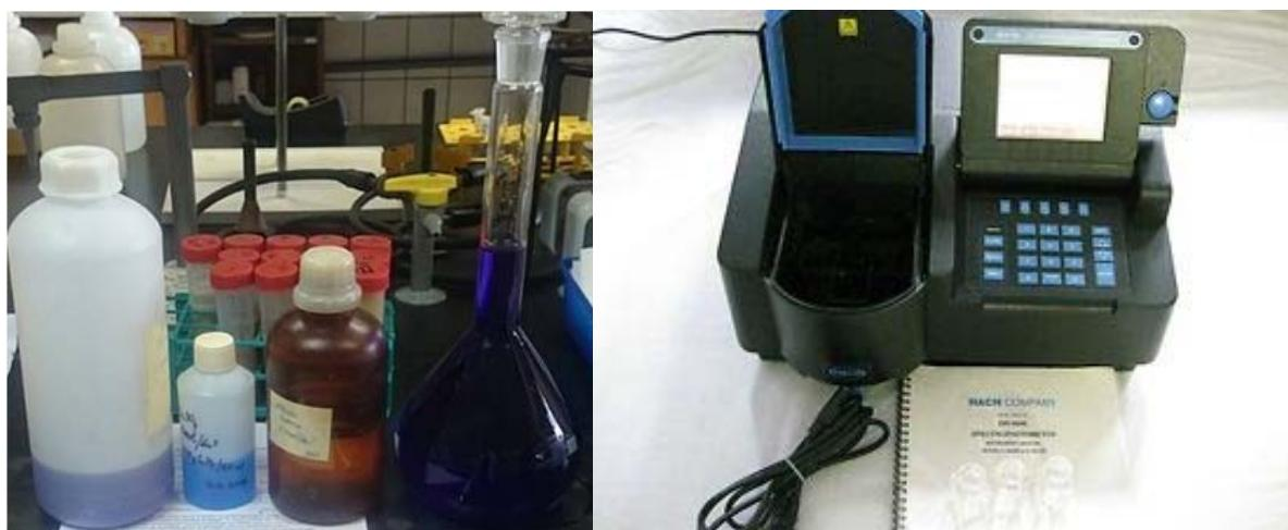
Slika 16. a) Pripremljeni standard za izradu kalibracijske krivulje za potrebe CEC mjerjenja b) Spektrofotometar HACH DR/4000.
