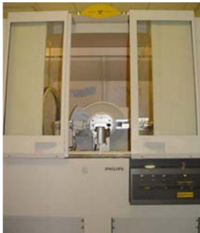
Slika 20. Rengenski difraktometar Philips PW3040/60 X'Pert Pro. Mineraloško-petrografski zavod.
