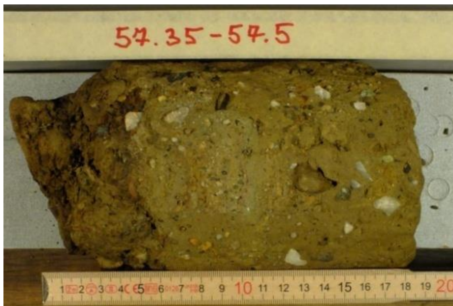
Slika 14. Dio jezgre s dubine 57,35-57,5 m. Dijamikt s nesortiranim klastima u glinovitom matriksu.
