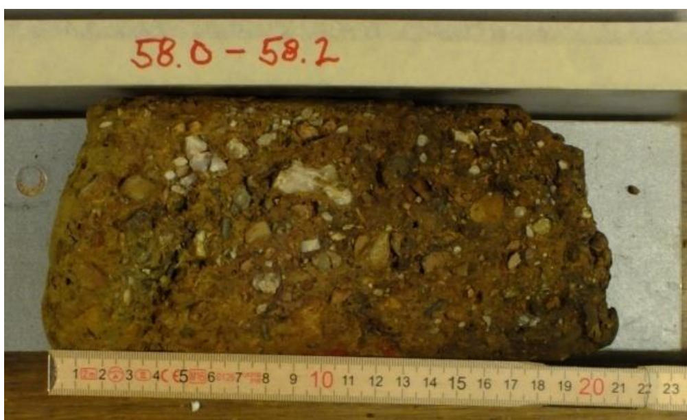
Slika 15. Dio jezgre s dubine 58,0-58,2 m. Dijamikt s nesortiranim klastima i limonitiziranim matriksom.
