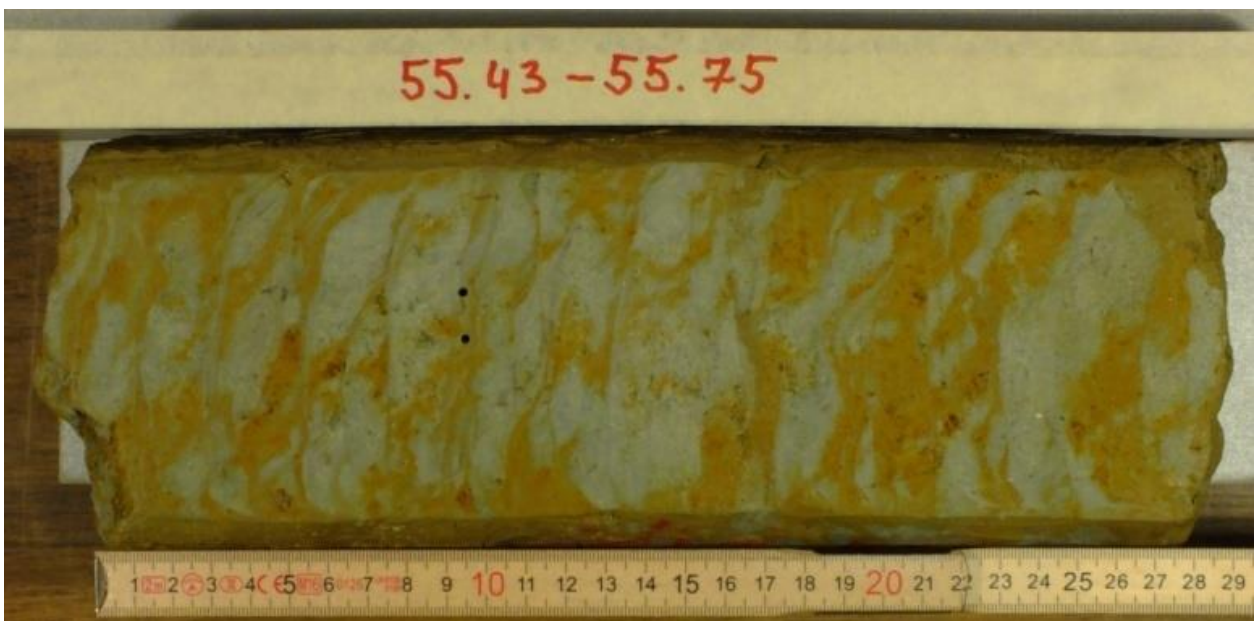
Slika 13. Dio jezgre s dubine 55,43–55,75 m s krioturbacijom poremećeni sediment svijetlo zelene gline i smeđeg silta.
