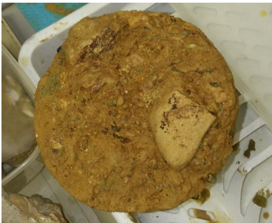
Slika 5. Slomljeni klast u glinovito-siltnom matriksu.
