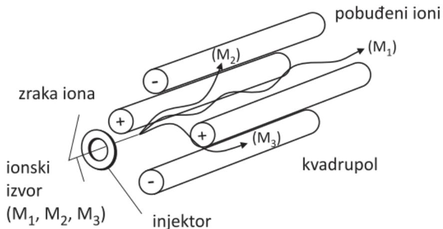
Slika 5. Shema kvadrupolnog analizatora masa.<sup>24</sup>
