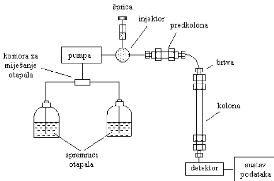
Slika 3. Shematski prikaz tekućinskog kromatografa.<sup>20</sup>
