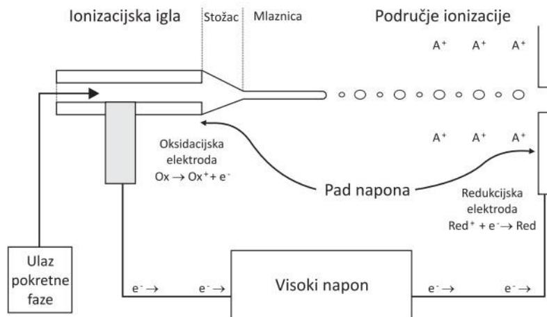
Slika 4. Shematski prikaz procesa prijenosa naboja u tehnici elektroraspršenja.<sup>24</sup>
