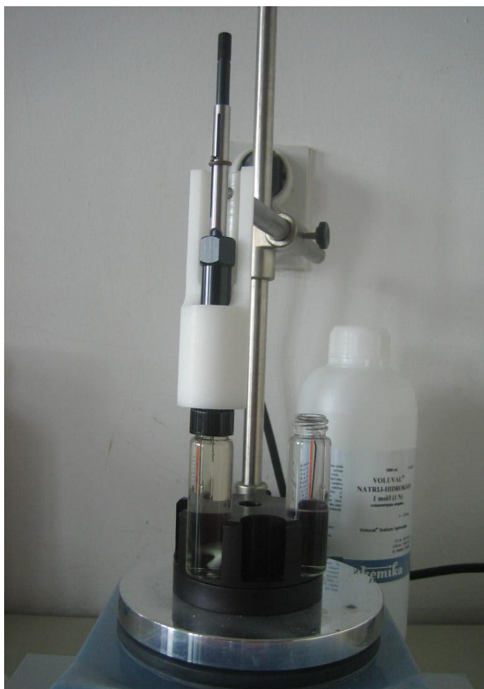
Slika 3.3. Prikaz tehnike DI-SPME
