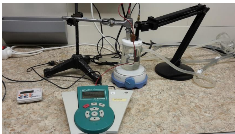
Slika 3.2.4.1. Aparatura za potenciometrijsku titraciju: titracijska ćelija, pH metar (Metrohm), referentna (Metrohm) i ion-selektivna (FKIT) elektroda.
