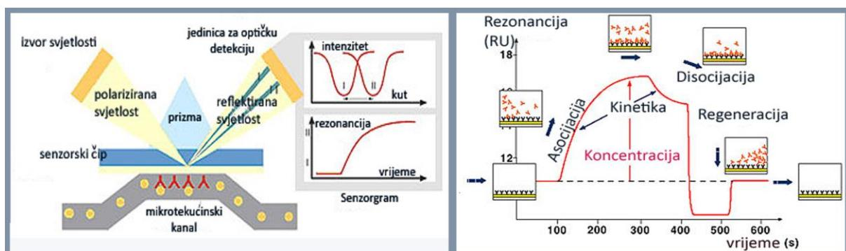
Slika 3-3. Shema rada instrumenta (lijevo; objašnjeno u tekstu). Shematski prikaz generirane krivulje s ilustracijom pojedinih mjernih koraka tijekom oblikovanja kompleksa (makro)molekula.
