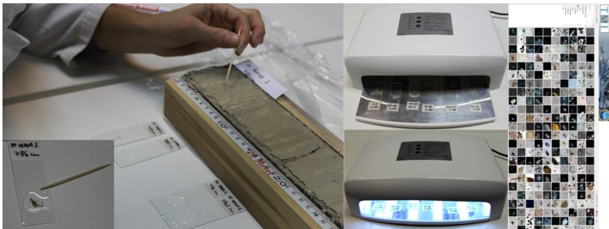
Slika 49 Izrada „smear slide“ preparata za mikroskopsku analizu nekonsolidiranih uzoraka, pomoću UV lampe i interpretacija podataka uz pomoć TMI baze.
